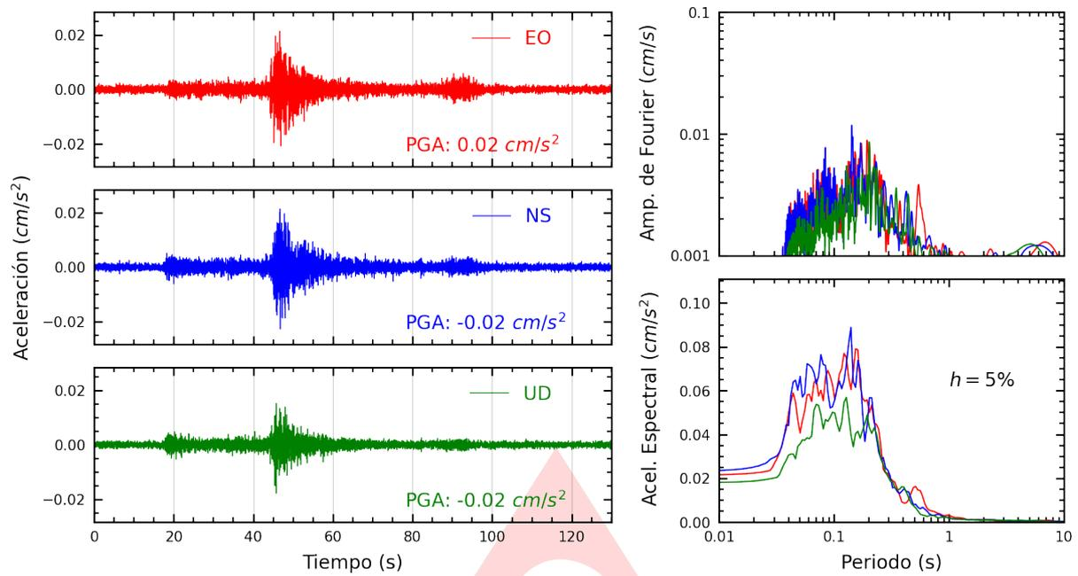
**Figura A.1:** Registros tiempo-historia, espectros de Fourier y de respuesta en las direcciones EO, NS y vertical de la estación UNSA2. Sismo de Tarata, Tarata - Tacna del 2024-10-15, 11:56:41 (Hora local)
