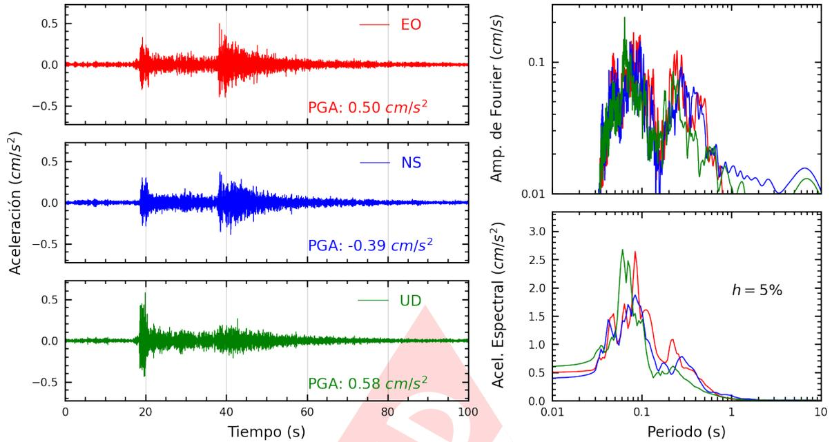
**Figura A.3:** Registros tiempo-historia, espectros de Fourier y de respuesta en las direcciones EO, NS y vertical de la estación CREY. Sismo de Tarata, Tarata - Tacna del 2024-11-04, 10:03:51 (Hora local)
