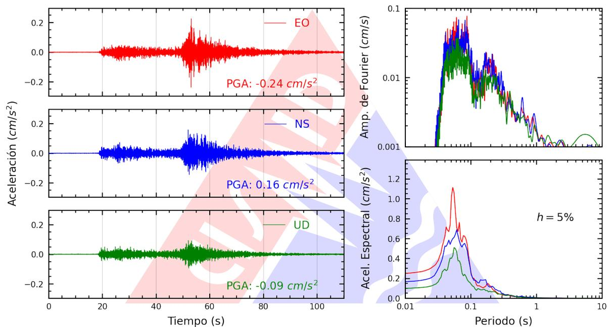
**Figura A.5:** Registros tiempo-historia, espectros de Fourier y de respuesta en las direcciones EO, NS y vertical de la estación UNSA2. Sismo de Tarata, Tarata - Tacna del 2024-11-04, 10:03:51 (Hora local)
