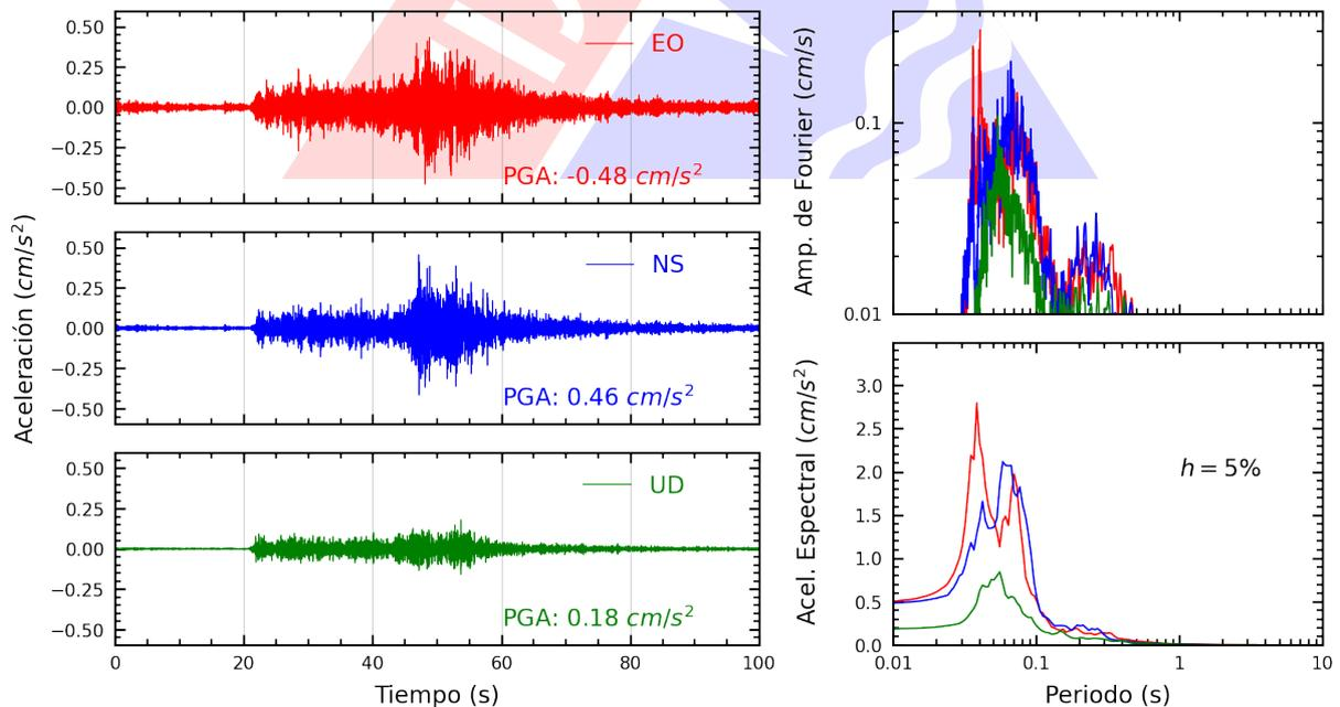
**Figura A.4:** Registros tiempo-historia, espectros de Fourier y de respuesta en las direcciones EO, NS y vertical de la estación UNAM. Sismo de Tarata, Tarata - Tacna del 2024-11-04, 10:03:51 (Hora local)
