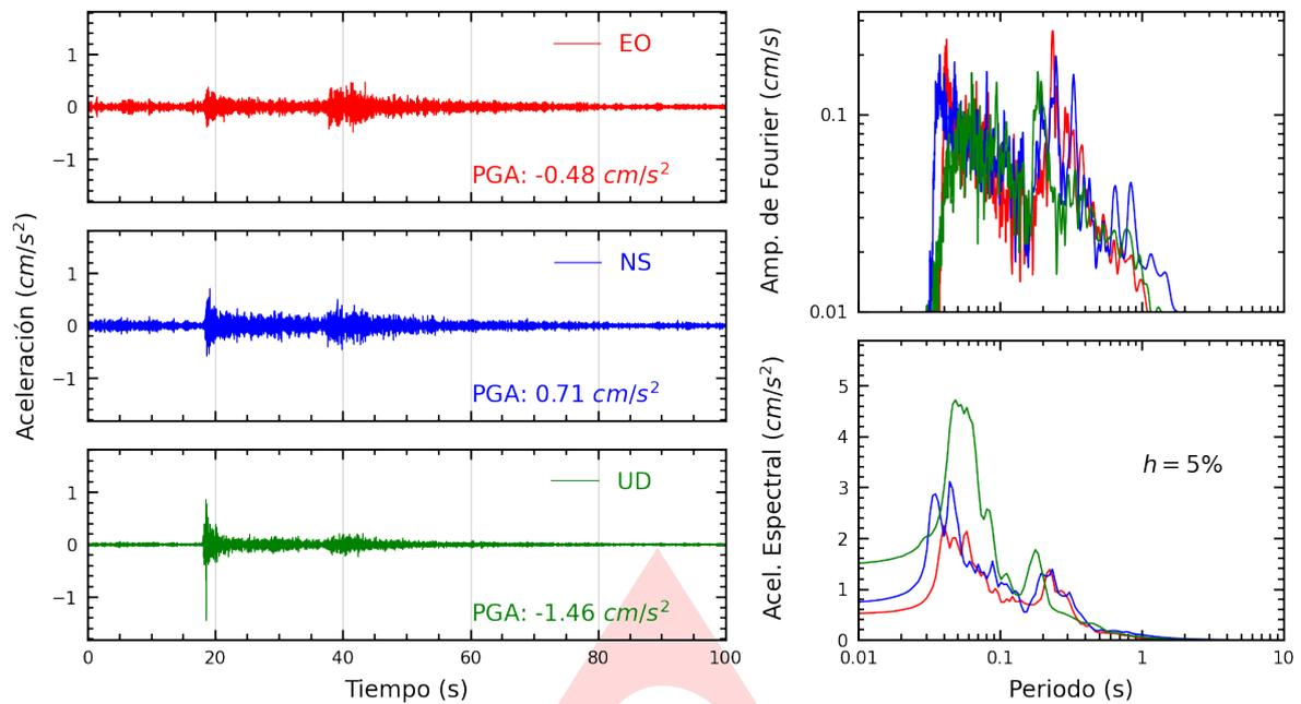
**Figura A.1:** Registros tiempo-historia, espectros de Fourier y de respuesta en las direcciones EO, NS y vertical de la estación UPTAC. Sismo de Tarata, Tarata - Tacna del 2024-11-04, 10:03:51 (Hora local)
