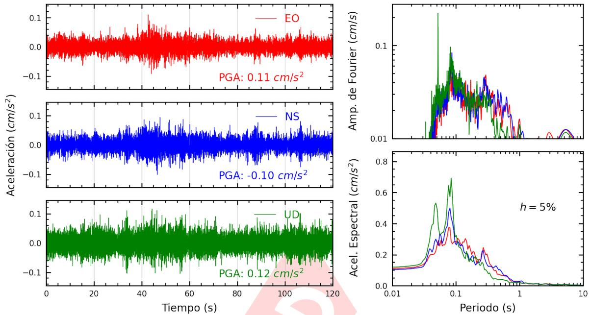
**Figura A.39:** Registros tiempo-historia, espectros de Fourier y de respuesta en las direcciones EO, NS y vertical de la estación UNICA. Sismo de Chilca, Cañete - Lima del 2024-11-06, 19:56:52 (Hora local)
