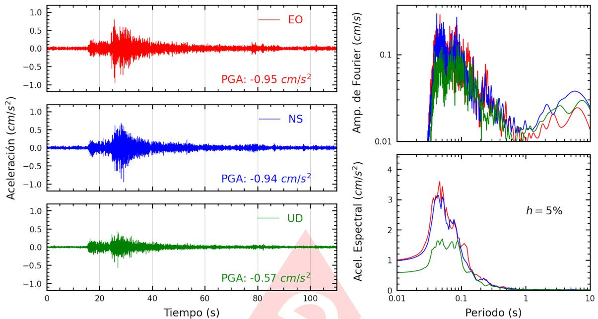
**Figura A.27:** Registros tiempo-historia, espectros de Fourier y de respuesta en las direcciones EO, NS y vertical de la estación CEPRE. Sismo de Chilca, Cañete - Lima del 2024-11-06, 19:56:52 (Hora local)
