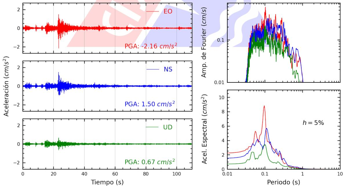
**Figura A.8:** Registros tiempo-historia, espectros de Fourier y de respuesta en las direcciones EO, NS y vertical de la estación BRIS2. Sismo de Chilca, Cañete - Lima del 2024-11-06, 19:56:52 (Hora local)
