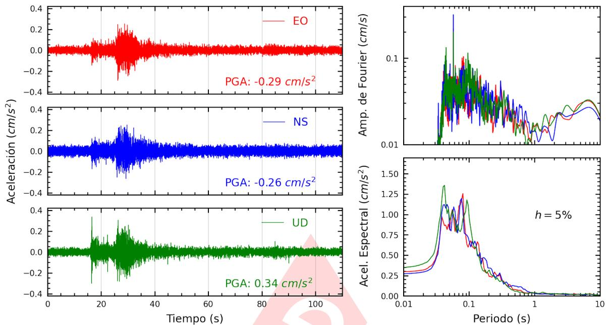
**Figura A.35:** Registros tiempo-historia, espectros de Fourier y de respuesta en las direcciones EO, NS y vertical de la estación BONDY. Sismo de Chilca, Cañete - Lima del 2024-11-06, 19:56:52 (Hora local)
