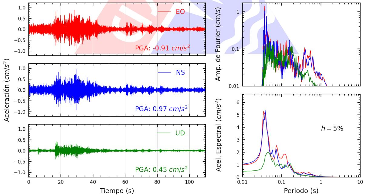
**Figura A.26:** Registros tiempo-historia, espectros de Fourier y de respuesta en las direcciones EO, NS y vertical de la estación DHN2. Sismo de Chilca, Cañete - Lima del 2024-11-06, 19:56:52 (Hora local)
