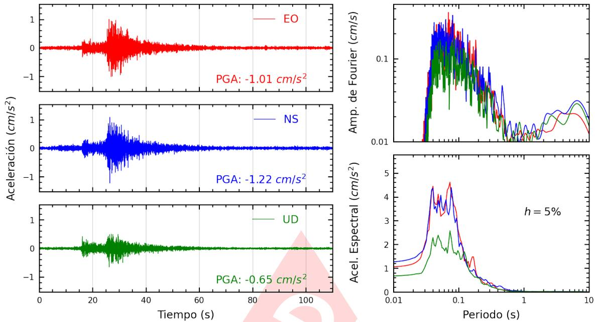
**Figura A.21:** Registros tiempo-historia, espectros de Fourier y de respuesta en las direcciones EO, NS y vertical de la estación FICPE. Sismo de Chilca, Cañete - Lima del 2024-11-06, 19:56:52 (Hora local)
