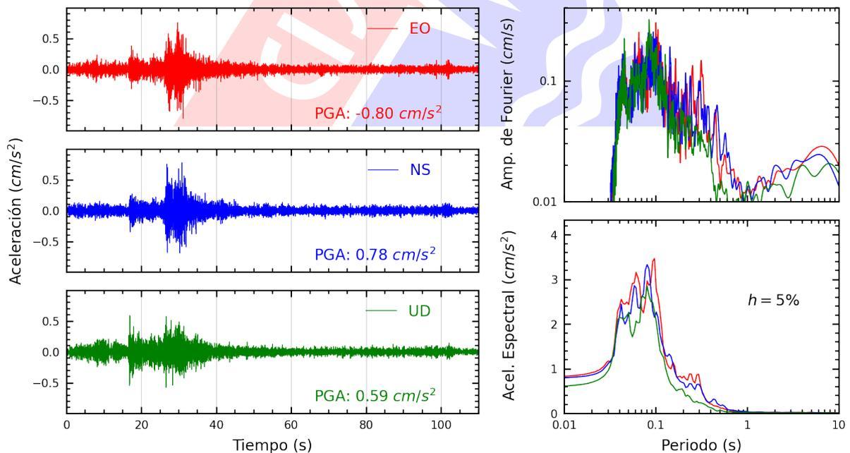
**Figura A.30:** Registros tiempo-historia, espectros de Fourier y de respuesta en las direcciones EO, NS y vertical de la estación MADRE. Sismo de Chilca, Cañete - Lima del 2024-11-06, 19:56:52 (Hora local)
