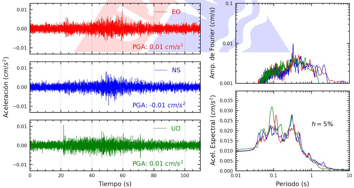
**Figura A.40:** Registros tiempo-historia, espectros de Fourier y de respuesta en las direcciones EO, NS y vertical de la estación UNCP. Sismo de Chilca, Cañete - Lima del 2024-11-06, 19:56:52 (Hora local)
