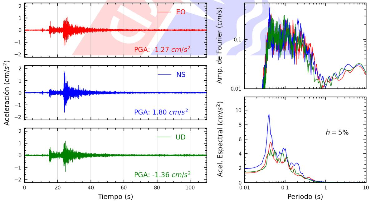
**Figura A.12:** Registros tiempo-historia, espectros de Fourier y de respuesta en las direcciones EO, NS y vertical de la estación USMP. Sismo de Chilca, Cañete - Lima del 2024-11-06, 19:56:52 (Hora local)
