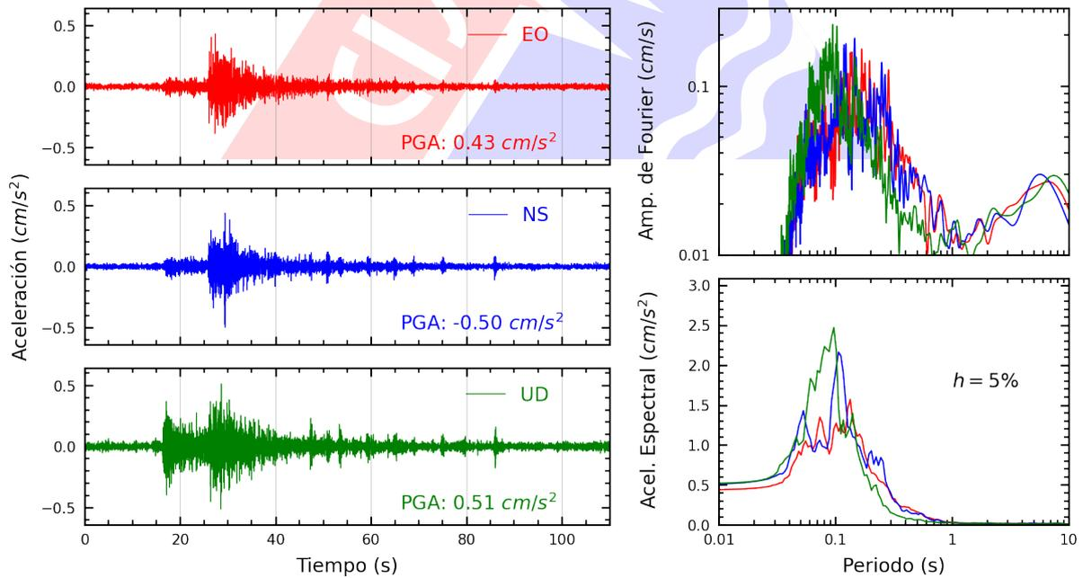
**Figura A.32:** Registros tiempo-historia, espectros de Fourier y de respuesta en las direcciones EO, NS y vertical de la estación RAMON. Sismo de Chilca, Cañete - Lima del 2024-11-06, 19:56:52 (Hora local)
