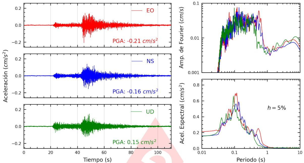
**Figura A.37:** Registros tiempo-historia, espectros de Fourier y de respuesta en las direcciones EO, NS y vertical de la estación CARAL. Sismo de Chilca, Cañete - Lima del 2024-11-06, 19:56:52 (Hora local)
