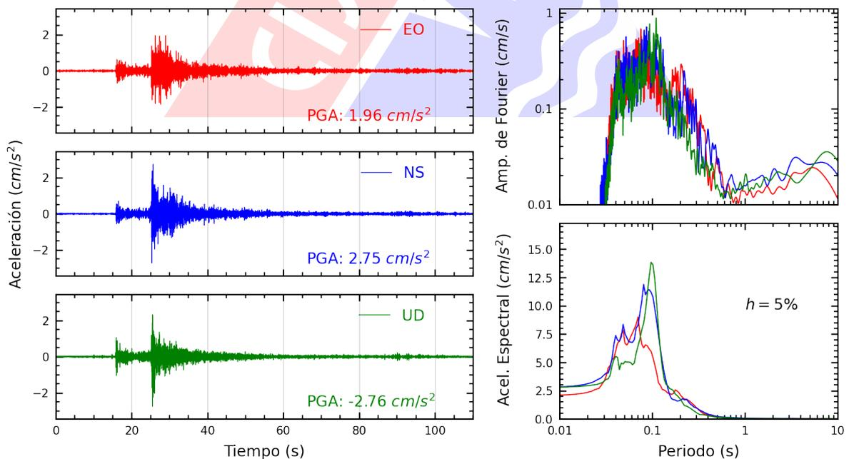
**Figura A.6:** Registros tiempo-historia, espectros de Fourier y de respuesta en las direcciones EO, NS y vertical de la estación INDEP. Sismo de Chilca, Cañete - Lima del 2024-11-06, 19:56:52 (Hora local)
