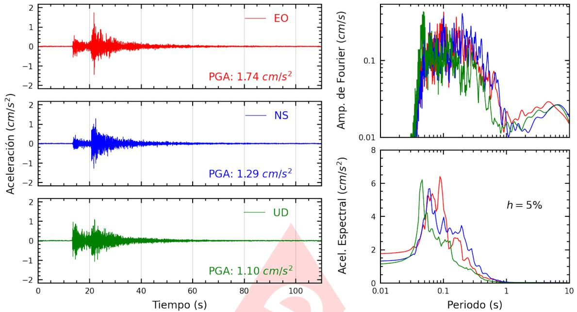
**Figura A.13:** Registros tiempo-historia, espectros de Fourier y de respuesta en las direcciones EO, NS y vertical de la estación USILP. Sismo de Chilca, Cañete - Lima del 2024-11-06, 19:56:52 (Hora local)
