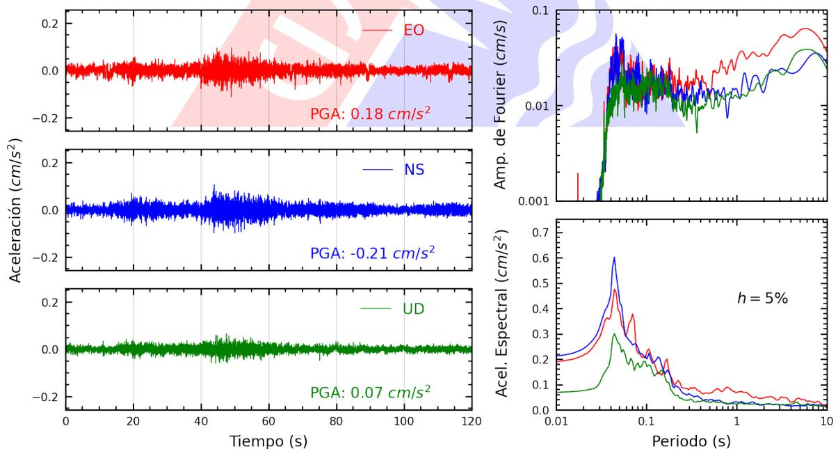
**Figura A.38:** Registros tiempo-historia, espectros de Fourier y de respuesta en las direcciones EO, NS y vertical de la estación UNAB. Sismo de Chilca, Cañete - Lima del 2024-11-06, 19:56:52 (Hora local)
