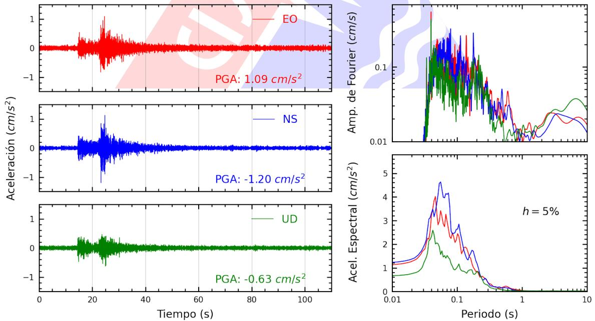
**Figura A.22:** Registros tiempo-historia, espectros de Fourier y de respuesta en las direcciones EO, NS y vertical de la estación UPCVI. Sismo de Chilca, Cañete - Lima del 2024-11-06, 19:56:52 (Hora local)
