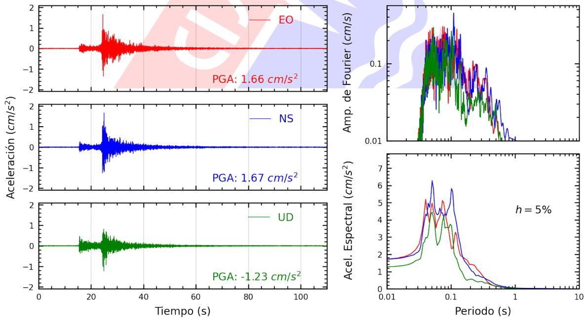
**Figura A.16:** Registros tiempo-historia, espectros de Fourier y de respuesta en las direcciones EO, NS y vertical de la estación ATARJ. Sismo de Chilca, Cañete - Lima del 2024-11-06, 19:56:52 (Hora local)
