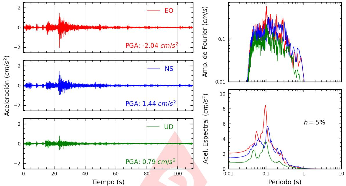
**Figura A.9:** Registros tiempo-historia, espectros de Fourier y de respuesta en las direcciones EO, NS y vertical de la estación BRISA. Sismo de Chilca, Cañete - Lima del 2024-11-06, 19:56:52 (Hora local)
