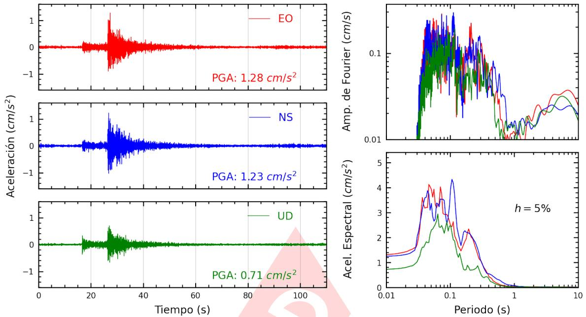
**Figura A.19:** Registros tiempo-historia, espectros de Fourier y de respuesta en las direcciones EO, NS y vertical de la estación COMAS. Sismo de Chilca, Cañete - Lima del 2024-11-06, 19:56:52 (Hora local)
