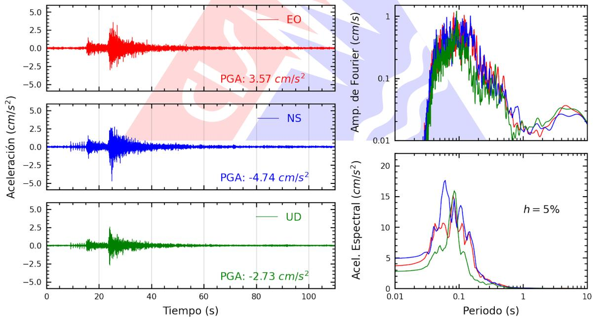
**Figura A.2:** Registros tiempo-historia, espectros de Fourier y de respuesta en las direcciones EO, NS y vertical de la estación USILM. Sismo de Chilca, Cañete - Lima del 2024-11-06, 19:56:52 (Hora local)
