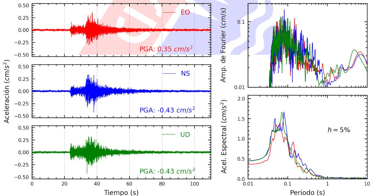
**Figura A.34:** Registros tiempo-historia, espectros de Fourier y de respuesta en las direcciones EO, NS y vertical de la estación UNMSM. Sismo de Chilca, Cañete - Lima del 2024-11-06, 19:56:52 (Hora local)
