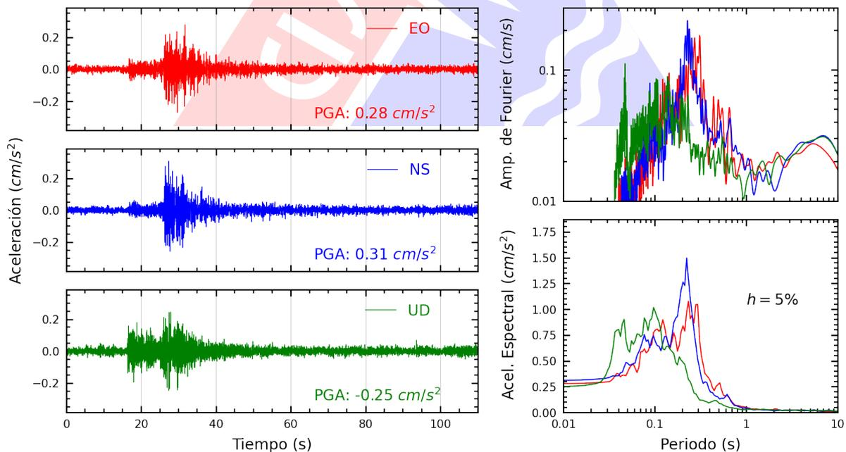
**Figura A.36:** Registros tiempo-historia, espectros de Fourier y de respuesta en las direcciones EO, NS y vertical de la estación DSMI. Sismo de Chilca, Cañete - Lima del 2024-11-06, 19:56:52 (Hora local)
