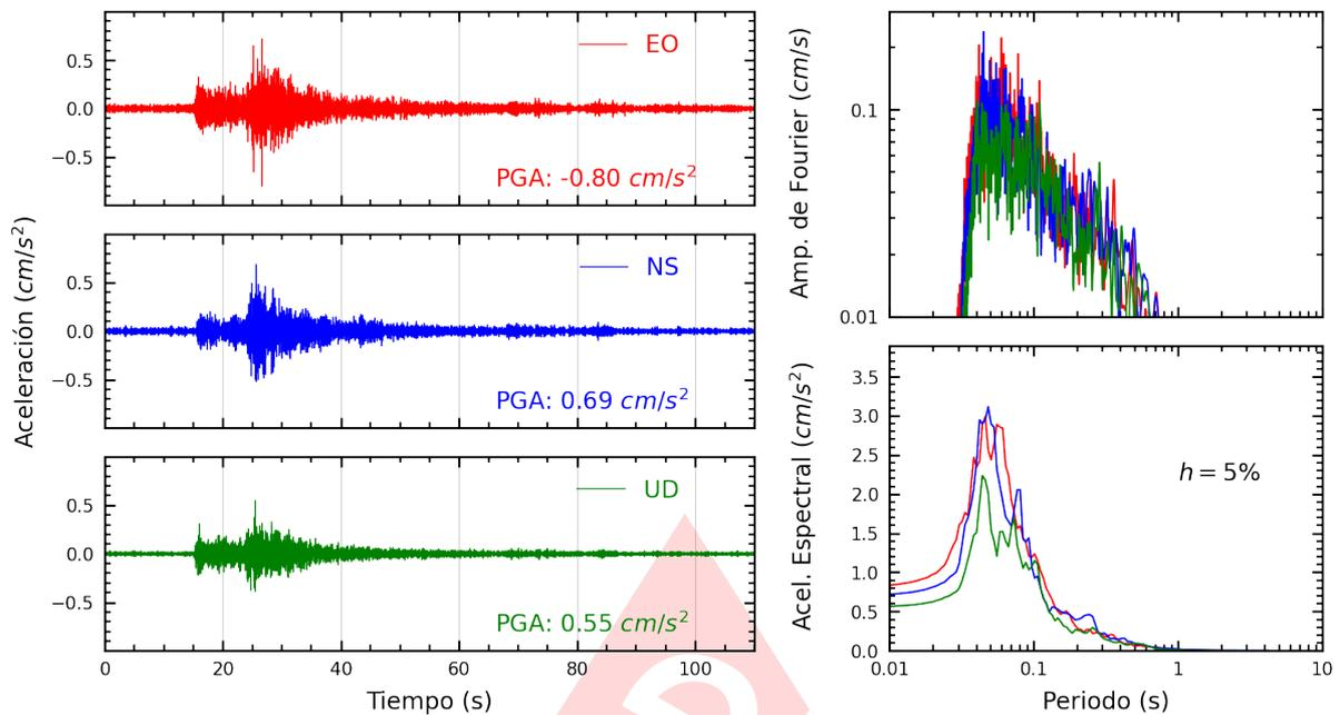
**Figura A.29:** Registros tiempo-historia, espectros de Fourier y de respuesta en las direcciones EO, NS y vertical de la estación BORJA. Sismo de Chilca, Cañete - Lima del 2024-11-06, 19:56:52 (Hora local)
