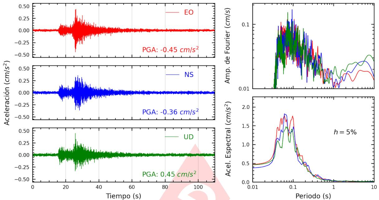
**Figura A.33:** Registros tiempo-historia, espectros de Fourier y de respuesta en las direcciones EO, NS y vertical de la estación UNFV. Sismo de Chilca, Cañete - Lima del 2024-11-06, 19:56:52 (Hora local)
