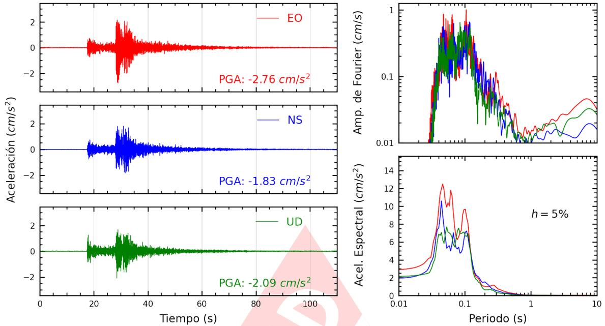
**Figura A.5:** Registros tiempo-historia, espectros de Fourier y de respuesta en las direcciones EO, NS y vertical de la estación AMORE. Sismo de Chilca, Cañete - Lima del 2024-11-06, 19:56:52 (Hora local)
