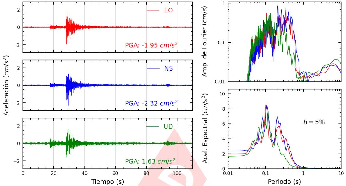
**Figura A.7:** Registros tiempo-historia, espectros de Fourier y de respuesta en las direcciones EO, NS y vertical de la estación MDPP. Sismo de Chilca, Cañete - Lima del 2024-11-06, 19:56:52 (Hora local)
