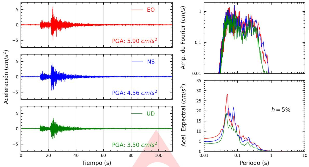
**Figura A.1:** Registros tiempo-historia, espectros de Fourier y de respuesta en las direcciones EO, NS y vertical de la estación UNTEL. Sismo de Chilca, Cañete - Lima del 2024-11-06, 19:56:52 (Hora local)
