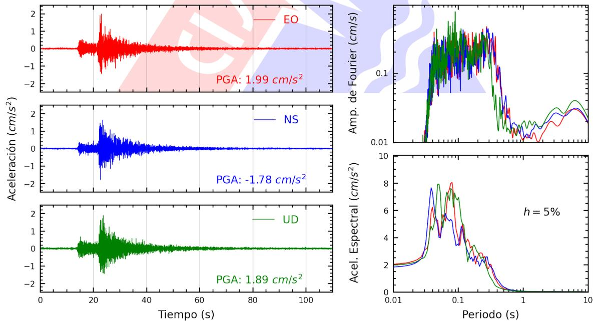
**Figura A.10:** Registros tiempo-historia, espectros de Fourier y de respuesta en las direcciones EO, NS y vertical de la estación SOVES. Sismo de Chilca, Cañete - Lima del 2024-11-06, 19:56:52 (Hora local)
