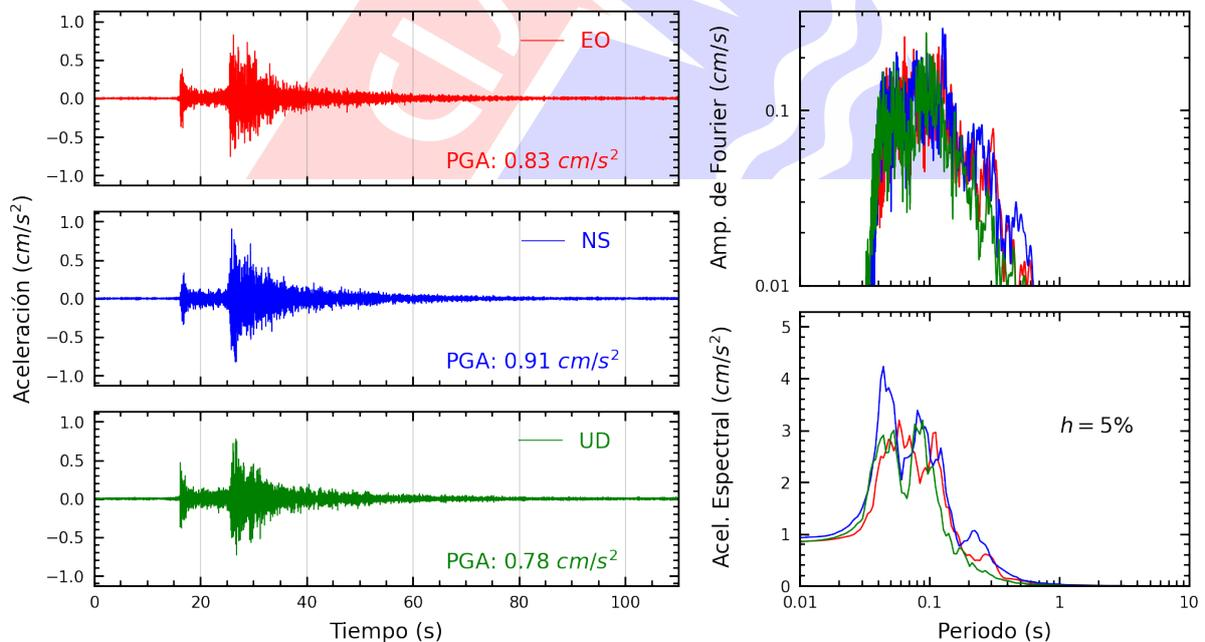
**Figura A.28:** Registros tiempo-historia, espectros de Fourier y de respuesta en las direcciones EO, NS y vertical de la estación JALV2. Sismo de Chilca, Cañete - Lima del 2024-11-06, 19:56:52 (Hora local)
