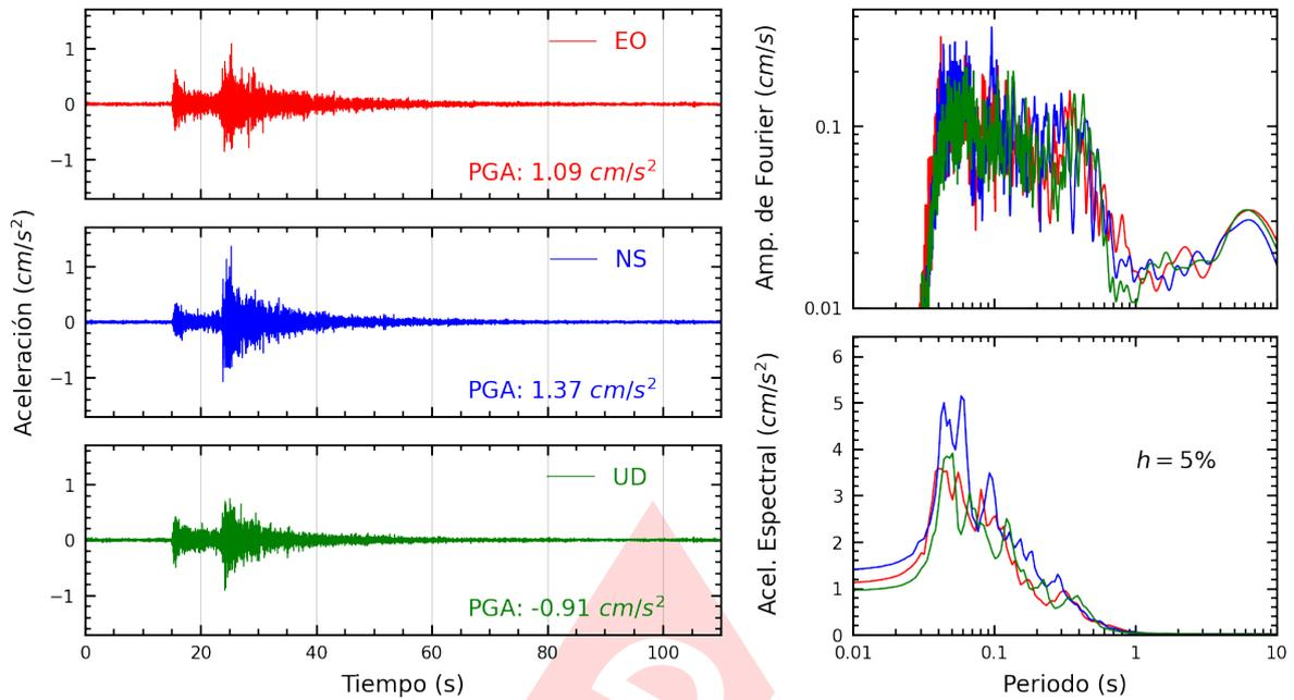
**Figura A.17:** Registros tiempo-historia, espectros de Fourier y de respuesta en las direcciones EO, NS y vertical de la estación IMCA. Sismo de Chilca, Cañete - Lima del 2024-11-06, 19:56:52 (Hora local)
