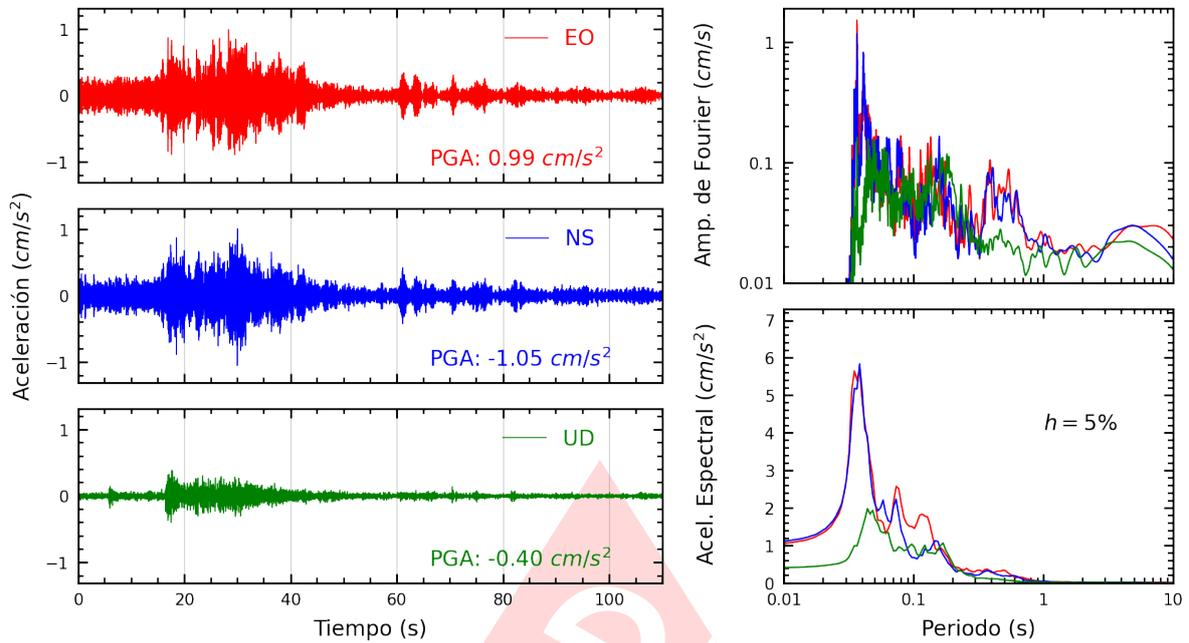
**Figura A.25:** Registros tiempo-historia, espectros de Fourier y de respuesta en las direcciones EO, NS y vertical de la estación DHNPE. Sismo de Chilca, Cañete - Lima del 2024-11-06, 19:56:52 (Hora local)
