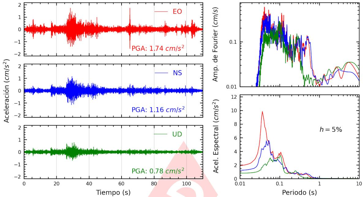
**Figura A.15:** Registros tiempo-historia, espectros de Fourier y de respuesta en las direcciones EO, NS y vertical de la estación OLIVO. Sismo de Chilca, Cañete - Lima del 2024-11-06, 19:56:52 (Hora local)
