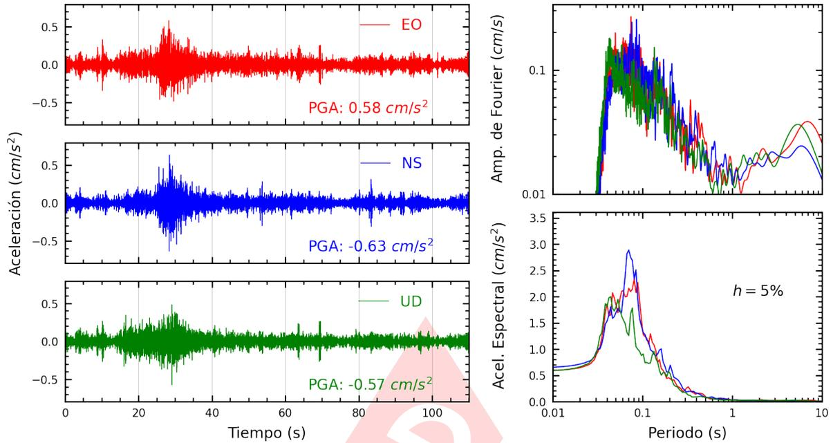
**Figura A.31:** Registros tiempo-historia, espectros de Fourier y de respuesta en las direcciones EO, NS y vertical de la estación UPCSM. Sismo de Chilca, Cañete - Lima del 2024-11-06, 19:56:52 (Hora local)
