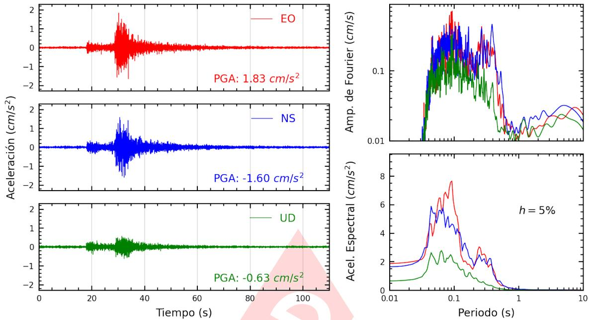
**Figura A.11:** Registros tiempo-historia, espectros de Fourier y de respuesta en las direcciones EO, NS y vertical de la estación DEFEN. Sismo de Chilca, Cañete - Lima del 2024-11-06, 19:56:52 (Hora local)
