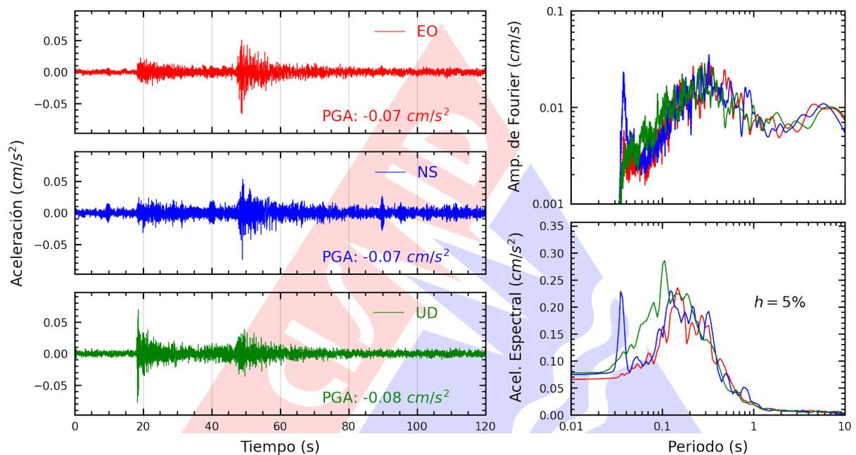
**Figura A.3:** Registros tiempo-historia, espectros de Fourier y de respuesta en las direcciones EO, NS y vertical de la estación UNJ. Sismo de Barranca, Datem del Marañón - Loreto del 2024-11-07, 07:03:38 (Hora local)
