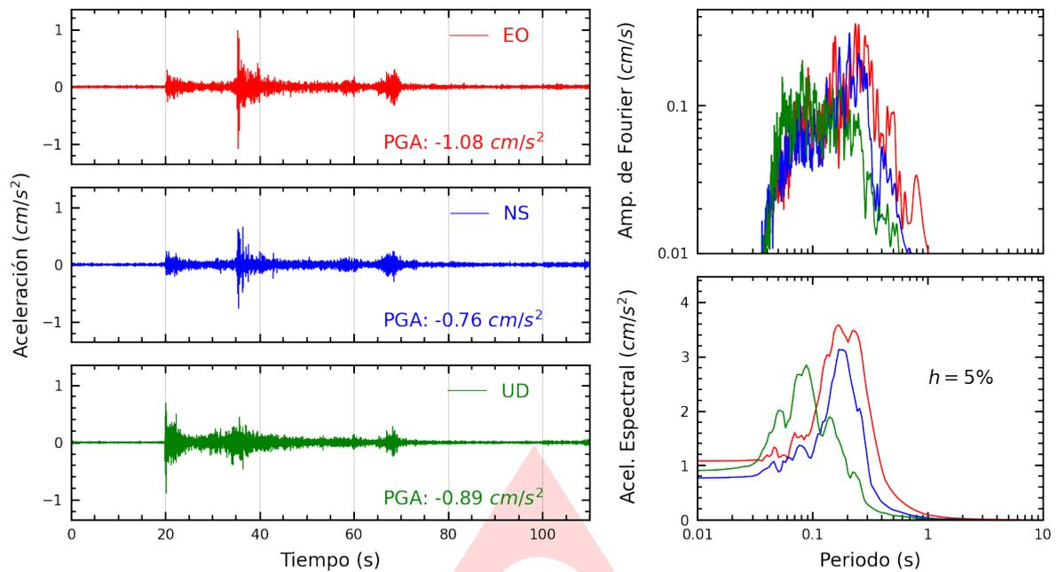
**Figura A.1:** Registros tiempo-historia, espectros de Fourier y de respuesta en las direcciones EO, NS y vertical de la estación UNAAA. Sismo de Barranca, Datem del Marañón - Loreto del 2024-11-07, 07:03:38 (Hora local)
