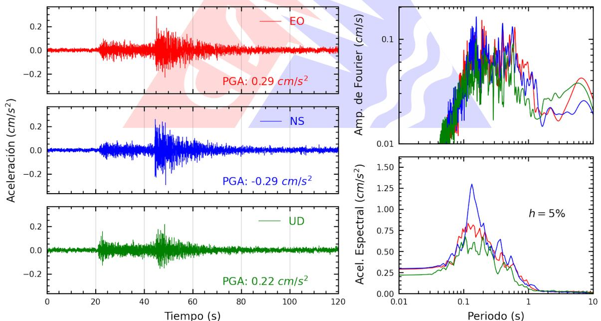
**Figura A.2:** Registros tiempo-historia, espectros de Fourier y de respuesta en las direcciones EO, NS y vertical de la estación UNTRM. Sismo de Barranca, Datem del Marañón - Loreto del 2024-11-07, 07:03:38 (Hora local)
