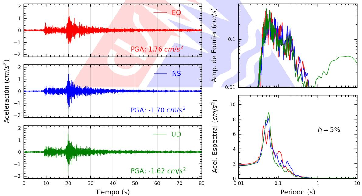
**Figura A.2:** Registros tiempo-historia, espectros de Fourier y de respuesta en las direcciones EO, NS y vertical de la estación SCARQ. Sismo de Quilca, Camana - Arequipa del 2024-11-19, 16:09:44 (Hora local)
