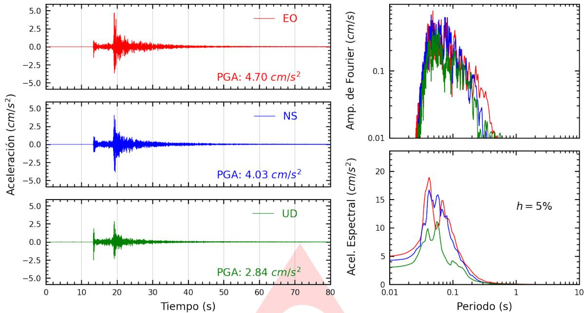
**Figura A.1:** Registros tiempo-historia, espectros de Fourier y de respuesta en las direcciones EO, NS y vertical de la estación UNSA2. Sismo de Quilca, Camana - Arequipa del 2024-11-19, 16:09:44 (Hora local)
