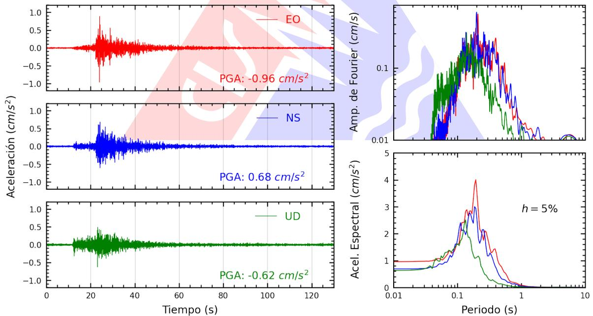
**Figura A.2:** Registros tiempo-historia, espectros de Fourier y de respuesta en las direcciones EO, NS y vertical de la estación UNP. Sismo de Mancora, Talara - Piura del 2024-11-19, 20:53:45 (Hora local)
