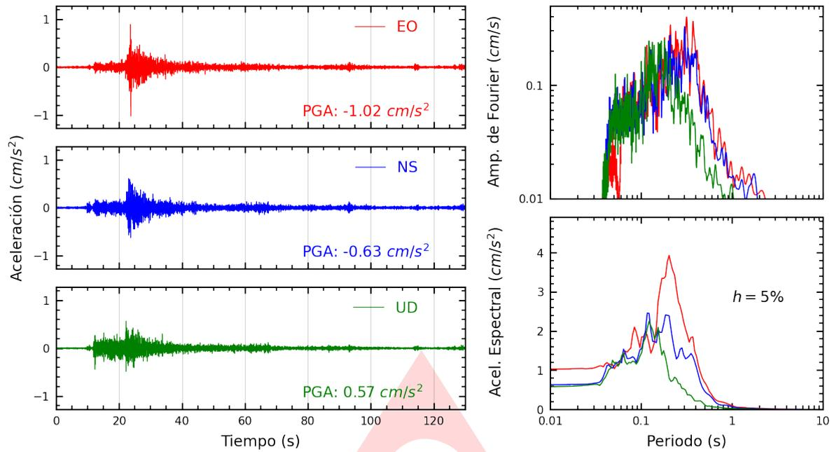
**Figura A.1:** Registros tiempo-historia, espectros de Fourier y de respuesta en las direcciones EO, NS y vertical de la estación UPAOP. Sismo de Mancora, Talara - Piura del 2024-11-19, 20:53:45 (Hora local)
