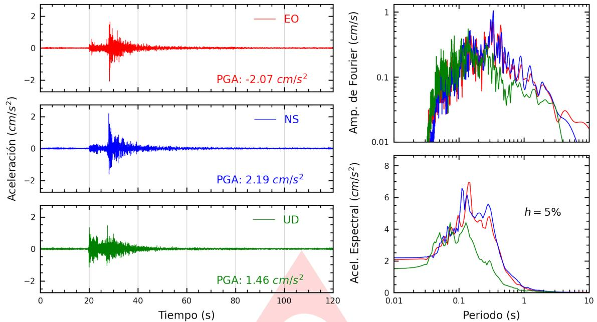
**Figura A.1:** Registros tiempo-historia, espectros de Fourier y de respuesta en las direcciones EO, NS y vertical de la estación SCPIU. Sismo de Paita, Paita - Piura del 2024-11-20, 14:48:27 (Hora local)
