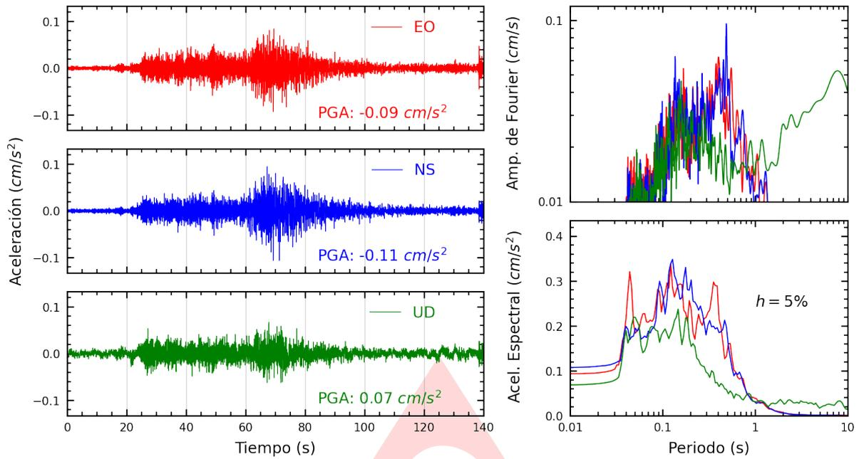
**Figura A.1:** Registros tiempo-historia, espectros de Fourier y de respuesta en las direcciones EO, NS y vertical de la estación SCARQ. Sismo de Chala, Caraveli - Arequipa del 2024-11-26, 01:31:30 (Hora local)
