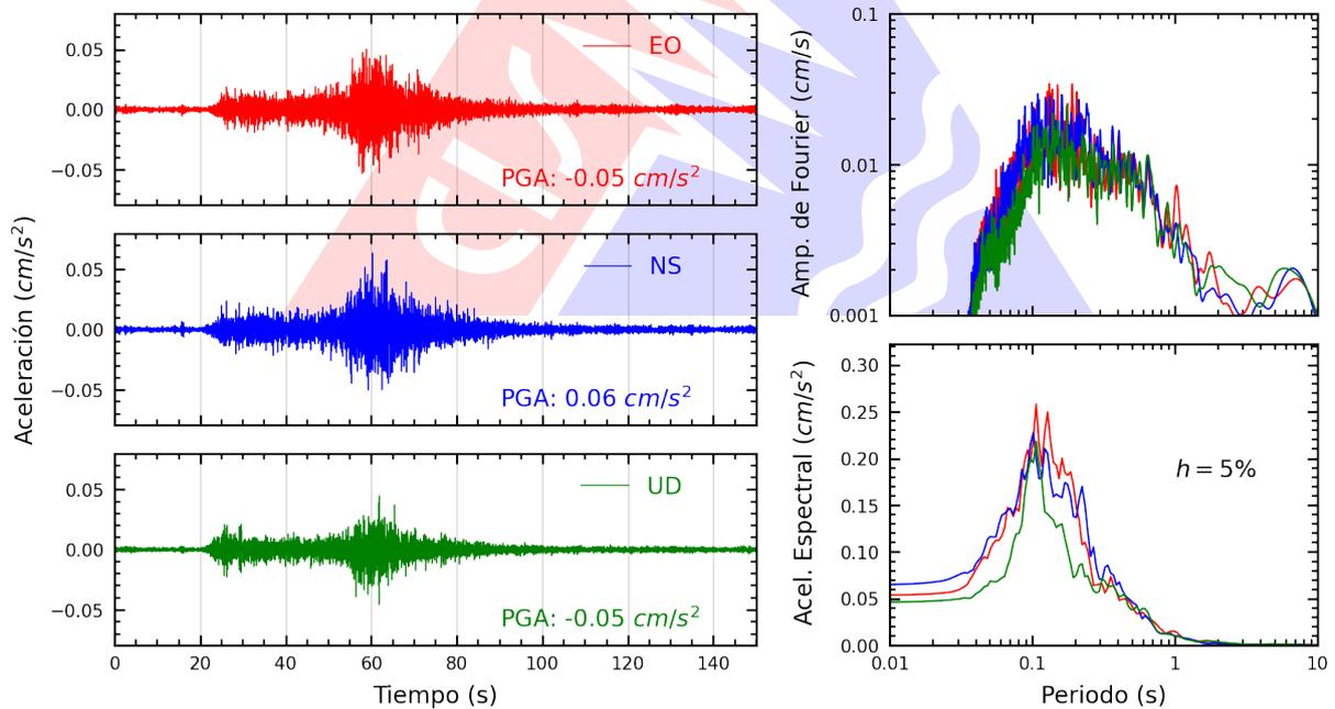
**Figura A.2:** Registros tiempo-historia, espectros de Fourier y de respuesta en las direcciones EO, NS y vertical de la estación UNSA2. Sismo de Chala, Caraveli - Arequipa del 2024-11-26, 01:31:30 (Hora local)
