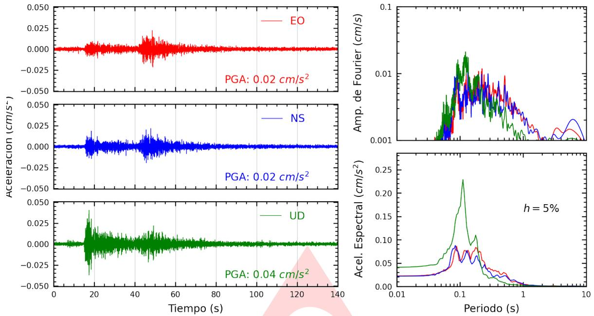
**Figura A.1:** Registros tiempo-historia, espectros de Fourier y de respuesta en las direcciones EO, NS y vertical de la estación UNIA. Sismo de Pozuzo, Oxapampa - Pasco del 2024-11-13, 04:52:41 (Hora local)
