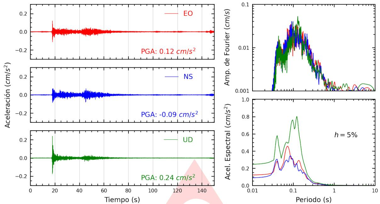
**Figura A.1:** Registros tiempo-historia, espectros de Fourier y de respuesta en las direcciones EO, NS y vertical de la estación UNSA2. Sismo de Colta, Paucar Del Sara Sara - Ayacucho del 2024-12-06, 09:17:43 (Hora local)
