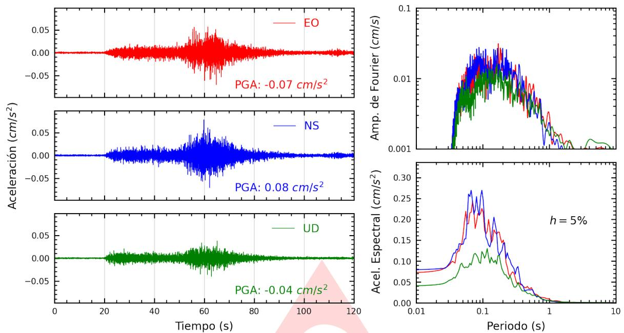
**Figura A.1:** Registros tiempo-historia, espectros de Fourier y de respuesta en las direcciones EO, NS y vertical de la estación UNSA2. Sismo de Yauca, Caraveli - Arequipa del 2024-12-10, 16:12:38 (Hora local)
