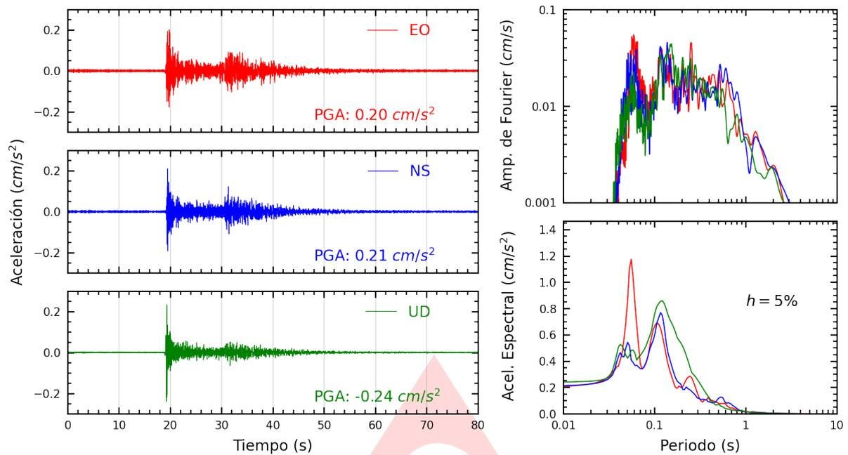
**Figura A.1:** Registros tiempo-historia, espectros de Fourier y de respuesta en las direcciones EO, NS y vertical de la estación UNMBA. Sismo de Querobamba, Sucre - Ayacucho del 2024-12-12, 04:28:31 (Hora local)
