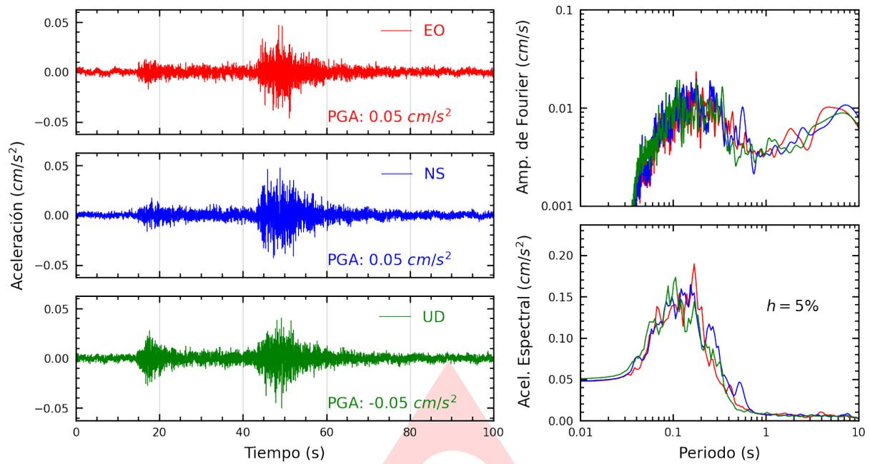
**Figura A.1:** Registros tiempo-historia, espectros de Fourier y de respuesta en las direcciones EO, NS y vertical de la estación CARAL. Sismo de Corongo, Corongo - Ancash del 2024-12-17, 05:02:34 (Hora local)
