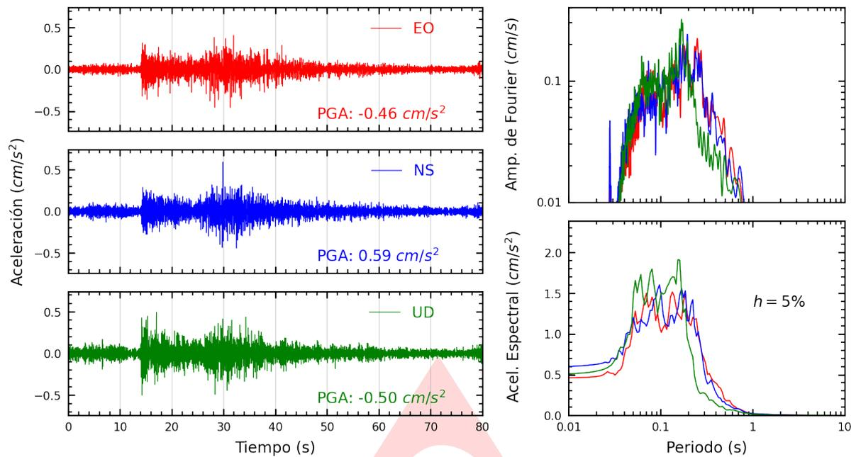
**Figura A.1:** Registros tiempo-historia, espectros de Fourier y de respuesta en las direcciones EO, NS y vertical de la estación UJBG4. Sismo de Ilo, Ilo - Moquegua del 2024-12-19, 16:35:14 (Hora local)
