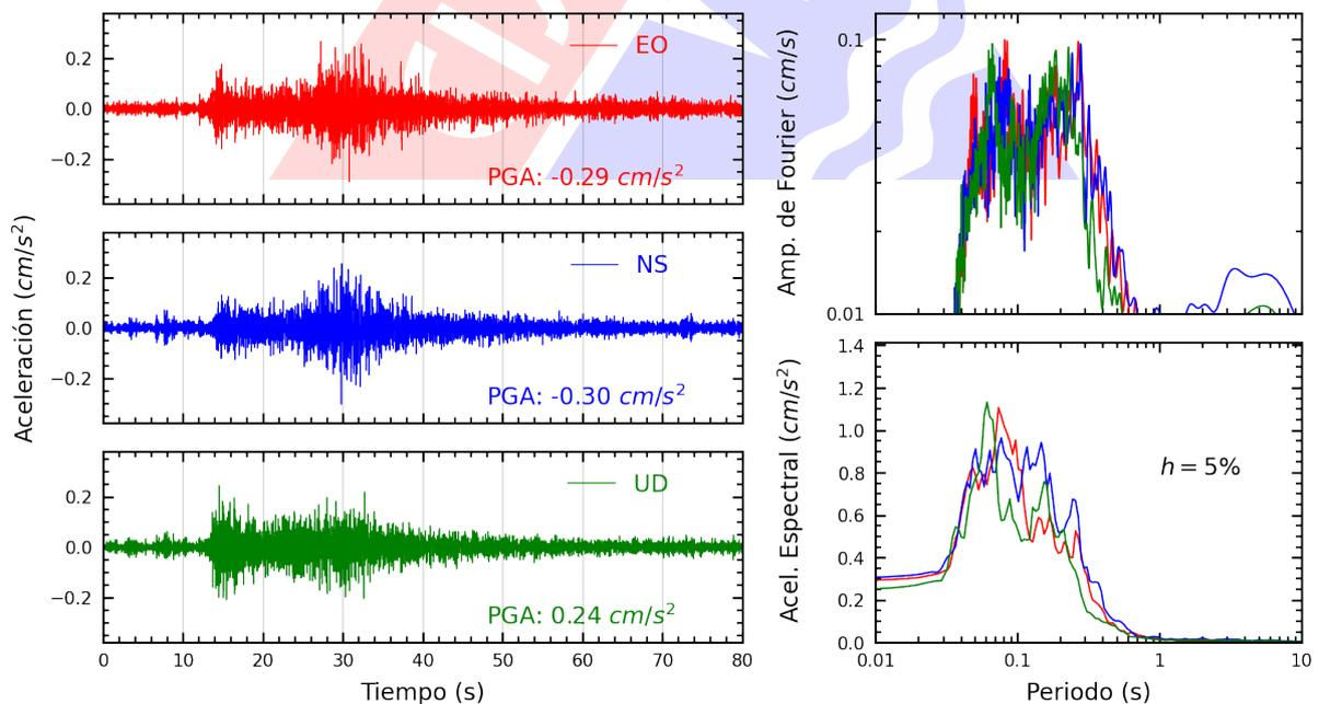
**Figura A.4:** Registros tiempo-historia, espectros de Fourier y de respuesta en las direcciones EO, NS y vertical de la estación CREY. Sismo de Ilo, Ilo - Moquegua del 2024-12-19, 16:35:14 (Hora local)
