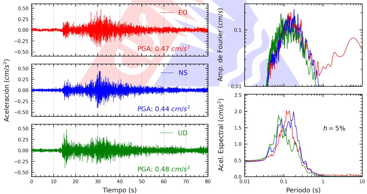
**Figura A.2:** Registros tiempo-historia, espectros de Fourier y de respuesta en las direcciones EO, NS y vertical de la estación UJBG3. Sismo de Ilo, Ilo - Moquegua del 2024-12-19, 16:35:14 (Hora local)
