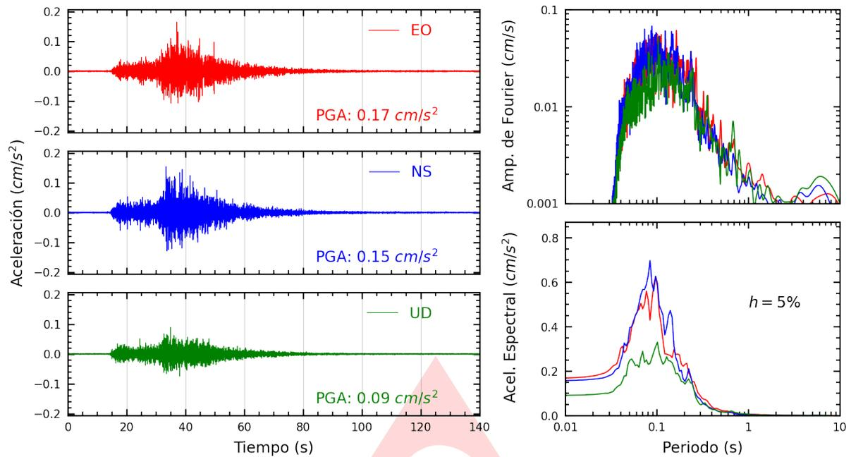
**Figura A.1:** Registros tiempo-historia, espectros de Fourier y de respuesta en las direcciones EO, NS y vertical de la estación UNSA2. Sismo de Ocoña, Camana - Arequipa del 2024-10-29, 10:45:31 (Hora local)
