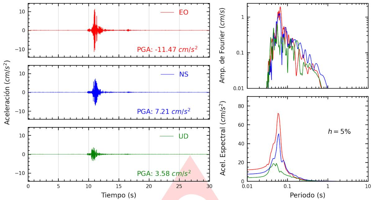
**Figura A.1:** Registros tiempo-historia, espectros de Fourier y de respuesta en las direcciones EO, NS y vertical de la estación UNMBA. Sismo de Abancay, Abancay - Apurímac del 2025-01-19, 20:52:54 (Hora local)
