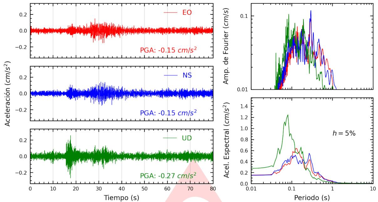
**Figura A.1:** Registros tiempo-historia, espectros de Fourier y de respuesta en las direcciones EO, NS y vertical de la estación UNICA. Sismo de Ica, Ica - Ica del 2025-01-20, 21:38:58 (Hora local)
