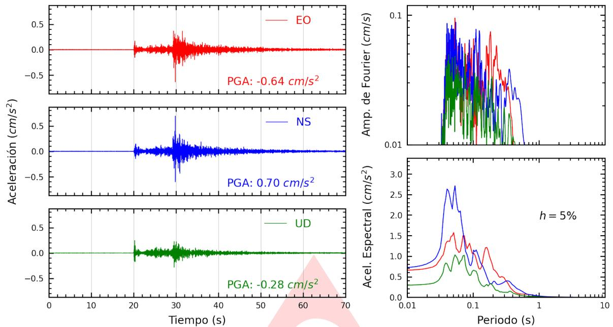
**Figura A.1:** Registros tiempo-historia, espectros de Fourier y de respuesta en las direcciones EO, NS y vertical de la estación UNSA2. Sismo de Punta De Bombon, Islay - Arequipa del 2025-01-23, 11:17:25 (Hora local)
