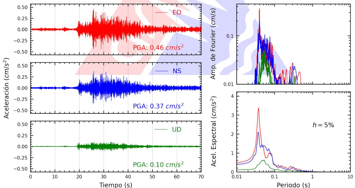
**Figura A.2:** Registros tiempo-historia, espectros de Fourier y de respuesta en las direcciones EO, NS y vertical de la estación UNAM. Sismo de Punta De Bombon, Islay - Arequipa del 2025-01-23, 11:17:25 (Hora local)
