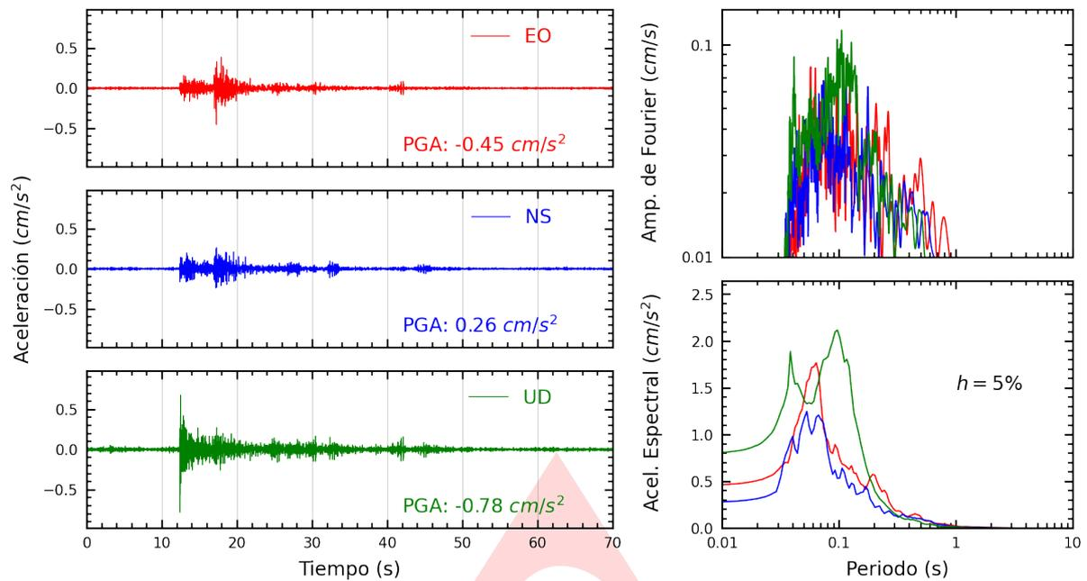
**Figura A.1:** Registros tiempo-historia, espectros de Fourier y de respuesta en las direcciones EO, NS y vertical de la estación SCCUS. Sismo de Paruro, Paruro - Cusco del 2025-02-08, 05:23:45 (Hora local)
