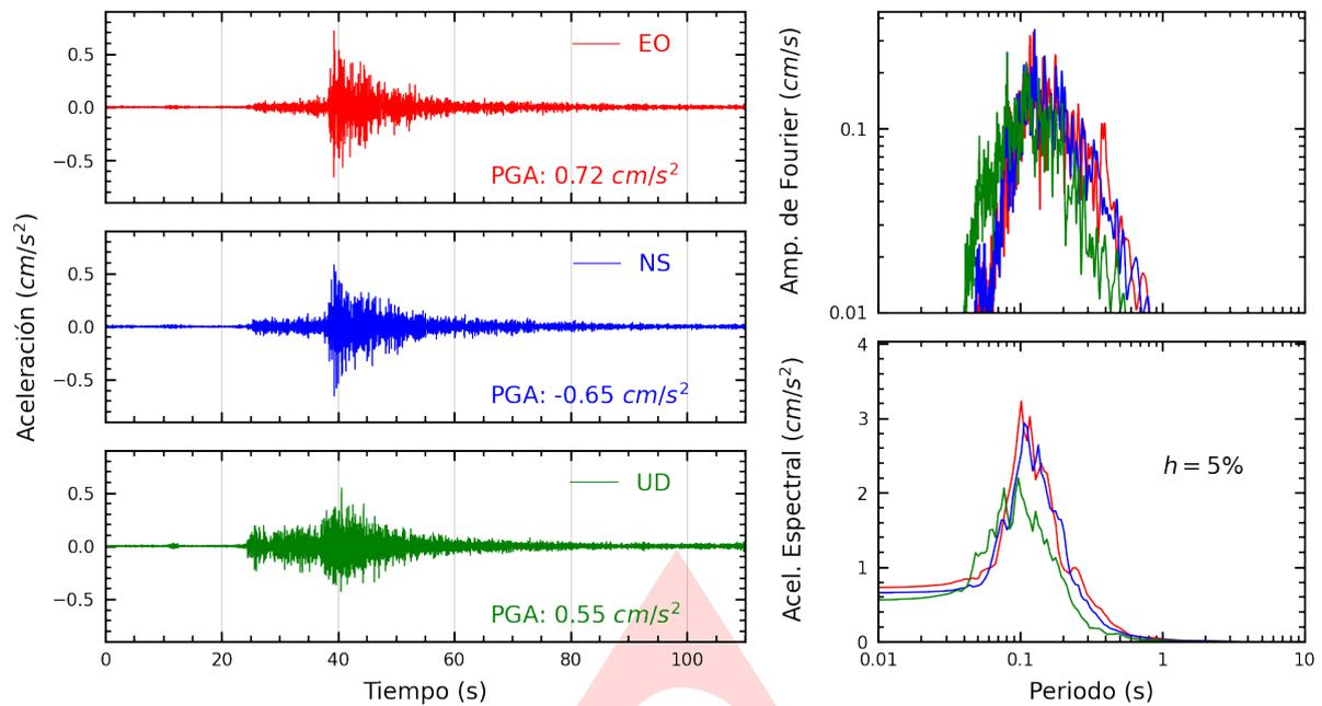
**Figura A.1:** Registros tiempo-historia, espectros de Fourier y de respuesta en las direcciones EO, NS y vertical de la estación UNP. Sismo de Mancora, Talara - Piura del 2025-02-27, 03:05:25 (Hora local)
