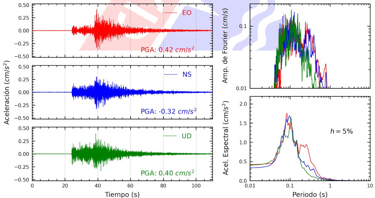
**Figura A.4:** Registros tiempo-historia, espectros de Fourier y de respuesta en las direcciones EO, NS y vertical de la estación UPAOP. Sismo de Mancora, Talara - Piura del 2025-02-27, 03:05:25 (Hora local)
