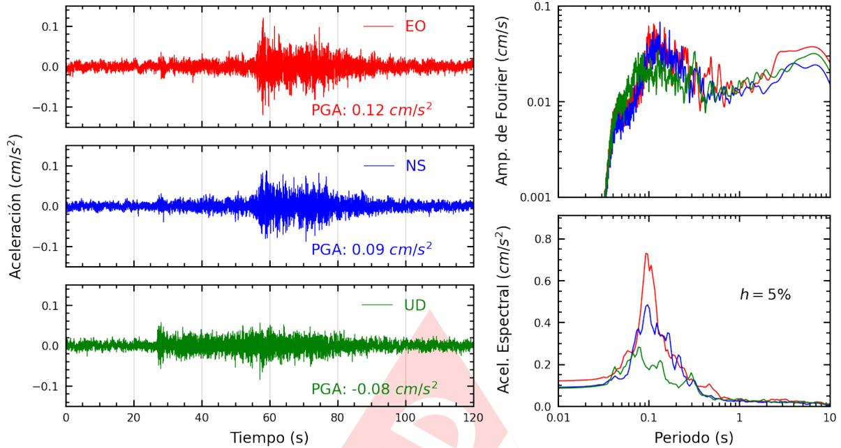
**Figura A.5:** Registros tiempo-historia, espectros de Fourier y de respuesta en las direcciones EO, NS y vertical de la estación UCVCH. Sismo de Mancora, Talara - Piura del 2025-02-27, 03:05:25 (Hora local)
