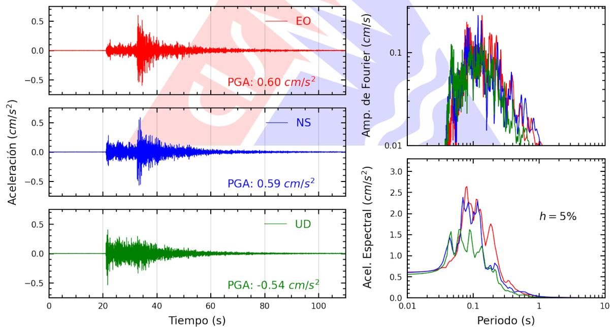
**Figura A.2:** Registros tiempo-historia, espectros de Fourier y de respuesta en las direcciones EO, NS y vertical de la estación UNF. Sismo de Mancora, Talara - Piura del 2025-02-27, 03:05:25 (Hora local)
