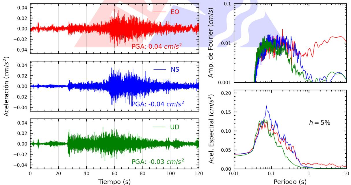
**Figura A.6:** Registros tiempo-historia, espectros de Fourier y de respuesta en las direcciones EO, NS y vertical de la estación SCCHI. Sismo de Mancora, Talara - Piura del 2025-02-27, 03:05:25 (Hora local)
