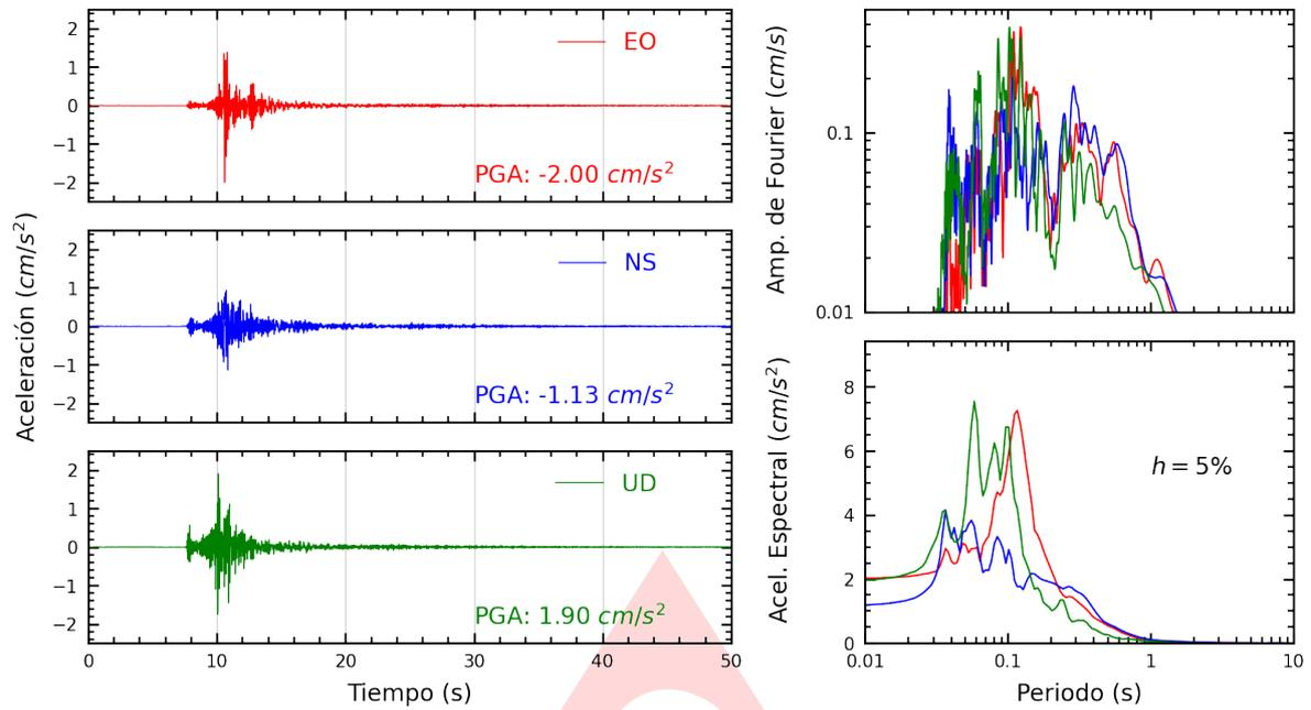
**Figura A.1:** Registros tiempo-historia, espectros de Fourier y de respuesta en las direcciones EO, NS y vertical de la estación UNJ. Sismo de Jaen, Jaen - Cajamarca del 2025-02-27, 03:27:44 (Hora local)
