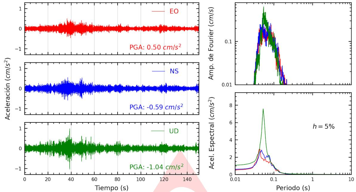
**Figura A.1:** Registros tiempo-historia, espectros de Fourier y de respuesta en las direcciones EO, NS y vertical de la estación SCAR2. Sismo de Atico, Caraveli - Arequipa del 2024-12-30, 04:51:12 (Hora local)
