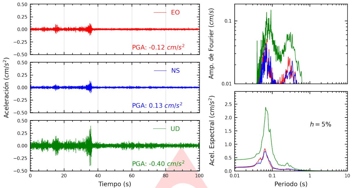
**Figura A.1:** Registros tiempo-historia, espectros de Fourier y de respuesta en las direcciones EO, NS y vertical de la estación UNAJ. Sismo de Capaso, El Collao - Puno del 2025-03-03, 12:54:04 (Hora local)
