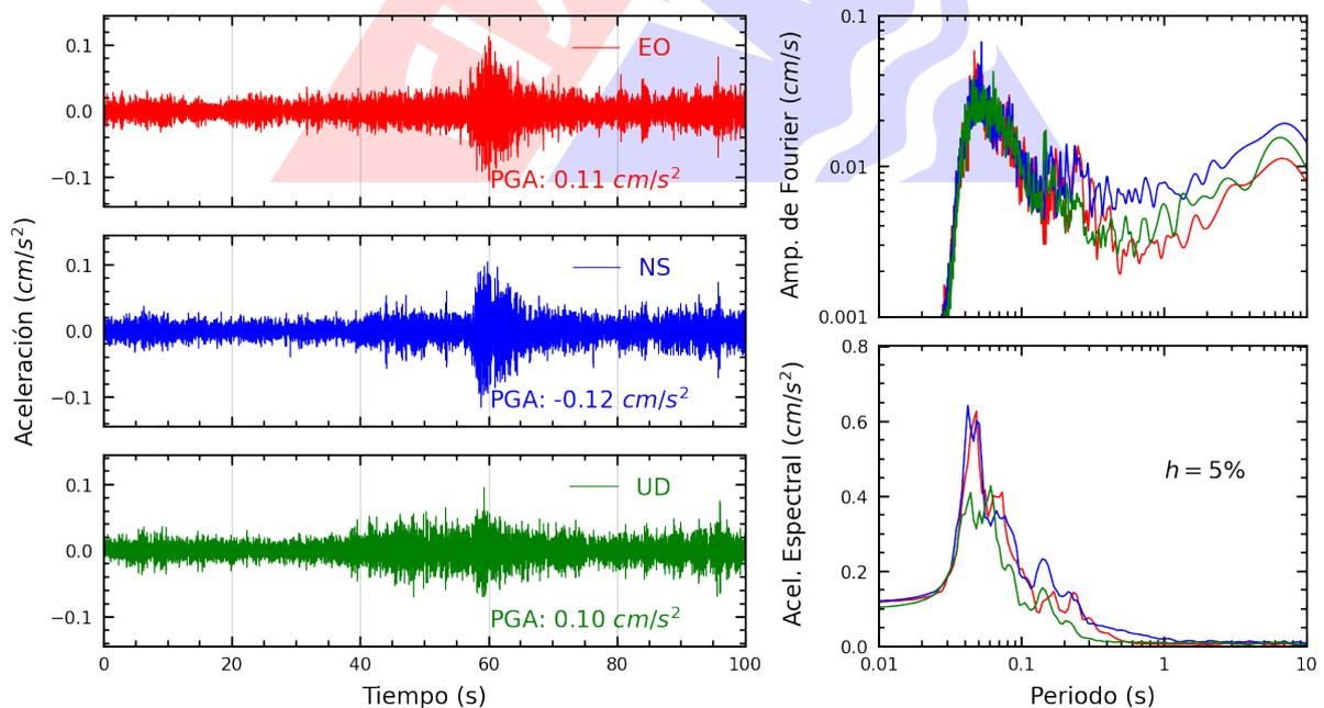
**Figura A.4:** Registros tiempo-historia, espectros de Fourier y de respuesta en las direcciones EO, NS y vertical de la estación CREY. Sismo de Capaso, El Collao - Puno del 2025-03-03, 12:54:04 (Hora local)
