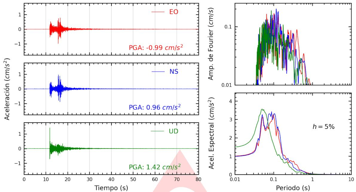
**Figura A.1:** Registros tiempo-historia, espectros de Fourier y de respuesta en las direcciones EO, NS y vertical de la estación UNCP. Sismo de Huancayo, Huancayo - Junin del 2025-03-08, 22:05:46 (Hora local)
