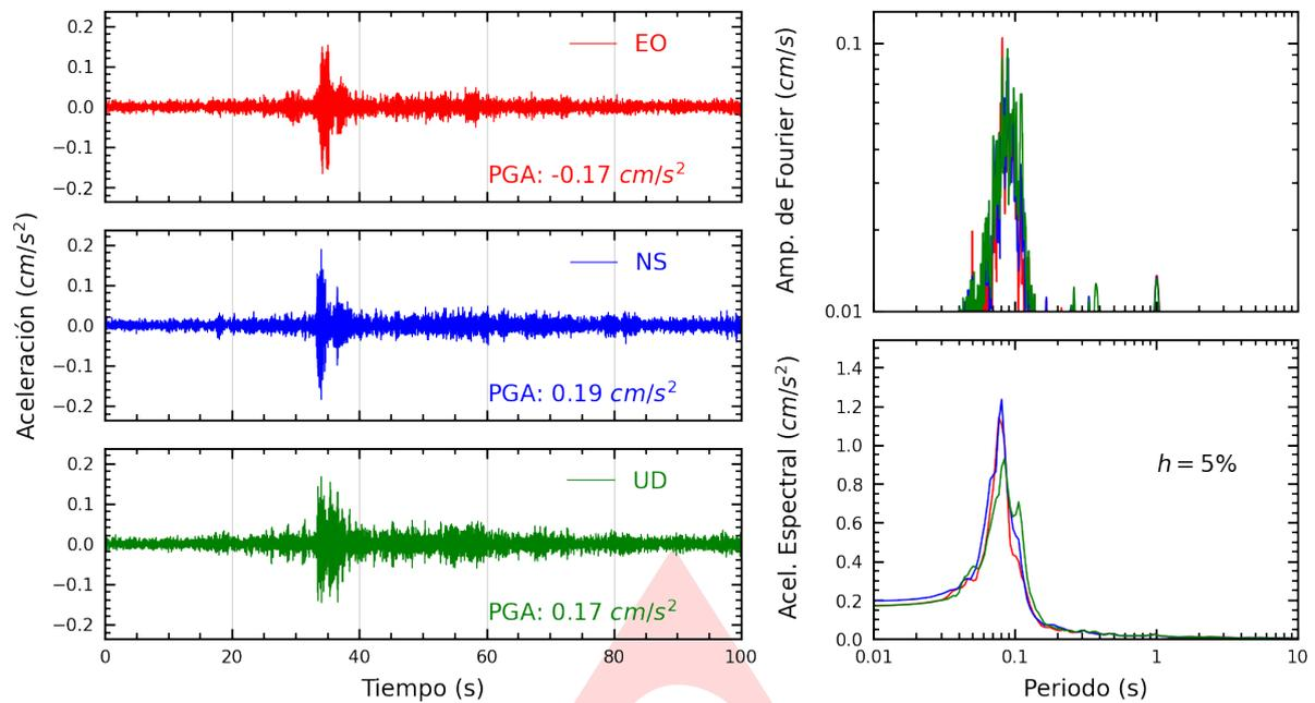
**Figura A.1:** Registros tiempo-historia, espectros de Fourier y de respuesta en las direcciones EO, NS y vertical de la estación UNICA. Sismo de Chala, Caraveli - Arequipa del 2025-03-09, 02:37:44 (Hora local)
