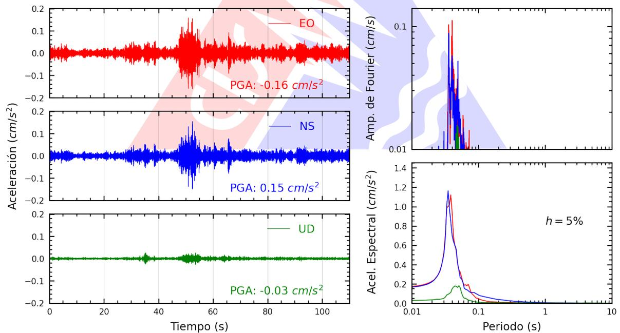
**Figura A.2:** Registros tiempo-historia, espectros de Fourier y de respuesta en las direcciones EO, NS y vertical de la estación UNAM. Sismo de Marcona, Nazca - Ica del 2025-03-17, 18:09:10 (Hora local)
