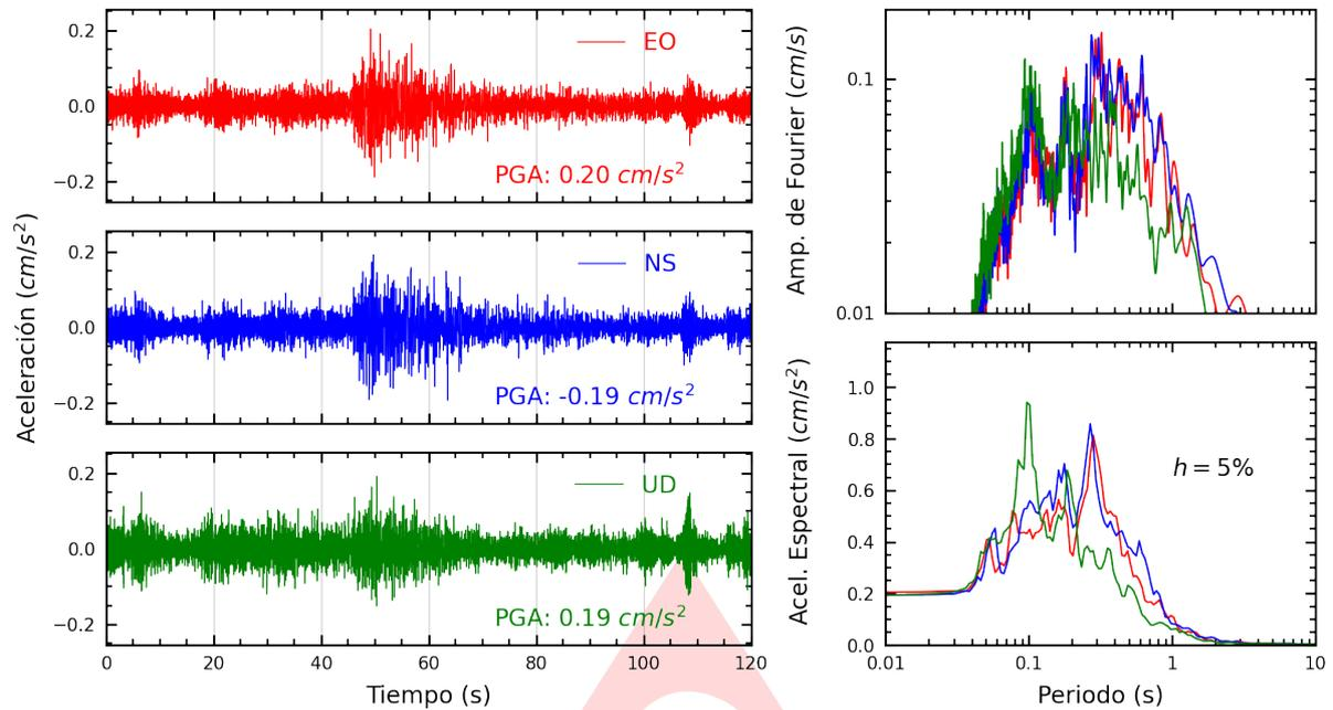
**Figura A.1:** Registros tiempo-historia, espectros de Fourier y de respuesta en las direcciones EO, NS y vertical de la estación UNICA. Sismo de Marcona, Nazca - Ica del 2025-03-17, 18:09:10 (Hora local)
