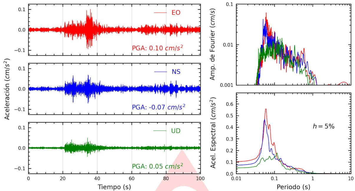
**Figura A.1:** Registros tiempo-historia, espectros de Fourier y de respuesta en las direcciones EO, NS y vertical de la estación UNMBA. Sismo de Anco, La Mar - Ayacucho del 2025-03-29, 08:35:11 (Hora local)
