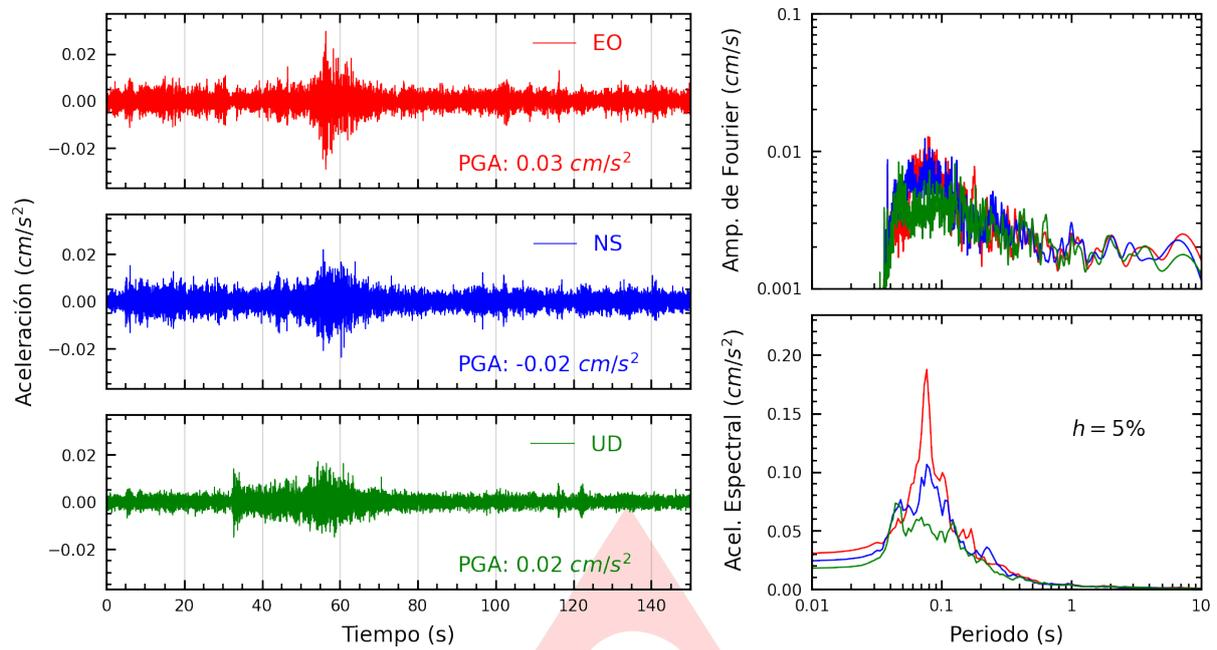
**Figura A.1:** Registros tiempo-historia, espectros de Fourier y de respuesta en las direcciones EO, NS y vertical de la estación UNF. Sismo de Tumbes, Tumbes - Tumbes del 2025-05-03, 22:56:51 (Hora local)
