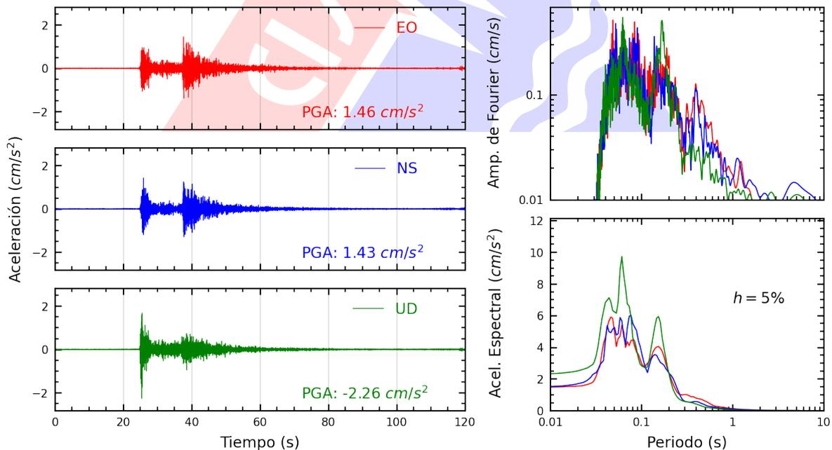
**Figura A.4:** Registros tiempo-historia, espectros de Fourier y de respuesta en las direcciones EO, NS y vertical de la estación CREY. Sismo de Calana, Tacna - Tacna del 2025-05-19, 06:17:08 (Hora local)
