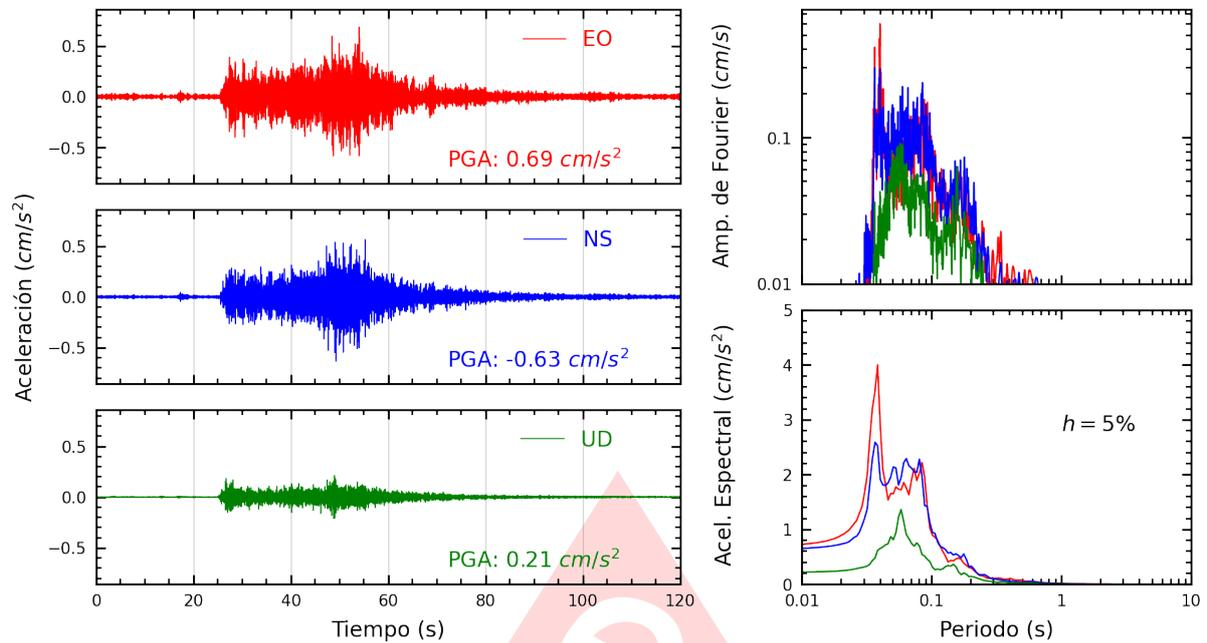
**Figura A.5:** Registros tiempo-historia, espectros de Fourier y de respuesta en las direcciones EO, NS y vertical de la estación UNAM. Sismo de Calana, Tacna - Tacna del 2025-05-19, 06:17:08 (Hora local)
