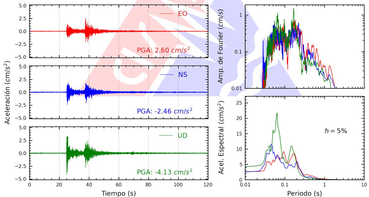
**Figura A.2:** Registros tiempo-historia, espectros de Fourier y de respuesta en las direcciones EO, NS y vertical de la estación UJBG4. Sismo de Calana, Tacna - Tacna del 2025-05-19, 06:17:08 (Hora local)
