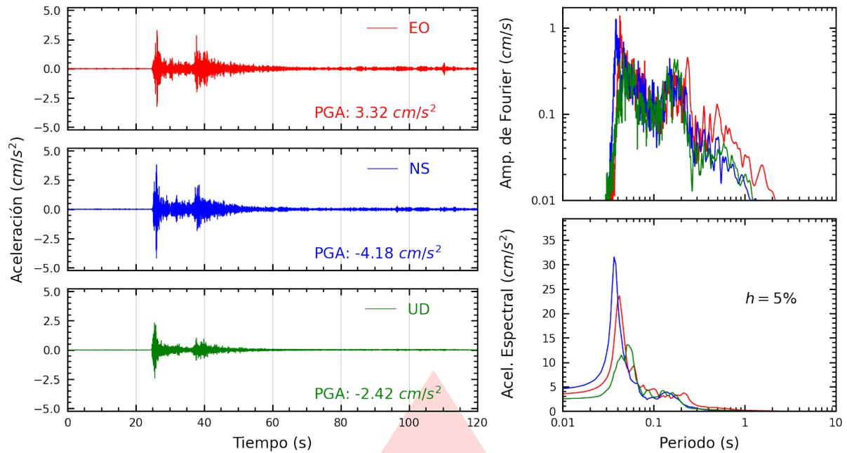
**Figura A.1:** Registros tiempo-historia, espectros de Fourier y de respuesta en las direcciones EO, NS y vertical de la estación UPTAC. Sismo de Calana, Tacna - Tacna del 2025-05-19, 06:17:08 (Hora local)
