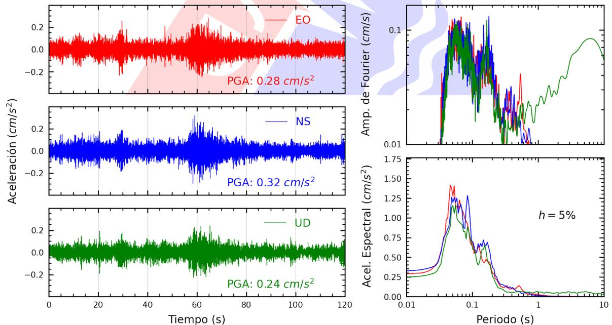
**Figura A.6:** Registros tiempo-historia, espectros de Fourier y de respuesta en las direcciones EO, NS y vertical de la estación SCARQ. Sismo de Calana, Tacna - Tacna del 2025-05-19, 06:17:08 (Hora local)
