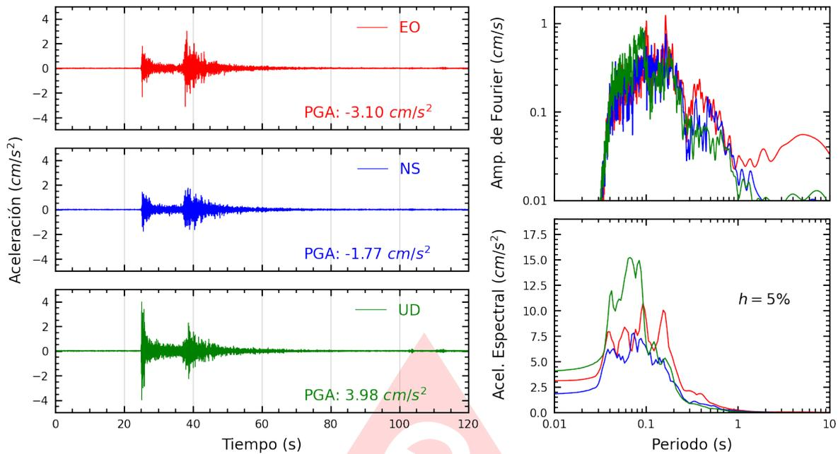
**Figura A.3:** Registros tiempo-historia, espectros de Fourier y de respuesta en las direcciones EO, NS y vertical de la estación UJBG3. Sismo de Calana, Tacna - Tacna del 2025-05-19, 06:17:08 (Hora local)
