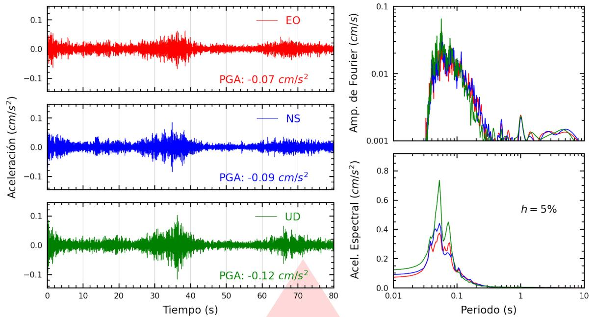
**Figura A.1:** Registros tiempo-historia, espectros de Fourier y de respuesta en las direcciones EO, NS y vertical de la estación ASIA. Sismo de Yauca, Caraveli - Arequipa del 2025-05-19, 11:14:35 (Hora local)
