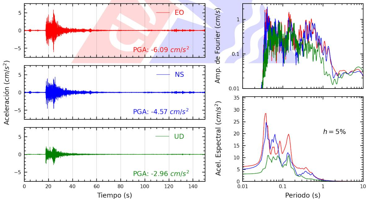
**Figura A.34:** Registros tiempo-historia, espectros de Fourier y de respuesta en las direcciones EO, NS y vertical de la estación DHNPE. Sismo de Provincia Constitucional del Callao , Callao - Lima del 2025-06-16, 12:40:17 (Hora local)
