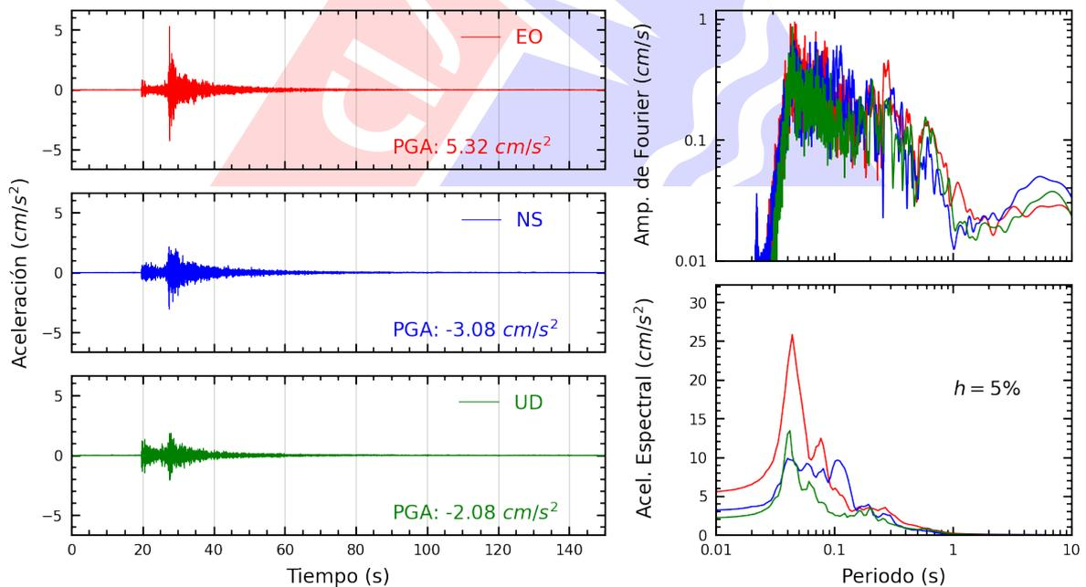
**Figura A.36:** Registros tiempo-historia, espectros de Fourier y de respuesta en las direcciones EO, NS y vertical de la estación SJLCE. Sismo de Provincia Constitucional del Callao , Callao - Lima del 2025-06-16, 12:40:17 (Hora local)
