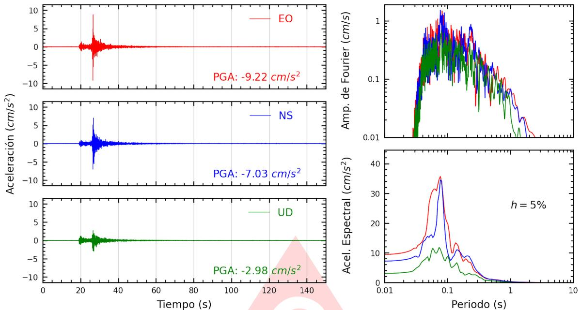
**Figura A.23:** Registros tiempo-historia, espectros de Fourier y de respuesta en las direcciones EO, NS y vertical de la estación BORJA. Sismo de Provincia Constitucional del Callao , Callao - Lima del 2025-06-16, 12:40:17 (Hora local)
