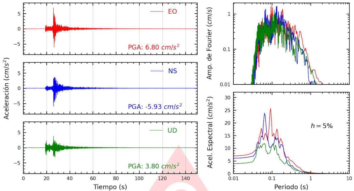
**Figura A.31:** Registros tiempo-historia, espectros de Fourier y de respuesta en las direcciones EO, NS y vertical de la estación JALV2. Sismo de Provincia Constitucional del Callao , Callao - Lima del 2025-06-16, 12:40:17 (Hora local)
