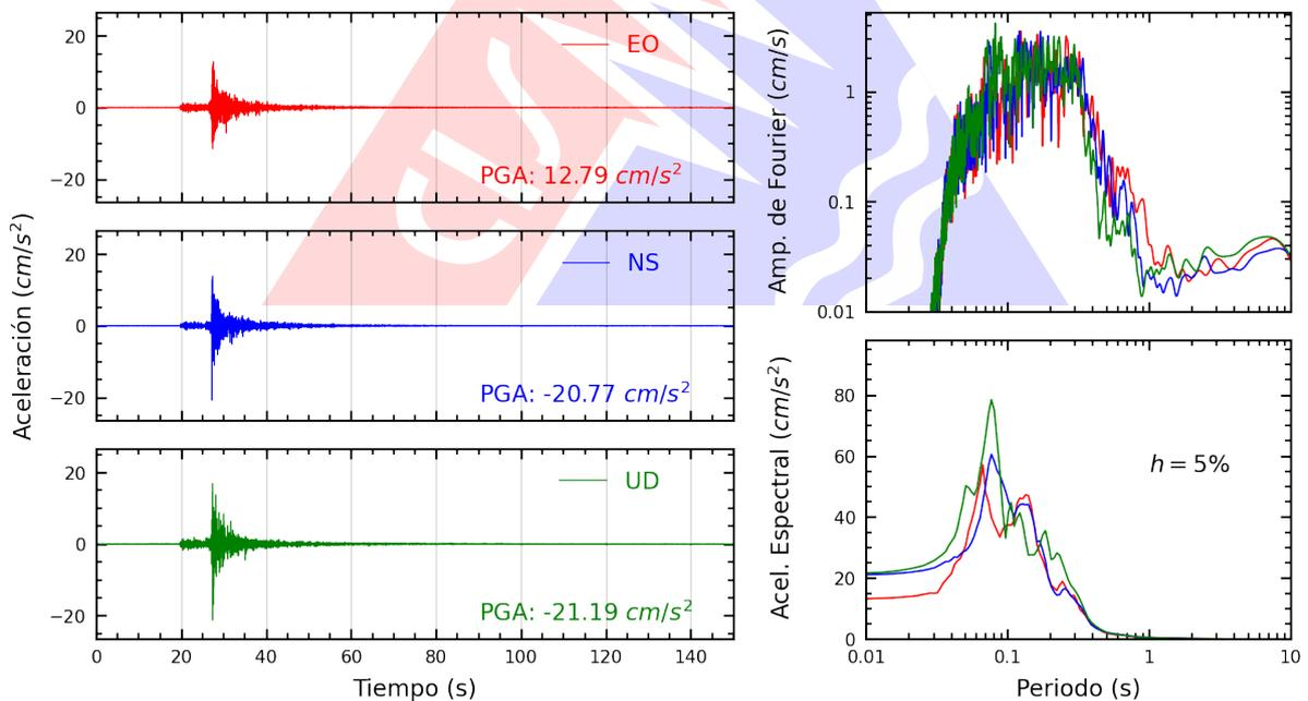
**Figura A.2:** Registros tiempo-historia, espectros de Fourier y de respuesta en las direcciones EO, NS y vertical de la estación SOVES. Sismo de Provincia Constitucional del Callao , Callao - Lima del 2025-06-16, 12:40:17 (Hora local)
