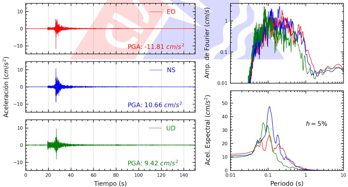
**Figura A.14:** Registros tiempo-historia, espectros de Fourier y de respuesta en las direcciones EO, NS y vertical de la estación SOCHO. Sismo de Provincia Constitucional del Callao , Callao - Lima del 2025-06-16, 12:40:17 (Hora local)
