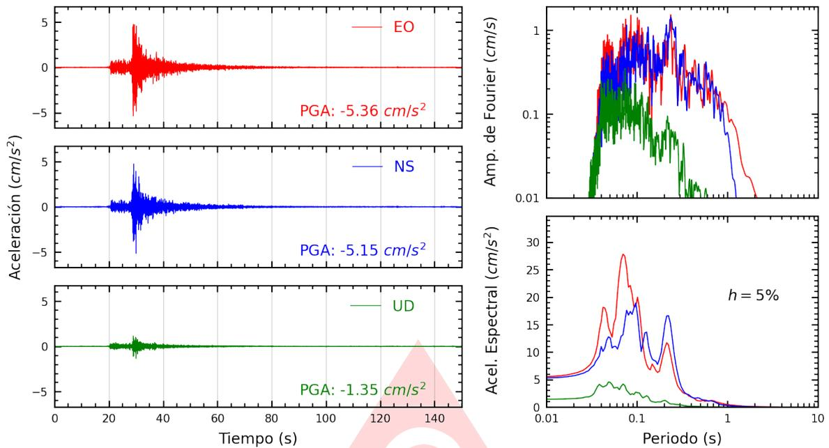
**Figura A.35:** Registros tiempo-historia, espectros de Fourier y de respuesta en las direcciones EO, NS y vertical de la estación UCVA2. Sismo de Provincia Constitucional del Callao , Callao - Lima del 2025-06-16, 12:40:17 (Hora local)
