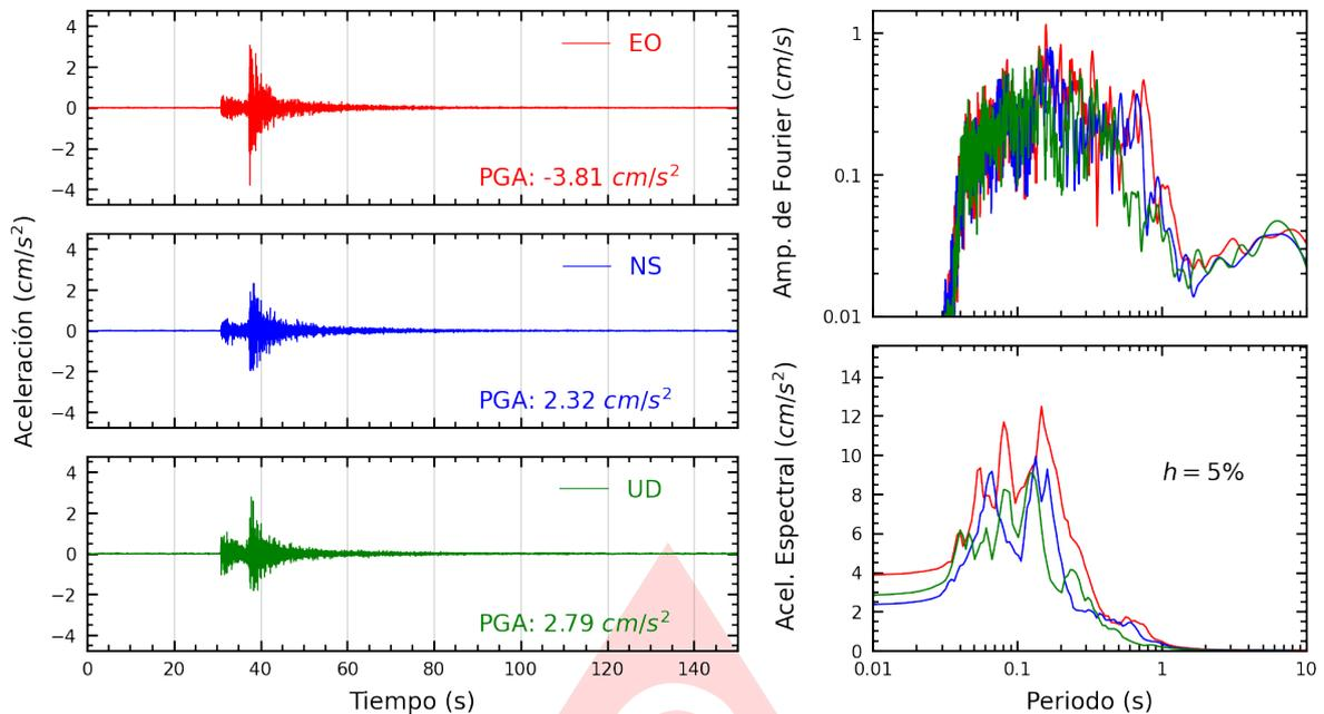
**Figura A.39:** Registros tiempo-historia, espectros de Fourier y de respuesta en las direcciones EO, NS y vertical de la estación UNMSM. Sismo de Provincia Constitucional del Callao , Callao - Lima del 2025-06-16, 12:40:17 (Hora local)
