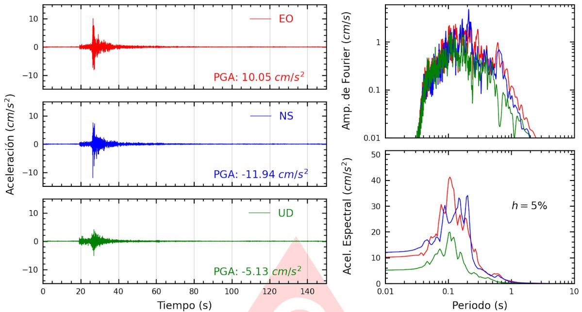
**Figura A.13:** Registros tiempo-historia, espectros de Fourier y de respuesta en las direcciones EO, NS y vertical de la estación SCCHO. Sismo de Provincia Constitucional del Callao , Callao - Lima del 2025-06-16, 12:40:17 (Hora local)
