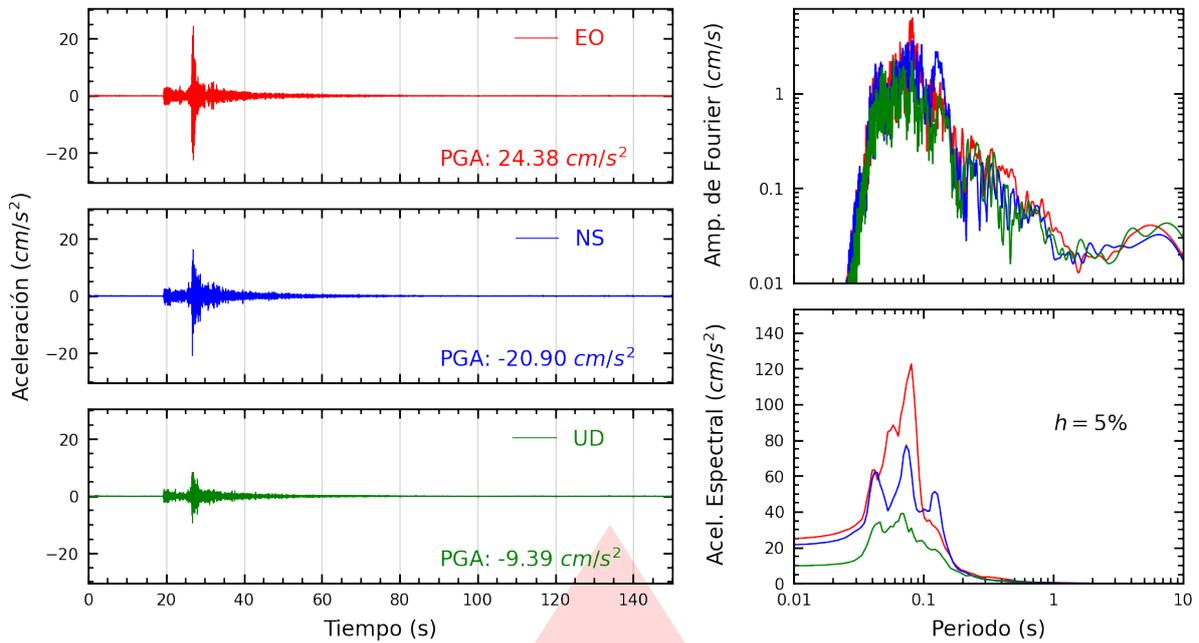
**Figura A.1:** Registros tiempo-historia, espectros de Fourier y de respuesta en las direcciones EO, NS y vertical de la estación JOSEO. Sismo de Provincia Constitucional del Callao , Callao - Lima del 2025-06-16, 12:40:17 (Hora local)
