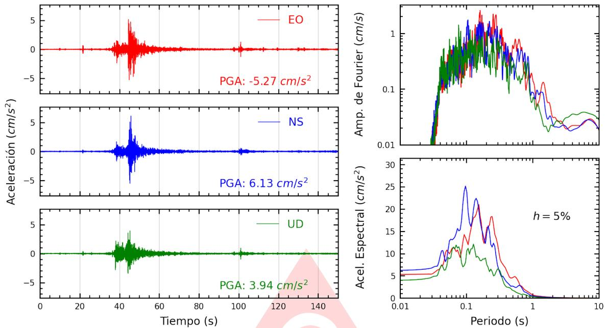
**Figura A.33:** Registros tiempo-historia, espectros de Fourier y de respuesta en las direcciones EO, NS y vertical de la estación PRADO. Sismo de Provincia Constitucional del Callao , Callao - Lima del 2025-06-16, 12:40:17 (Hora local)
