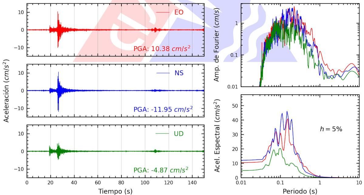
**Figura A.12:** Registros tiempo-historia, espectros de Fourier y de respuesta en las direcciones EO, NS y vertical de la estación SOBAR. Sismo de Provincia Constitucional del Callao , Callao - Lima del 2025-06-16, 12:40:17 (Hora local)
