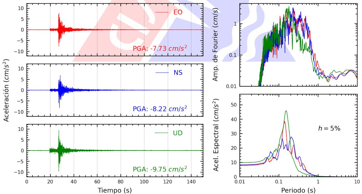
**Figura A.20:** Registros tiempo-historia, espectros de Fourier y de respuesta en las direcciones EO, NS y vertical de la estación MDPP. Sismo de Provincia Constitucional del Callao , Callao - Lima del 2025-06-16, 12:40:17 (Hora local)
