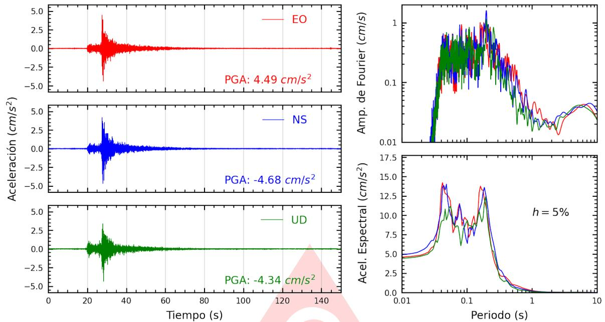
**Figura A.37:** Registros tiempo-historia, espectros de Fourier y de respuesta en las direcciones EO, NS y vertical de la estación USMP. Sismo de Provincia Constitucional del Callao , Callao - Lima del 2025-06-16, 12:40:17 (Hora local)
