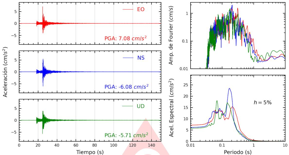
**Figura A.29:** Registros tiempo-historia, espectros de Fourier y de respuesta en las direcciones EO, NS y vertical de la estación UNFV. Sismo de Provincia Constitucional del Callao , Callao - Lima del 2025-06-16, 12:40:17 (Hora local)
