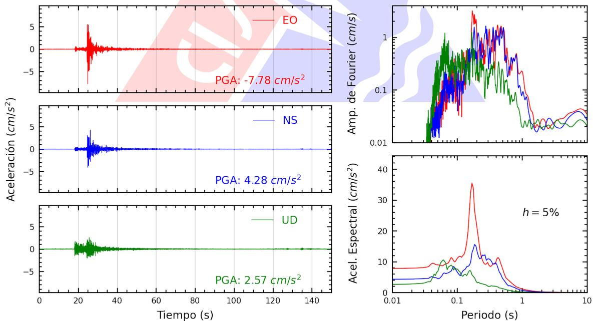
**Figura A.26:** Registros tiempo-historia, espectros de Fourier y de respuesta en las direcciones EO, NS y vertical de la estación ACAPU. Sismo de Provincia Constitucional del Callao , Callao - Lima del 2025-06-16, 12:40:17 (Hora local)
