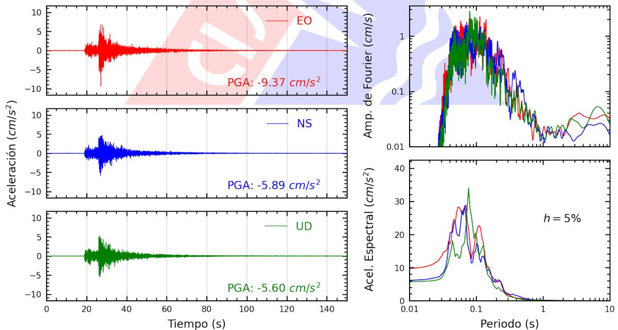
**Figura A.22:** Registros tiempo-historia, espectros de Fourier y de respuesta en las direcciones EO, NS y vertical de la estación AMORE. Sismo de Provincia Constitucional del Callao , Callao - Lima del 2025-06-16, 12:40:17 (Hora local)
