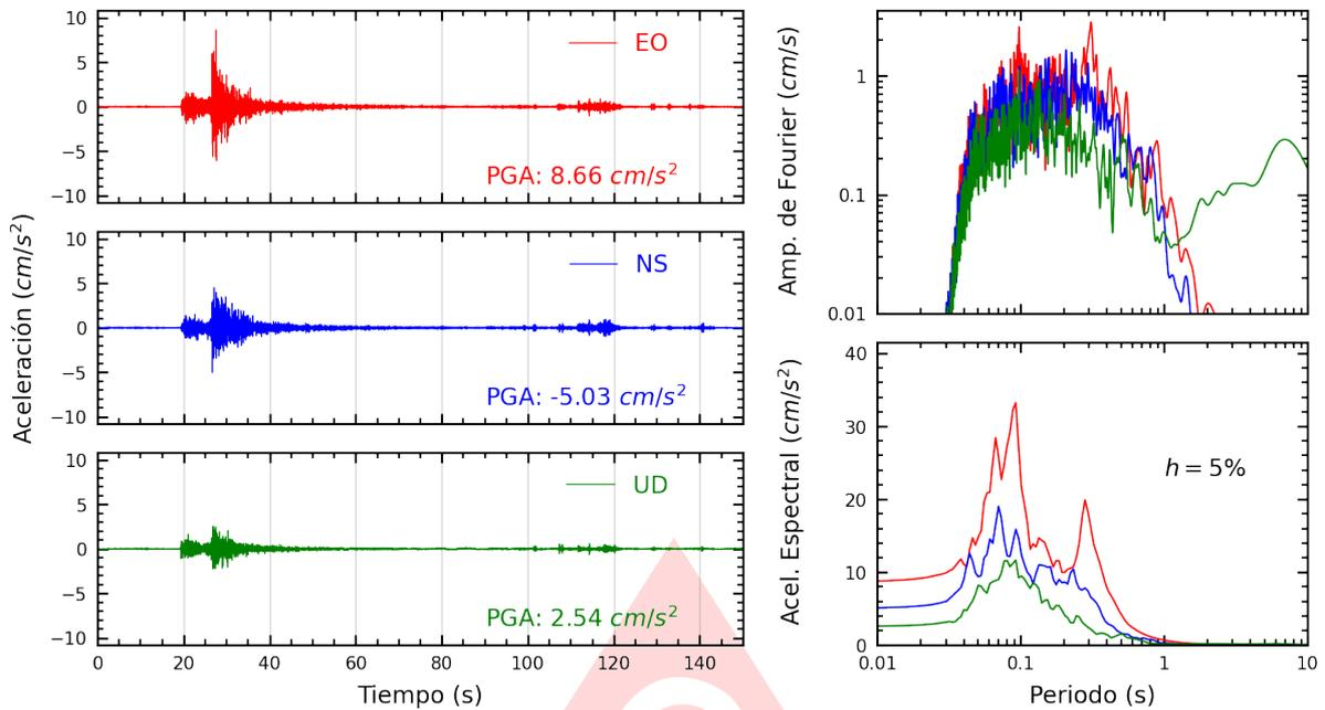
**Figura A.25:** Registros tiempo-historia, espectros de Fourier y de respuesta en las direcciones EO, NS y vertical de la estación BRISA. Sismo de Provincia Constitucional del Callao , Callao - Lima del 2025-06-16, 12:40:17 (Hora local)
