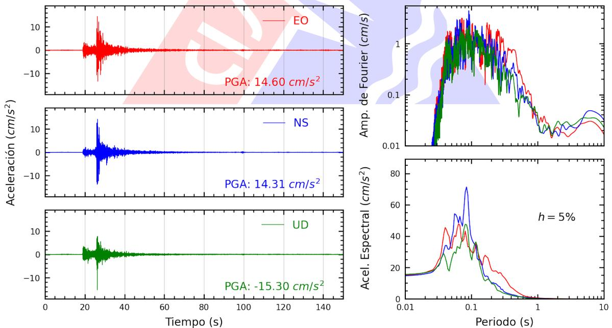
**Figura A.10:** Registros tiempo-historia, espectros de Fourier y de respuesta en las direcciones EO, NS y vertical de la estación INDEP. Sismo de Provincia Constitucional del Callao , Callao - Lima del 2025-06-16, 12:40:17 (Hora local)
