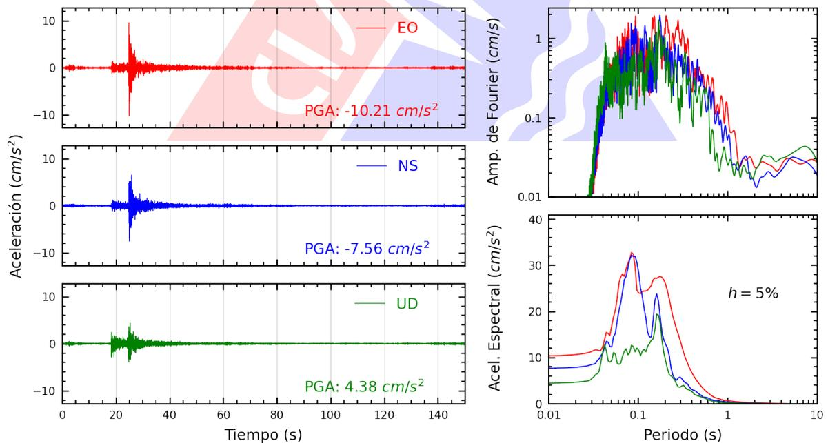
**Figura A.18:** Registros tiempo-historia, espectros de Fourier y de respuesta en las direcciones EO, NS y vertical de la estación UPCSM. Sismo de Provincia Constitucional del Callao , Callao - Lima del 2025-06-16, 12:40:17 (Hora local)
