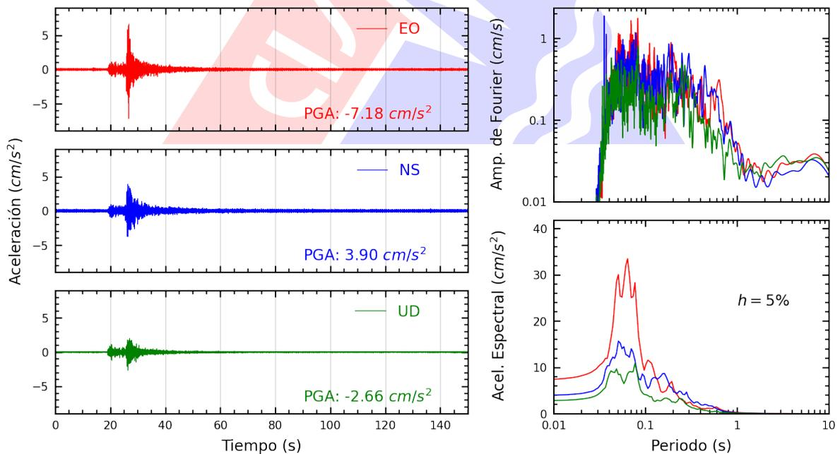
**Figura A.28:** Registros tiempo-historia, espectros de Fourier y de respuesta en las direcciones EO, NS y vertical de la estación UPCVI. Sismo de Provincia Constitucional del Callao , Callao - Lima del 2025-06-16, 12:40:17 (Hora local)
