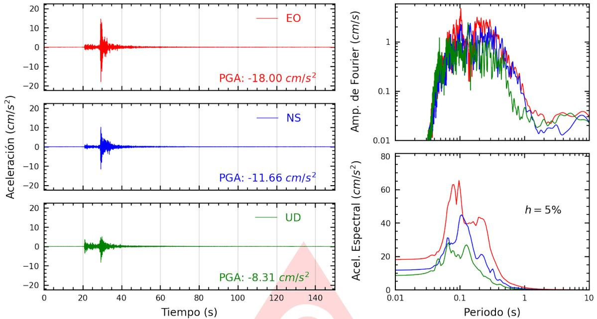
**Figura A.5:** Registros tiempo-historia, espectros de Fourier y de respuesta en las direcciones EO, NS y vertical de la estación USILP. Sismo de Provincia Constitucional del Callao , Callao - Lima del 2025-06-16, 12:40:17 (Hora local)
