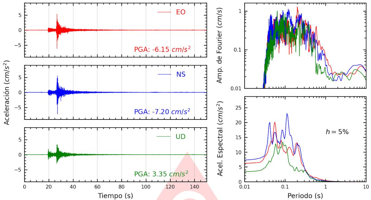
**Figura A.27:** Registros tiempo-historia, espectros de Fourier y de respuesta en las direcciones EO, NS y vertical de la estación COMAS. Sismo de Provincia Constitucional del Callao , Callao - Lima del 2025-06-16, 12:40:17 (Hora local)
