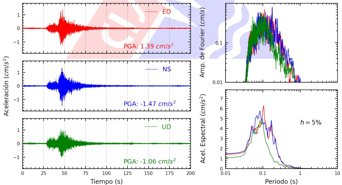
**Figura A.42:** Registros tiempo-historia, espectros de Fourier y de respuesta en las direcciones EO, NS y vertical de la estación ASIA. Sismo de Provincia Constitucional del Callao , Callao - Lima del 2025-06-16, 12:40:17 (Hora local)
