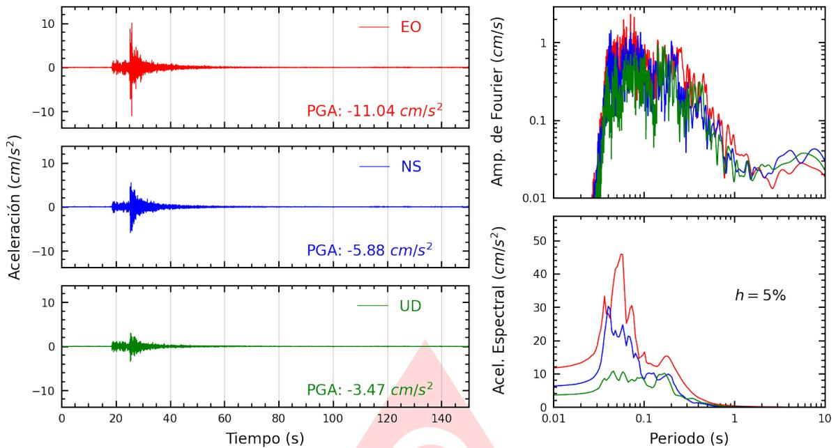
**Figura A.15:** Registros tiempo-historia, espectros de Fourier y de respuesta en las direcciones EO, NS y vertical de la estación CEPRE. Sismo de Provincia Constitucional del Callao , Callao - Lima del 2025-06-16, 12:40:17 (Hora local)
