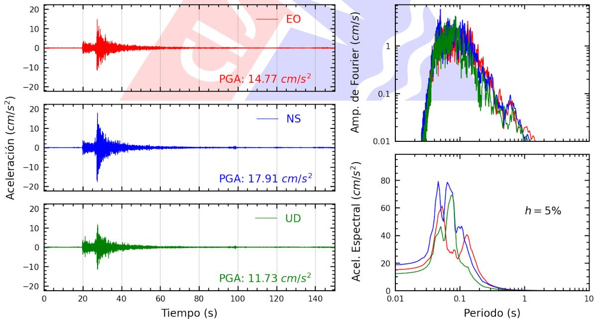
**Figura A.6:** Registros tiempo-historia, espectros de Fourier y de respuesta en las direcciones EO, NS y vertical de la estación SROS2. Sismo de Provincia Constitucional del Callao , Callao - Lima del 2025-06-16, 12:40:17 (Hora local)
