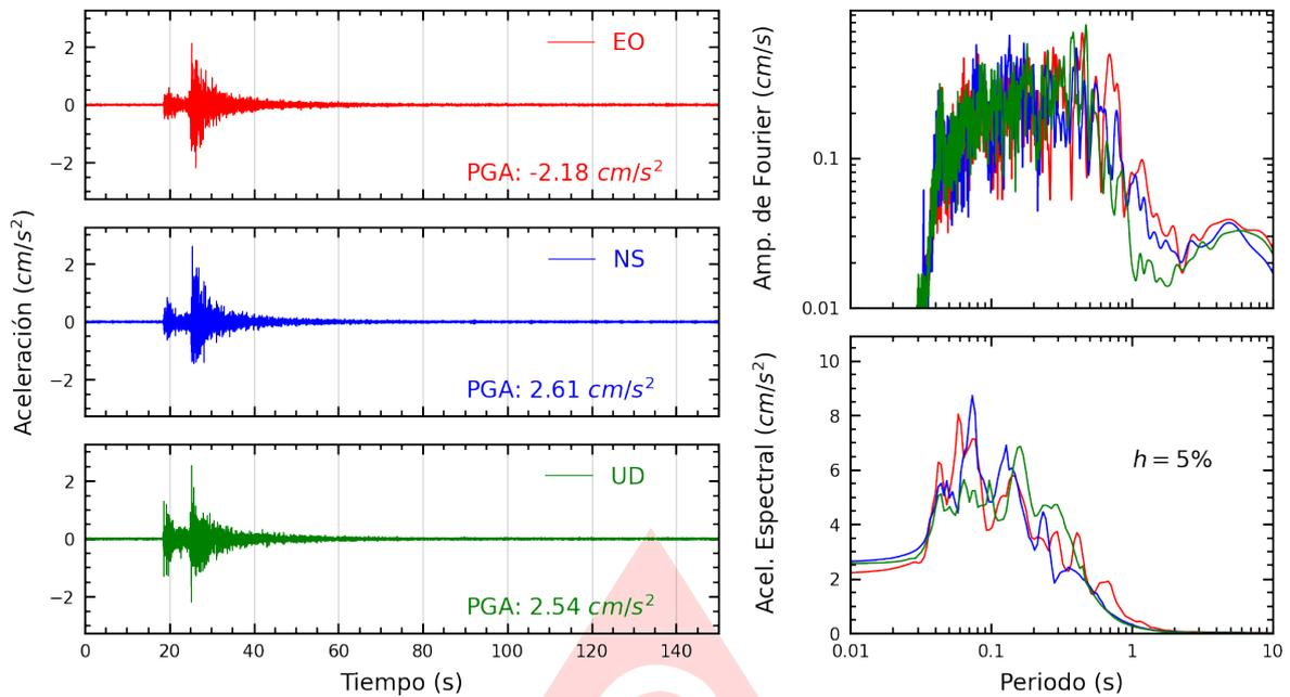
**Figura A.41:** Registros tiempo-historia, espectros de Fourier y de respuesta en las direcciones EO, NS y vertical de la estación BONDY. Sismo de Provincia Constitucional del Callao , Callao - Lima del 2025-06-16, 12:40:17 (Hora local)
