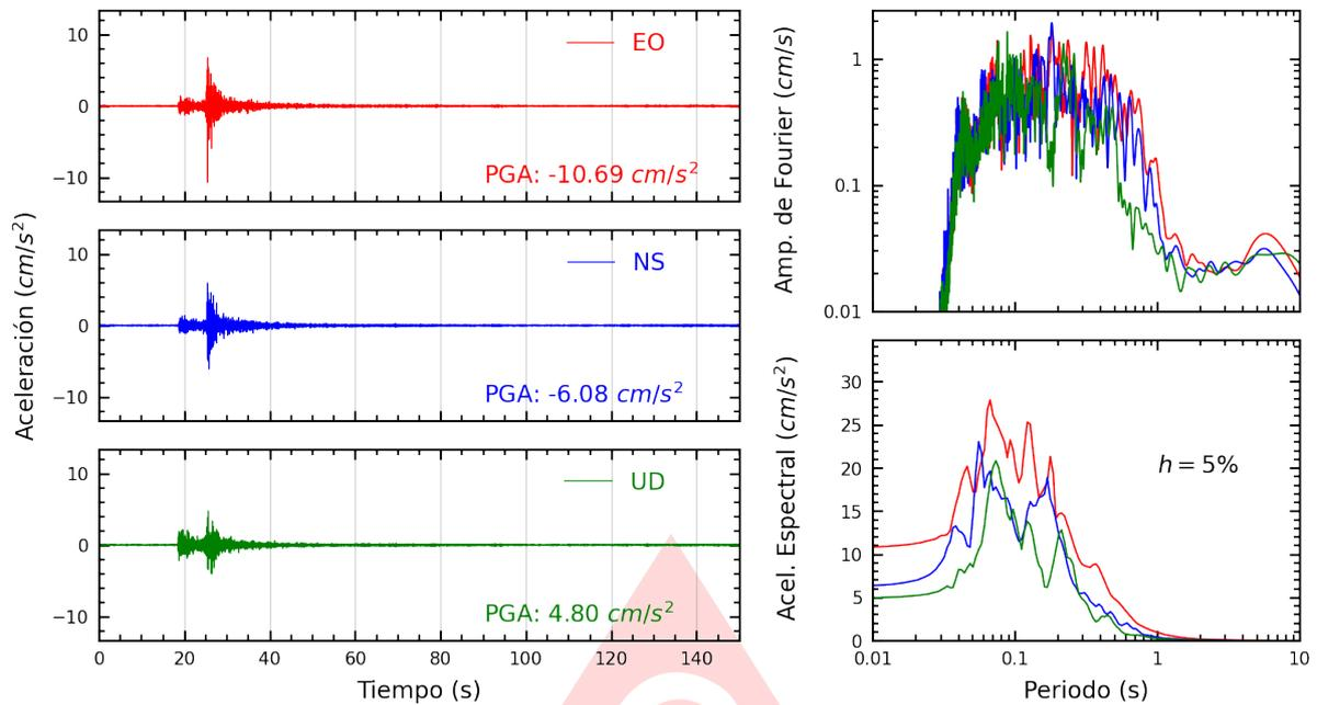
**Figura A.17:** Registros tiempo-historia, espectros de Fourier y de respuesta en las direcciones EO, NS y vertical de la estación MADRE. Sismo de Provincia Constitucional del Callao , Callao - Lima del 2025-06-16, 12:40:17 (Hora local)
