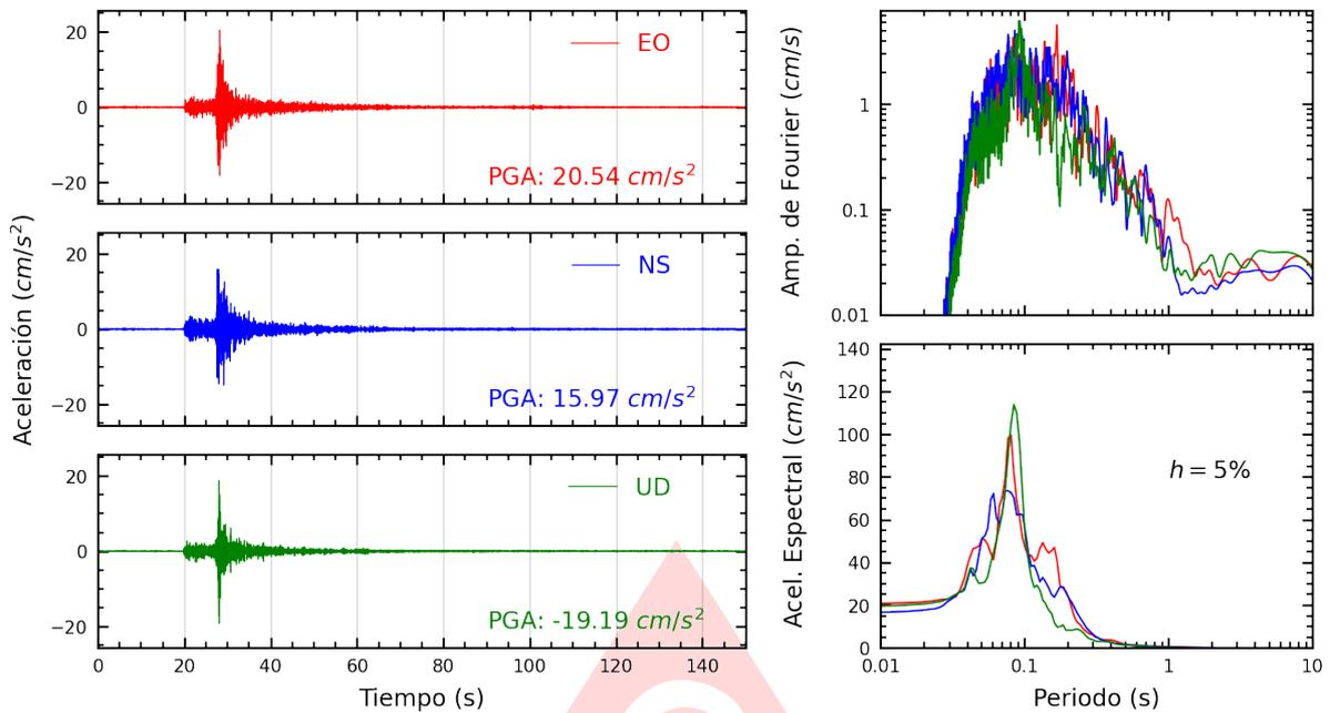
**Figura A.3:** Registros tiempo-historia, espectros de Fourier y de respuesta en las direcciones EO, NS y vertical de la estación USILM. Sismo de Provincia Constitucional del Callao , Callao - Lima del 2025-06-16, 12:40:17 (Hora local)
