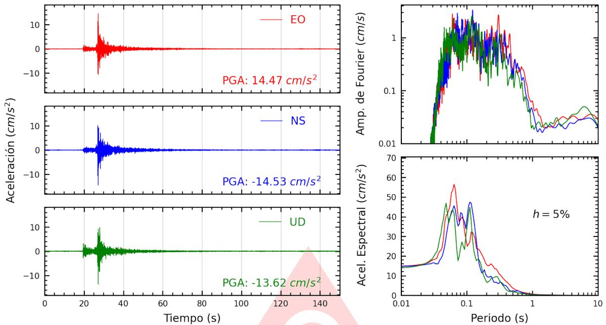
**Figura A.11:** Registros tiempo-historia, espectros de Fourier y de respuesta en las direcciones EO, NS y vertical de la estación SJLSC. Sismo de Provincia Constitucional del Callao , Callao - Lima del 2025-06-16, 12:40:17 (Hora local)
