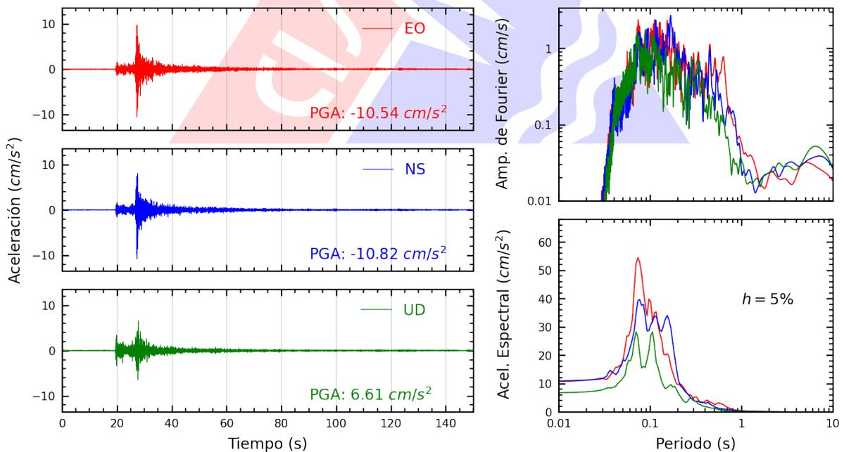
**Figura A.16:** Registros tiempo-historia, espectros de Fourier y de respuesta en las direcciones EO, NS y vertical de la estación SJLSV. Sismo de Provincia Constitucional del Callao , Callao - Lima del 2025-06-16, 12:40:17 (Hora local)
