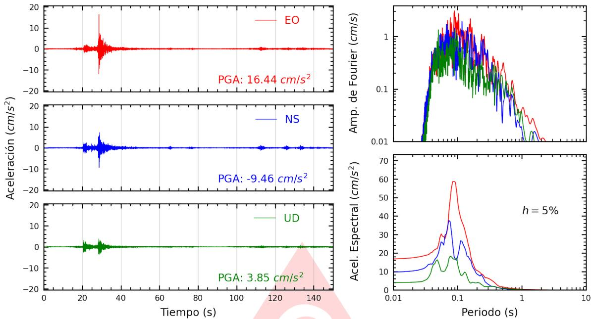
**Figura A.9:** Registros tiempo-historia, espectros de Fourier y de respuesta en las direcciones EO, NS y vertical de la estación PACHA. Sismo de Provincia Constitucional del Callao , Callao - Lima del 2025-06-16, 12:40:17 (Hora local)
