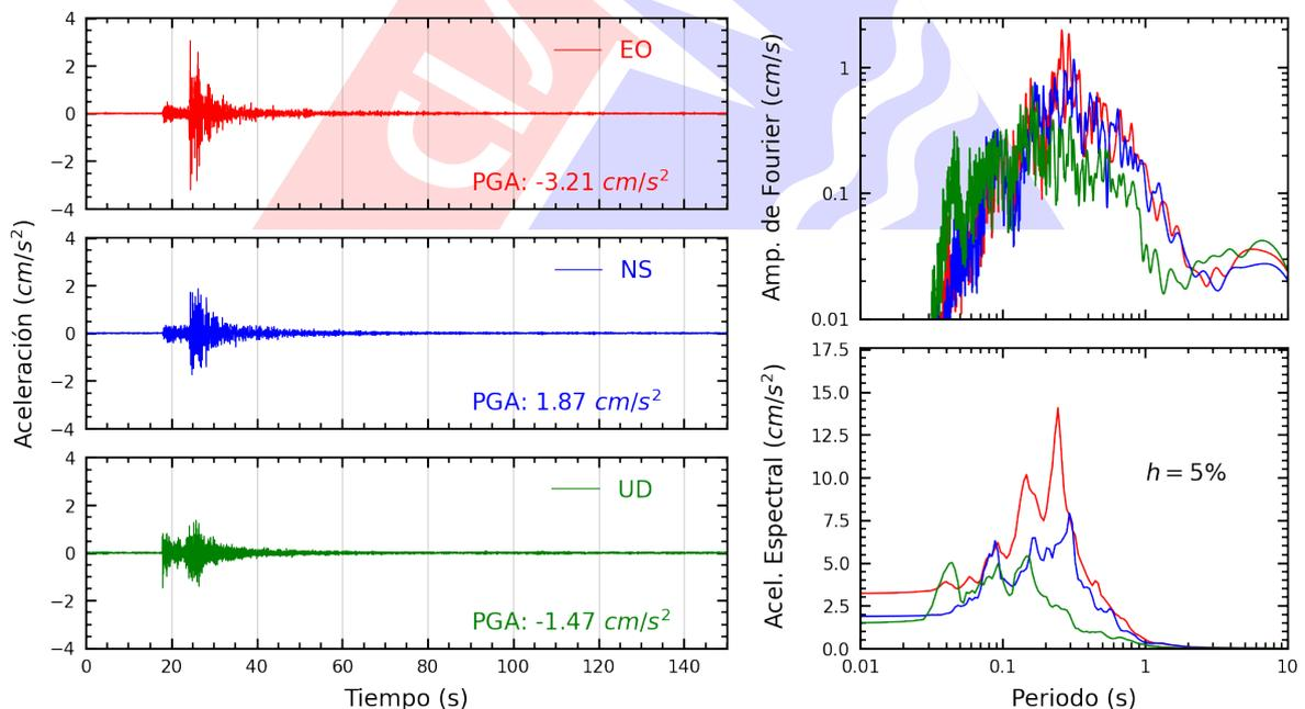
**Figura A.40:** Registros tiempo-historia, espectros de Fourier y de respuesta en las direcciones EO, NS y vertical de la estación DSMI. Sismo de Provincia Constitucional del Callao , Callao - Lima del 2025-06-16, 12:40:17 (Hora local)
