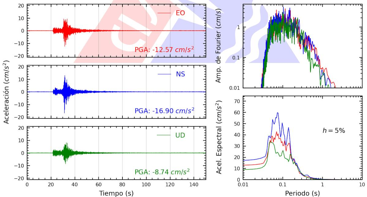
**Figura A.8:** Registros tiempo-historia, espectros de Fourier y de respuesta en las direcciones EO, NS y vertical de la estación PHER2. Sismo de Provincia Constitucional del Callao , Callao - Lima del 2025-06-16, 12:40:17 (Hora local)
