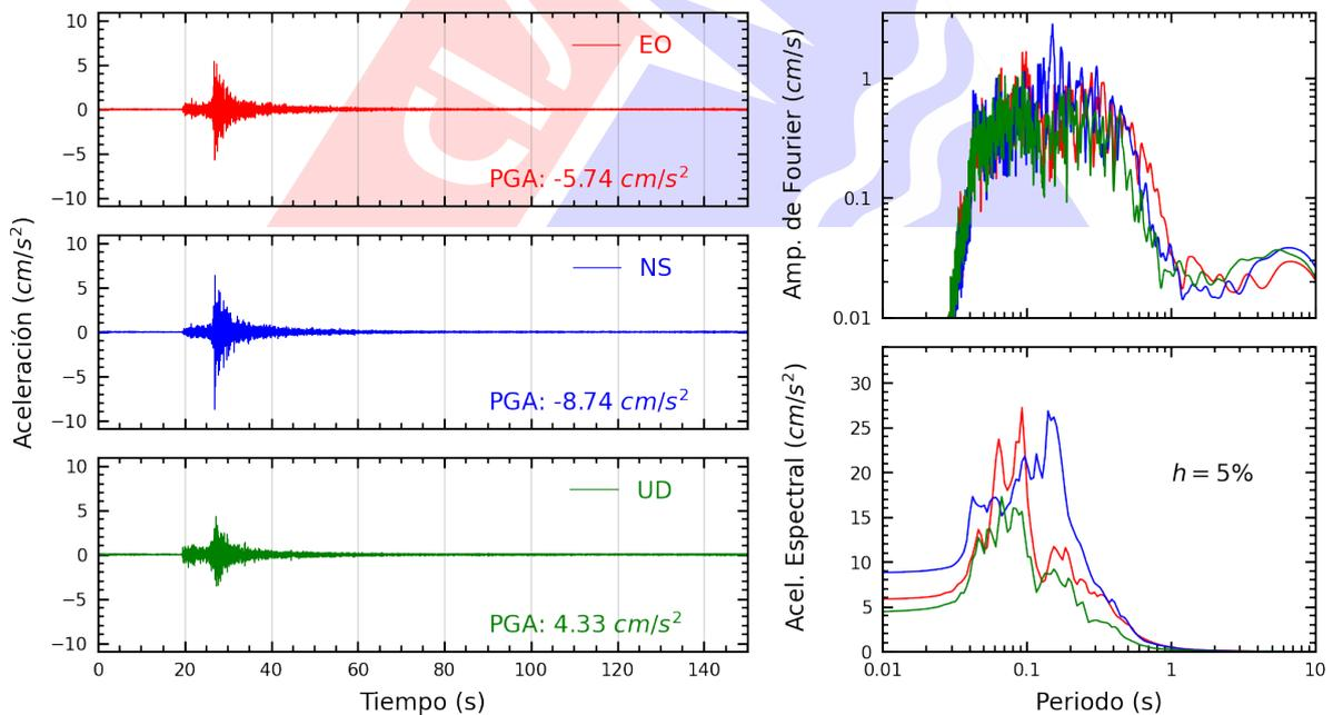
**Figura A.24:** Registros tiempo-historia, espectros de Fourier y de respuesta en las direcciones EO, NS y vertical de la estación URPE. Sismo de Provincia Constitucional del Callao , Callao - Lima del 2025-06-16, 12:40:17 (Hora local)
