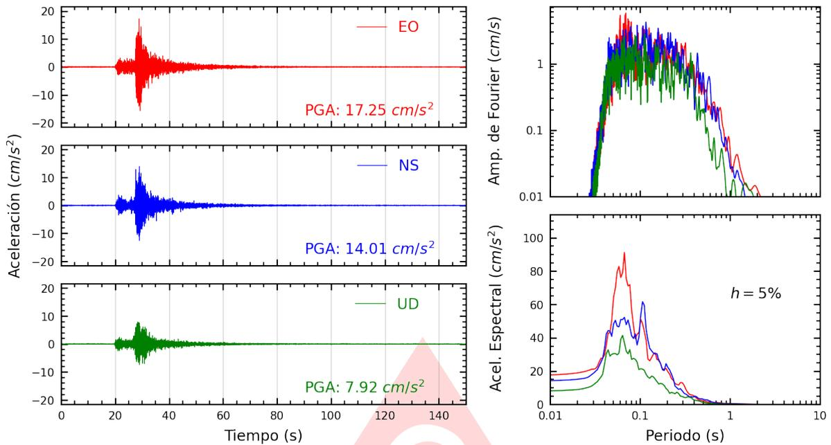
**Figura A.7:** Registros tiempo-historia, espectros de Fourier y de respuesta en las direcciones EO, NS y vertical de la estación UNTEL. Sismo de Provincia Constitucional del Callao , Callao - Lima del 2025-06-16, 12:40:17 (Hora local)
