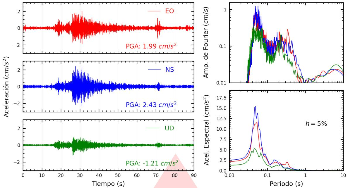
**Figura A.1:** Registros tiempo-historia, espectros de Fourier y de respuesta en las direcciones EO, NS y vertical de la estación USP. Sismo de Samanco, Santa - Ancash del 2025-06-18, 06:52:51 (Hora local)
