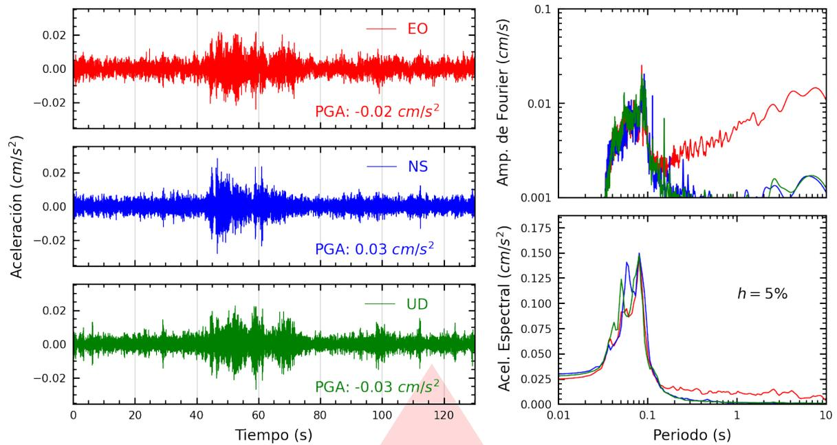
**Figura A.1:** Registros tiempo-historia, espectros de Fourier y de respuesta en las direcciones EO, NS y vertical de la estación SCCHI. Sismo de Zorritos, Contralmirante Villar - Tumbes del 2025-06-24, 12:19:30 (Hora local)
