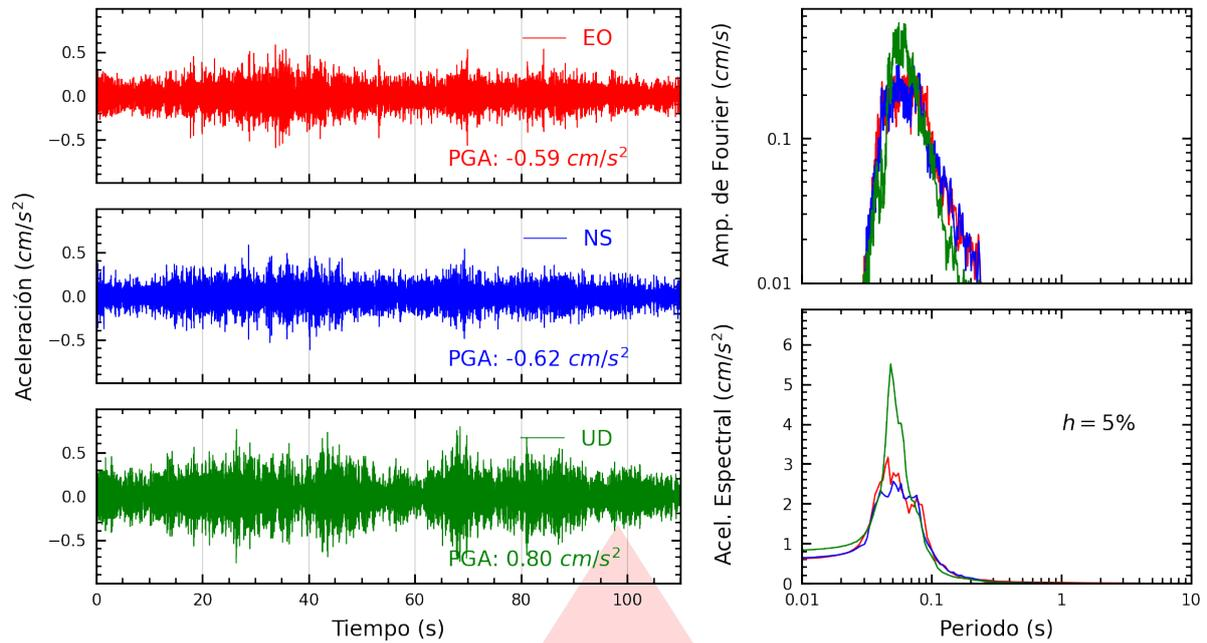
**Figura A.1:** Registros tiempo-historia, espectros de Fourier y de respuesta en las direcciones EO, NS y vertical de la estación SCAR2. Sismo de Huambo, Caylloma - Arequipa del 2025-07-02, 10:47:42 (Hora local)
