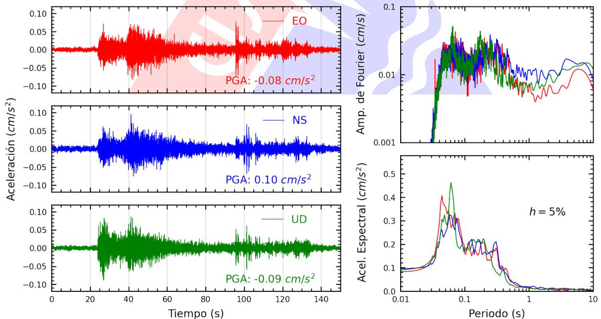
**Figura A.4:** Registros tiempo-historia, espectros de Fourier y de respuesta en las direcciones EO, NS y vertical de la estación CREY. Sismo de Ilo, Ilo - Moquegua del 2025-07-09, 03:45:12 (Hora local)
