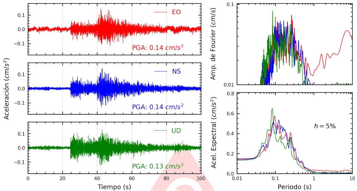
**Figura A.3:** Registros tiempo-historia, espectros de Fourier y de respuesta en las direcciones EO, NS y vertical de la estación UJBG3. Sismo de Ilo, Ilo - Moquegua del 2025-07-09, 03:45:12 (Hora local)
