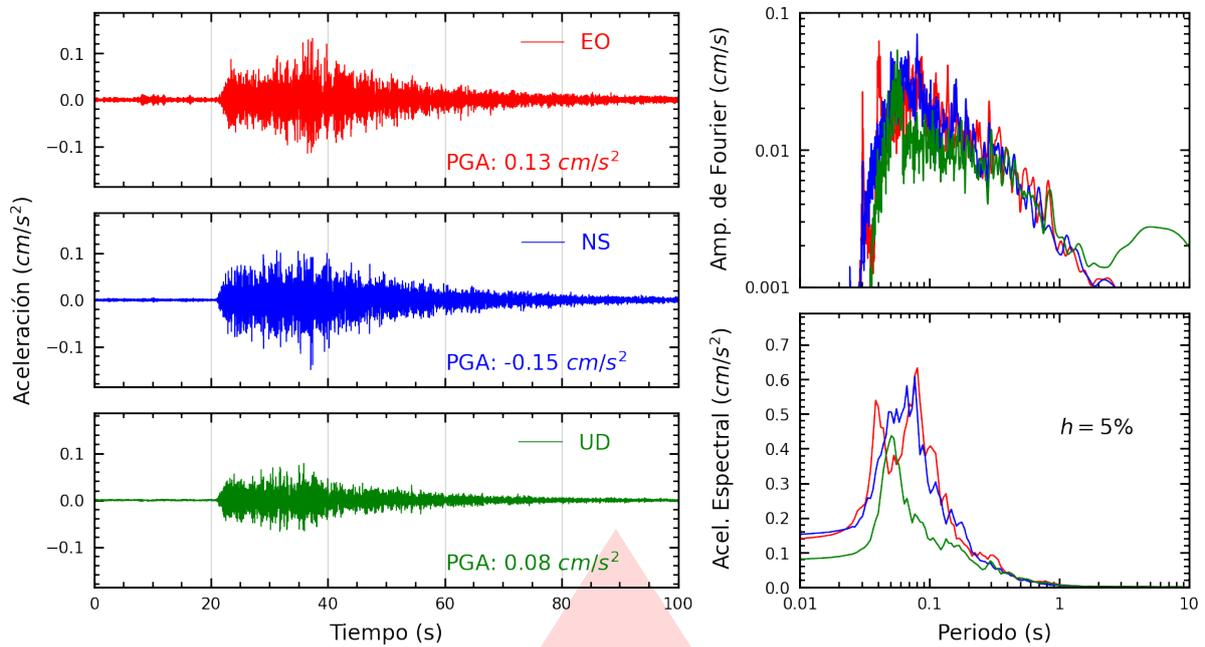
**Figura A.1:** Registros tiempo-historia, espectros de Fourier y de respuesta en las direcciones EO, NS y vertical de la estación UNAM. Sismo de Ilo, Ilo - Moquegua del 2025-07-09, 03:45:12 (Hora local)
