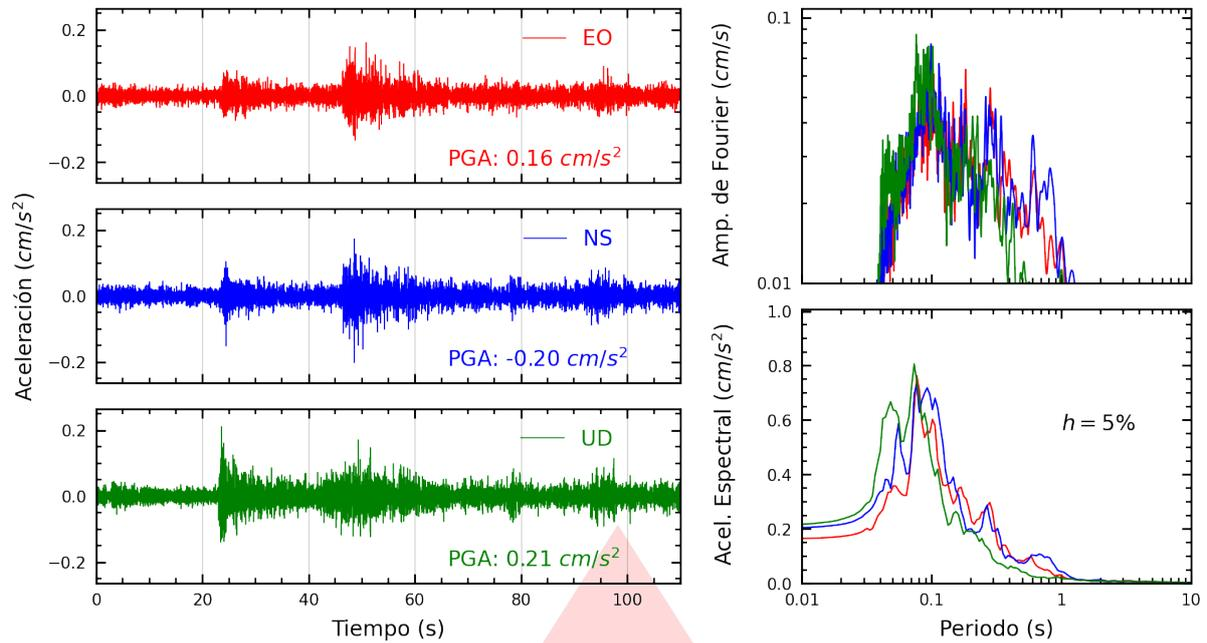
**Figura A.1:** Registros tiempo-historia, espectros de Fourier y de respuesta en las direcciones EO, NS y vertical de la estación UNICA. Sismo de Acari, Caraveli - Arequipa del 2025-07-12, 22:29:39 (Hora local)
