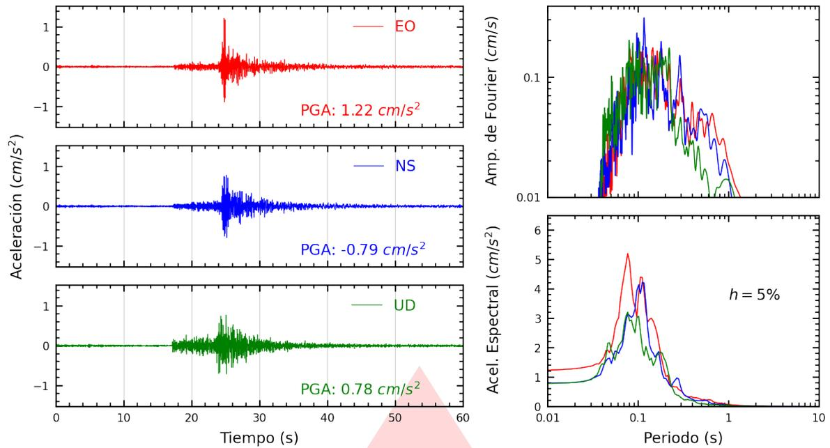
**Figura A.1:** Registros tiempo-historia, espectros de Fourier y de respuesta en las direcciones EO, NS y vertical de la estación UNICA. Sismo de Ica, Ica - Ica del 2025-07-18, 23:05:47 (Hora local)
