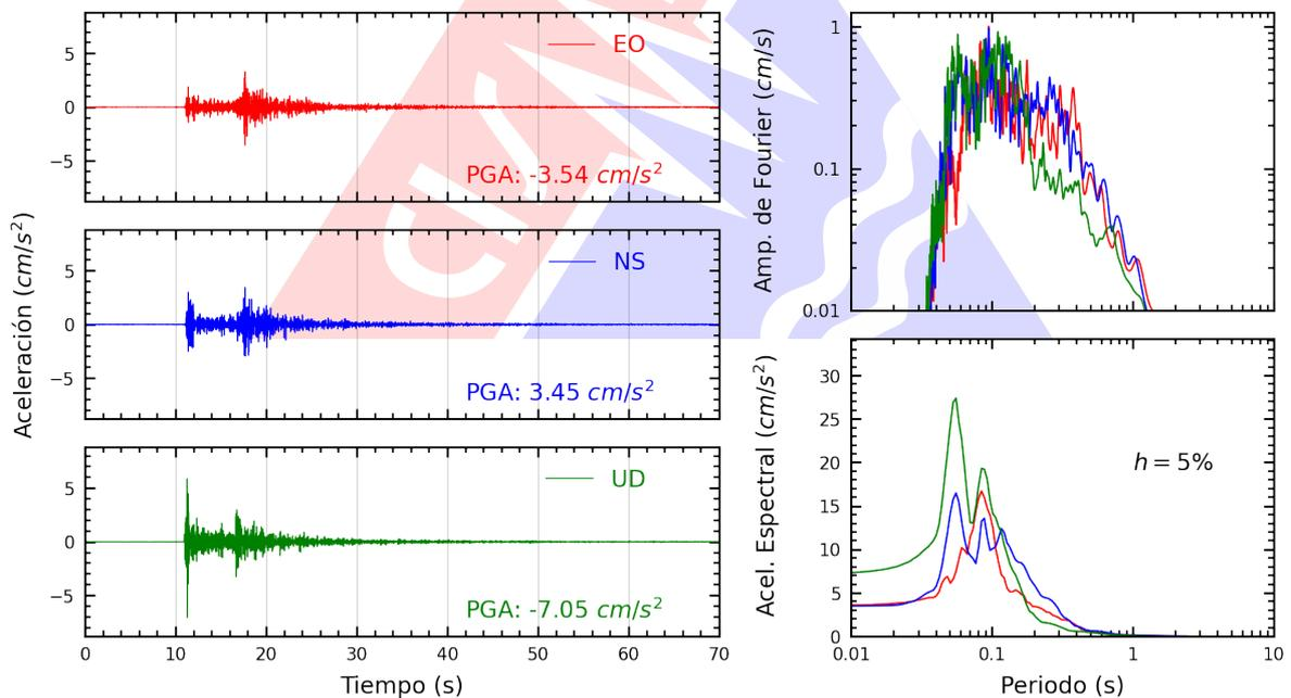
**Figura A.2:** Registros tiempo-historia, espectros de Fourier y de respuesta en las direcciones EO, NS y vertical de la estación UPAOP. Sismo de Sullana, Sullana - Piura del 2025-07-20, 07:56:52 (Hora local)
