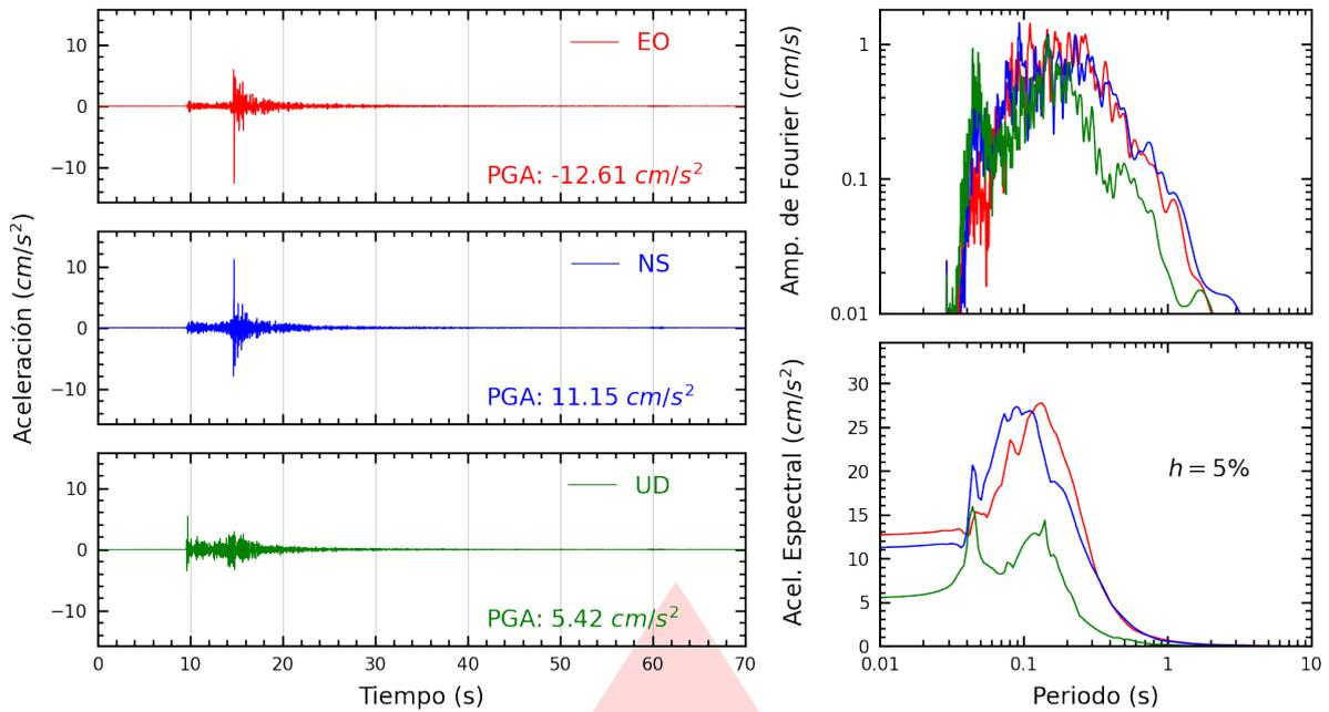
**Figura A.1:** Registros tiempo-historia, espectros de Fourier y de respuesta en las direcciones EO, NS y vertical de la estación UNF. Sismo de Sullana, Sullana - Piura del 2025-07-20, 07:56:52 (Hora local)
