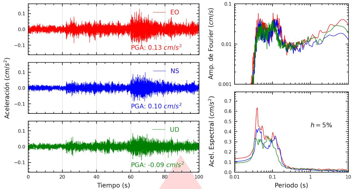
**Figura A.1:** Registros tiempo-historia, espectros de Fourier y de respuesta en las direcciones EO, NS y vertical de la estación AMORE. Sismo de Chimbote, Santa - Ancash del 2025-07-21, 17:00:08 (Hora local)
