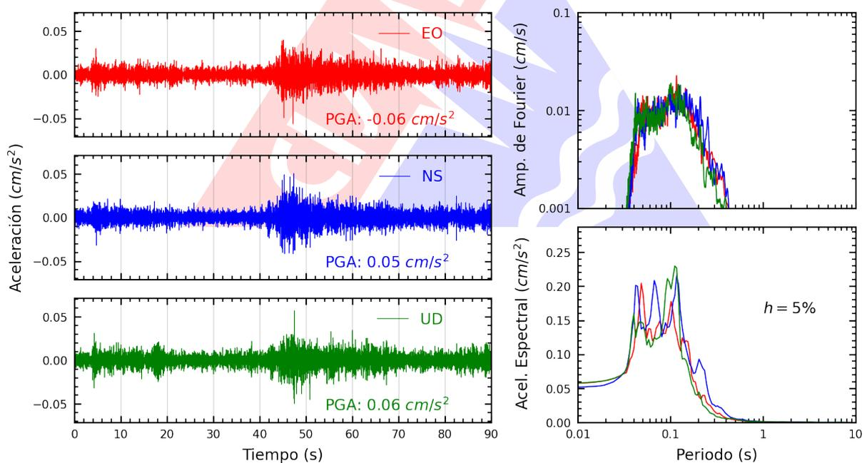
**Figura A.2:** Registros tiempo-historia, espectros de Fourier y de respuesta en las direcciones EO, NS y vertical de la estación JALV2. Sismo de Chimbote, Santa - Ancash del 2025-07-21, 17:00:08 (Hora local)
