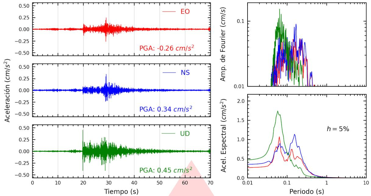
**Figura A.1:** Registros tiempo-historia, espectros de Fourier y de respuesta en las direcciones EO, NS y vertical de la estación UNAAA. Sismo de Yurimaguas, Alto Amazonas - Loreto del 2025-07-23, 00:35:26 (Hora local)
