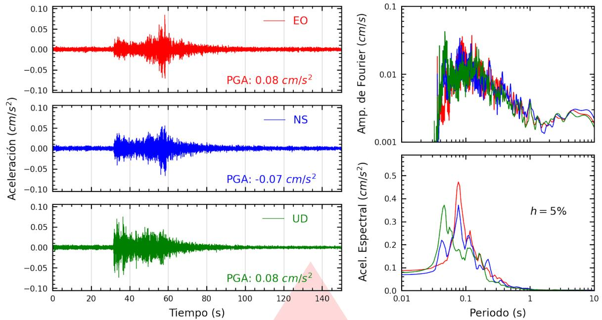
**Figura A.1:** Registros tiempo-historia, espectros de Fourier y de respuesta en las direcciones EO, NS y vertical de la estación UNF. Sismo de Tumbes, Tumbes - Tumbes del 2025-07-27, 20:27:38 (Hora local)
