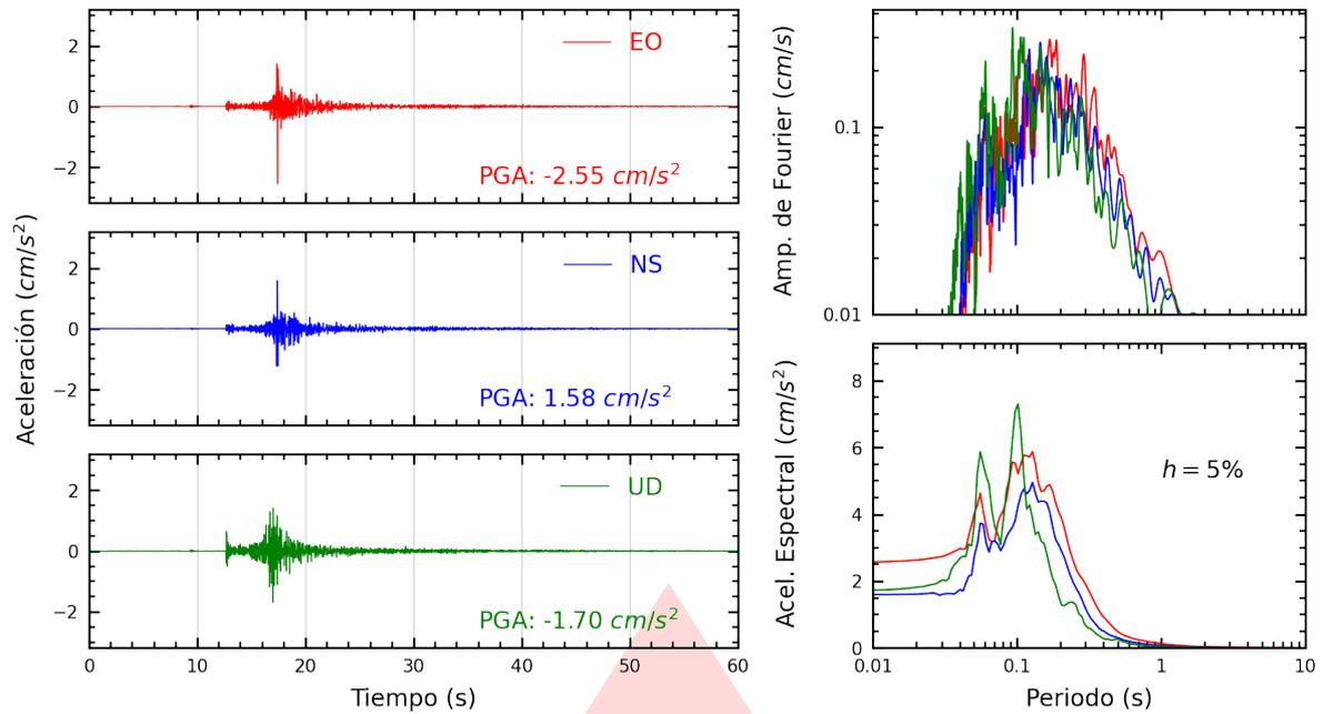
**Figura A.1:** Registros tiempo-historia, espectros de Fourier y de respuesta en las direcciones EO, NS y vertical de la estación UNJ. Sismo de Bagua Grande, Utcubamba - Amazonas del 2025-06-03, 19:19:16 (Hora local)
