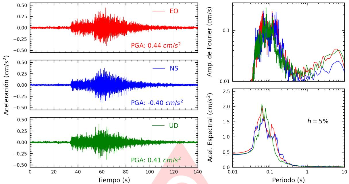
**Figura A.11:** Registros tiempo-historia, espectros de Fourier y de respuesta en las direcciones EO, NS y vertical de la estación AMORE. Sismo de Barranca, Barranca - Lima del 2025-08-03, 17:21:43 (Hora local)
