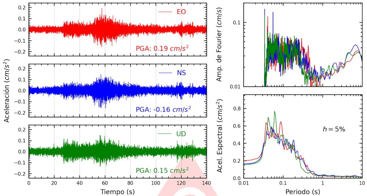
**Figura A.19:** Registros tiempo-historia, espectros de Fourier y de respuesta en las direcciones EO, NS y vertical de la estación USMP. Sismo de Barranca, Barranca - Lima del 2025-08-03, 17:21:43 (Hora local)
