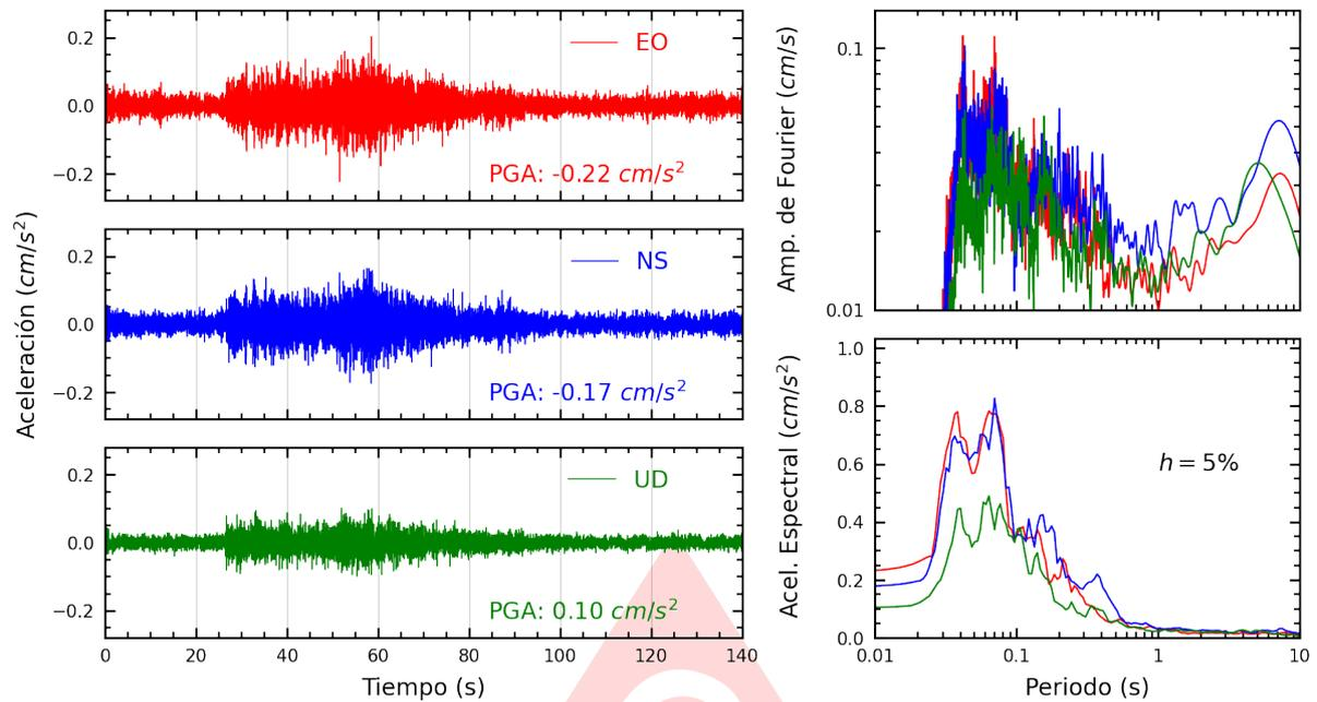
**Figura A.17:** Registros tiempo-historia, espectros de Fourier y de respuesta en las direcciones EO, NS y vertical de la estación CEPRE. Sismo de Barranca, Barranca - Lima del 2025-08-03, 17:21:43 (Hora local)
