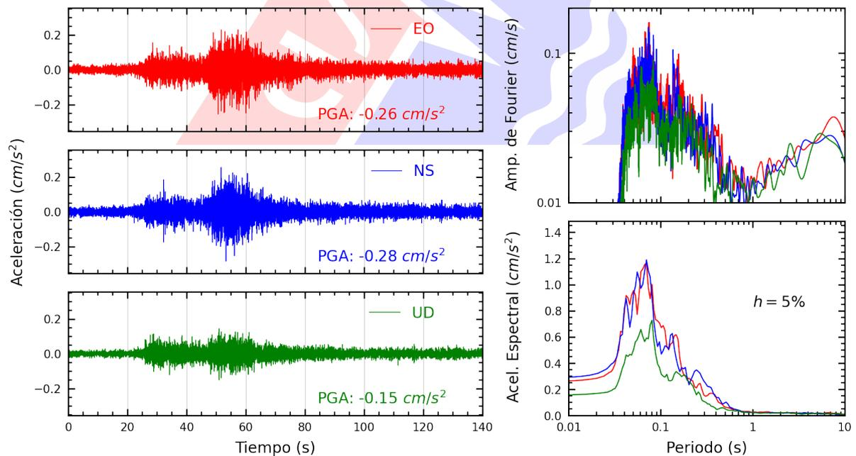
**Figura A.14:** Registros tiempo-historia, espectros de Fourier y de respuesta en las direcciones EO, NS y vertical de la estación FICPE. Sismo de Barranca, Barranca - Lima del 2025-08-03, 17:21:43 (Hora local)
