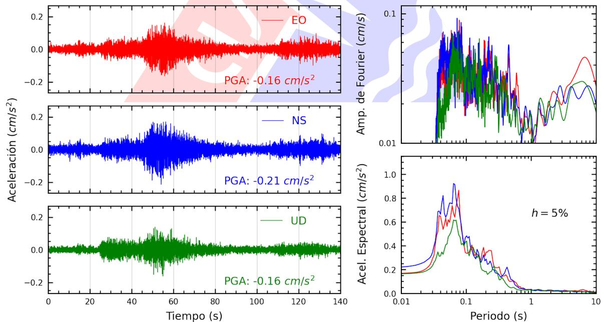
**Figura A.18:** Registros tiempo-historia, espectros de Fourier y de respuesta en las direcciones EO, NS y vertical de la estación COMAS. Sismo de Barranca, Barranca - Lima del 2025-08-03, 17:21:43 (Hora local)
