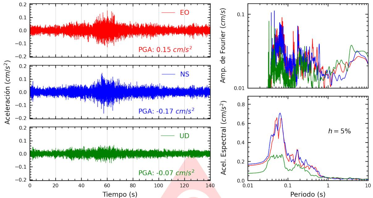
**Figura A.21:** Registros tiempo-historia, espectros de Fourier y de respuesta en las direcciones EO, NS y vertical de la estación UPCVI. Sismo de Barranca, Barranca - Lima del 2025-08-03, 17:21:43 (Hora local)
