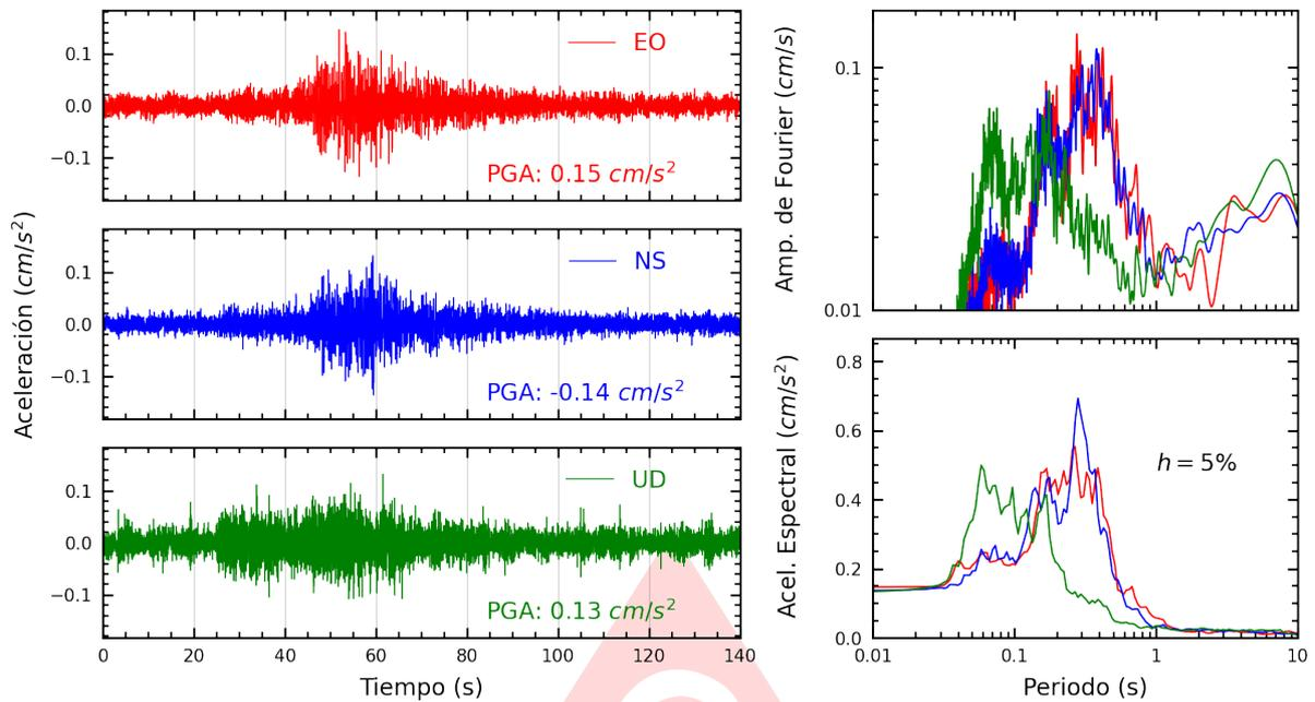
**Figura A.25:** Registros tiempo-historia, espectros de Fourier y de respuesta en las direcciones EO, NS y vertical de la estación ACAPU. Sismo de Barranca, Barranca - Lima del 2025-08-03, 17:21:43 (Hora local)
