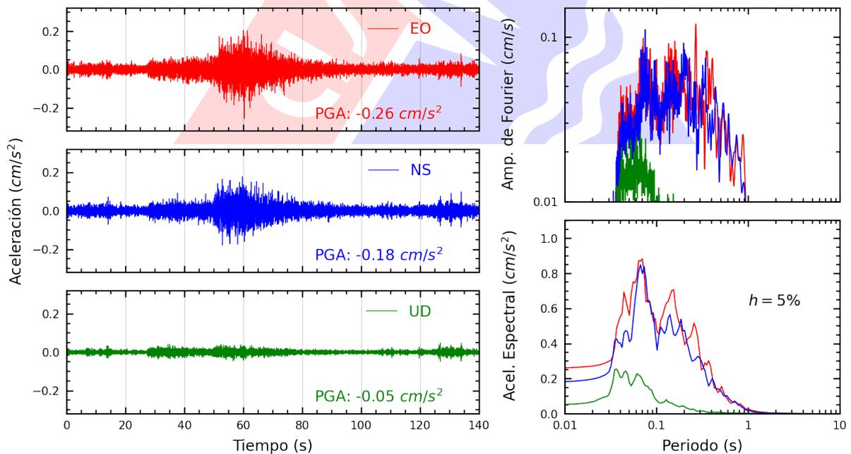
**Figura A.16:** Registros tiempo-historia, espectros de Fourier y de respuesta en las direcciones EO, NS y vertical de la estación UCVAT. Sismo de Barranca, Barranca - Lima del 2025-08-03, 17:21:43 (Hora local)
