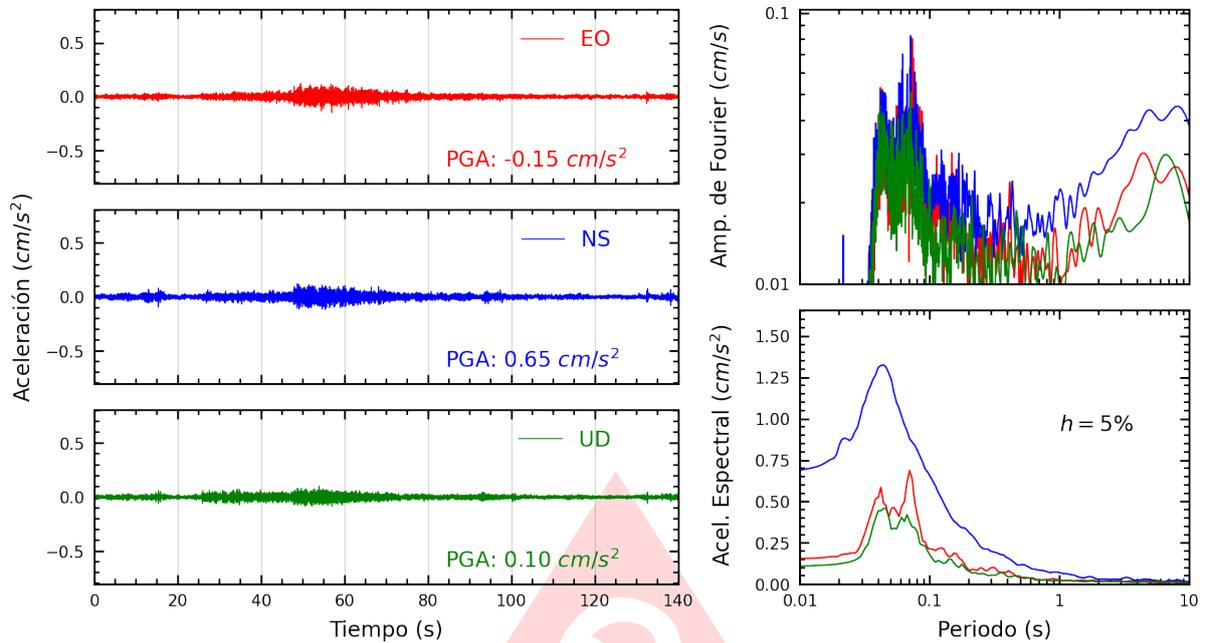
**Figura A.7:** Registros tiempo-historia, espectros de Fourier y de respuesta en las direcciones EO, NS y vertical de la estación SJLCE. Sismo de Barranca, Barranca - Lima del 2025-08-03, 17:21:43 (Hora local)
