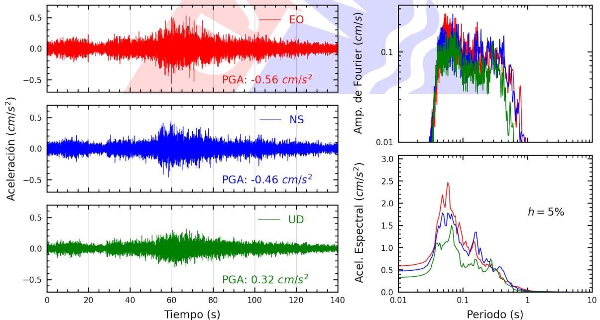
**Figura A.8:** Registros tiempo-historia, espectros de Fourier y de respuesta en las direcciones EO, NS y vertical de la estación UNTEL. Sismo de Barranca, Barranca - Lima del 2025-08-03, 17:21:43 (Hora local)
