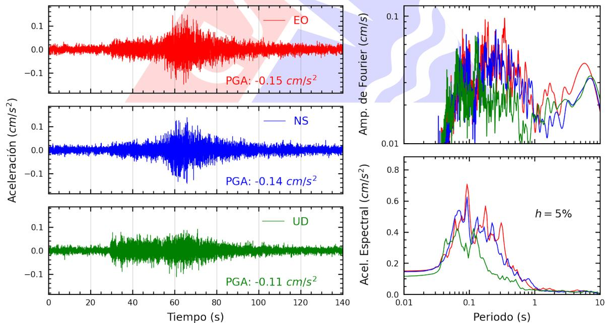
**Figura A.24:** Registros tiempo-historia, espectros de Fourier y de respuesta en las direcciones EO, NS y vertical de la estación USILP. Sismo de Barranca, Barranca - Lima del 2025-08-03, 17:21:43 (Hora local)
