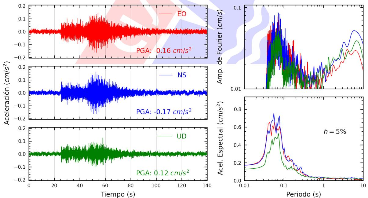
**Figura A.20:** Registros tiempo-historia, espectros de Fourier y de respuesta en las direcciones EO, NS y vertical de la estación UCSS. Sismo de Barranca, Barranca - Lima del 2025-08-03, 17:21:43 (Hora local)
