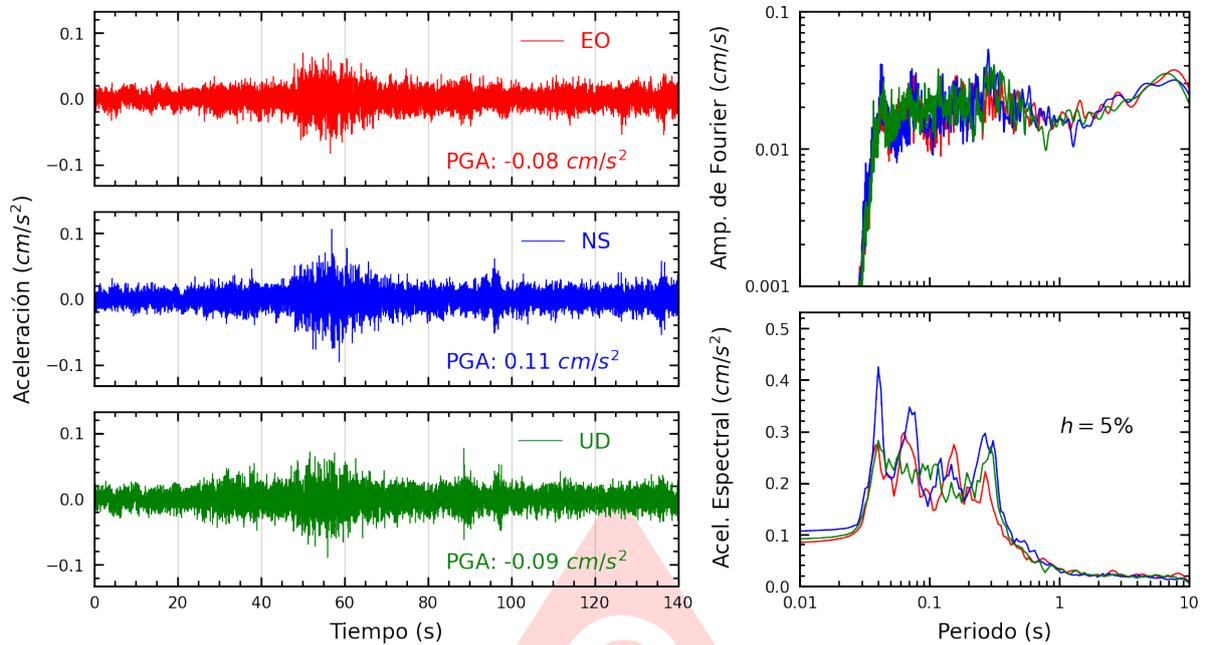
**Figura A.27:** Registros tiempo-historia, espectros de Fourier y de respuesta en las direcciones EO, NS y vertical de la estación BONDY. Sismo de Barranca, Barranca - Lima del 2025-08-03, 17:21:43 (Hora local)
