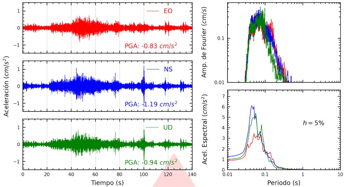
**Figura A.1:** Registros tiempo-historia, espectros de Fourier y de respuesta en las direcciones EO, NS y vertical de la estación SROSA. Sismo de Barranca, Barranca - Lima del 2025-08-03, 17:21:43 (Hora local)
