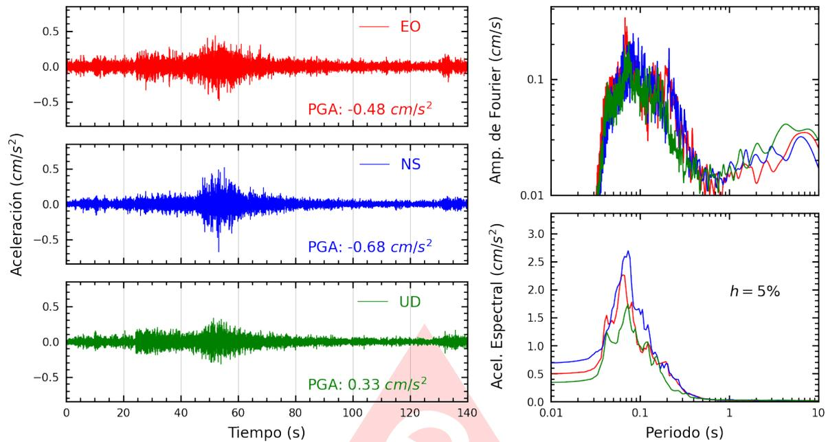
**Figura A.5:** Registros tiempo-historia, espectros de Fourier y de respuesta en las direcciones EO, NS y vertical de la estación INDEP. Sismo de Barranca, Barranca - Lima del 2025-08-03, 17:21:43 (Hora local)
