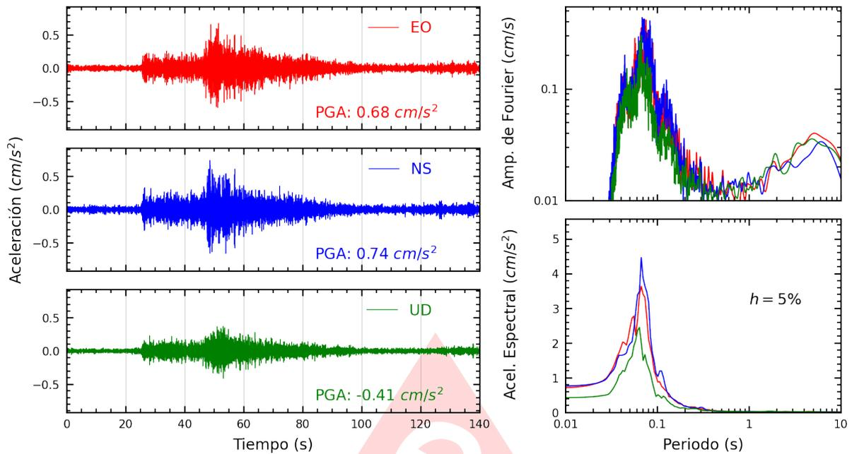
**Figura A.3:** Registros tiempo-historia, espectros de Fourier y de respuesta en las direcciones EO, NS y vertical de la estación JOSEO. Sismo de Barranca, Barranca - Lima del 2025-08-03, 17:21:43 (Hora local)
