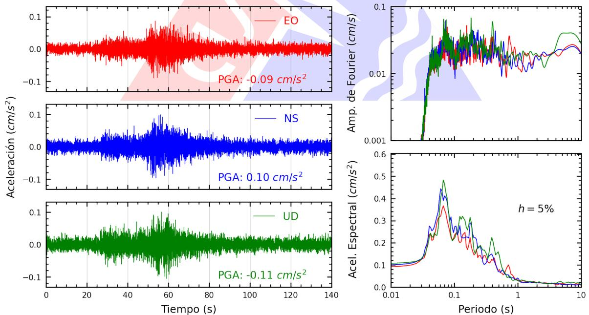
**Figura A.28:** Registros tiempo-historia, espectros de Fourier y de respuesta en las direcciones EO, NS y vertical de la estación UNFV. Sismo de Barranca, Barranca - Lima del 2025-08-03, 17:21:43 (Hora local)
