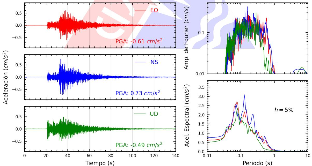
**Figura A.4:** Registros tiempo-historia, espectros de Fourier y de respuesta en las direcciones EO, NS y vertical de la estación CARAL. Sismo de Barranca, Barranca - Lima del 2025-08-03, 17:21:43 (Hora local)
