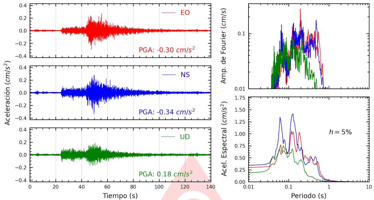
**Figura A.13:** Registros tiempo-historia, espectros de Fourier y de respuesta en las direcciones EO, NS y vertical de la estación VHAYA. Sismo de Barranca, Barranca - Lima del 2025-08-03, 17:21:43 (Hora local)
