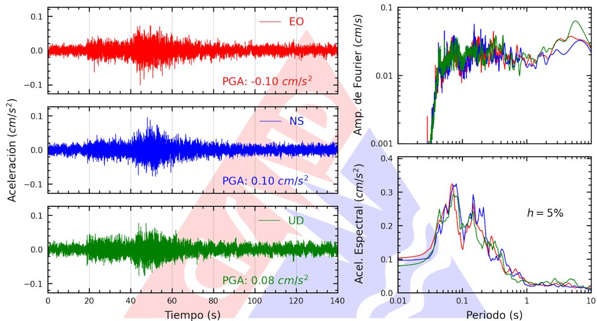
**Figura A.29:** Registros tiempo-historia, espectros de Fourier y de respuesta en las direcciones EO, NS y vertical de la estación UNMSM. Sismo de Barranca, Barranca - Lima del 2025-08-03, 17:21:43 (Hora local)
