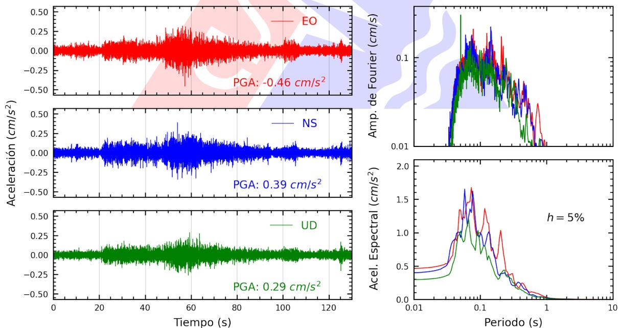
**Figura A.10:** Registros tiempo-historia, espectros de Fourier y de respuesta en las direcciones EO, NS y vertical de la estación PHERM. Sismo de Barranca, Barranca - Lima del 2025-08-03, 17:21:43 (Hora local)
