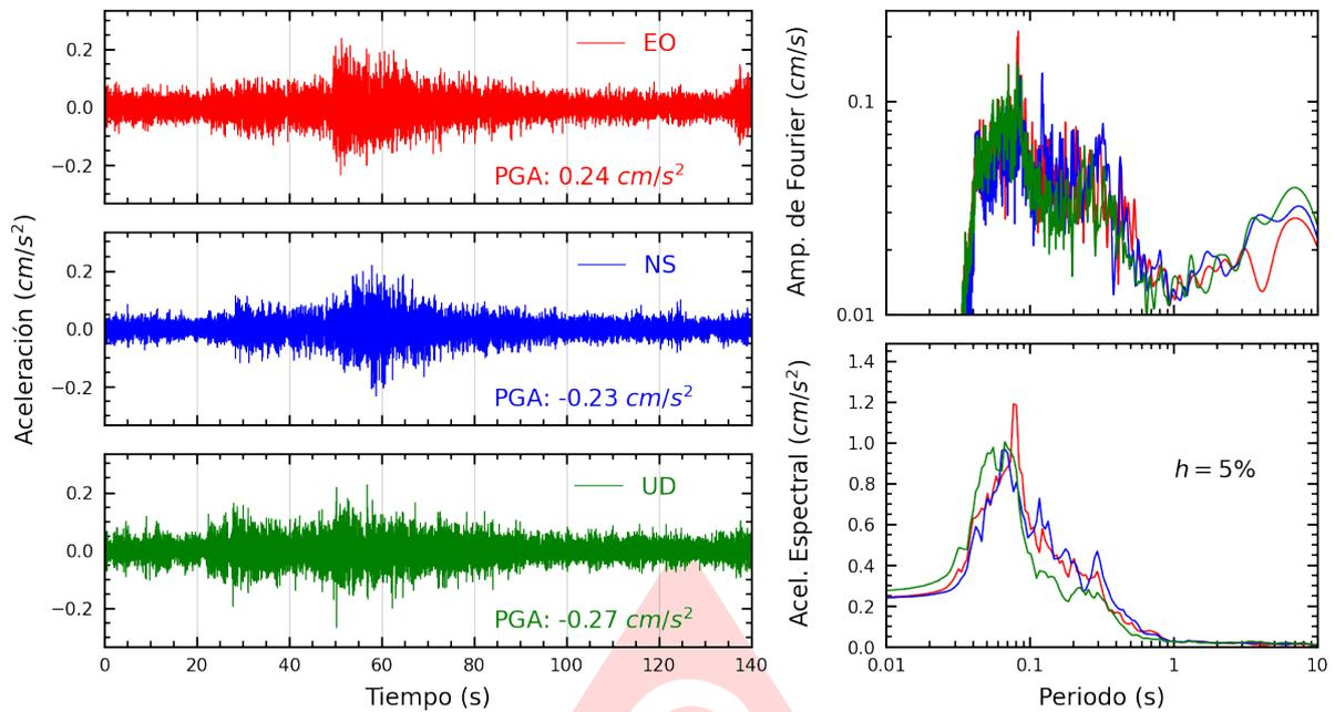
**Figura A.15:** Registros tiempo-historia, espectros de Fourier y de respuesta en las direcciones EO, NS y vertical de la estación URPE. Sismo de Barranca, Barranca - Lima del 2025-08-03, 17:21:43 (Hora local)
