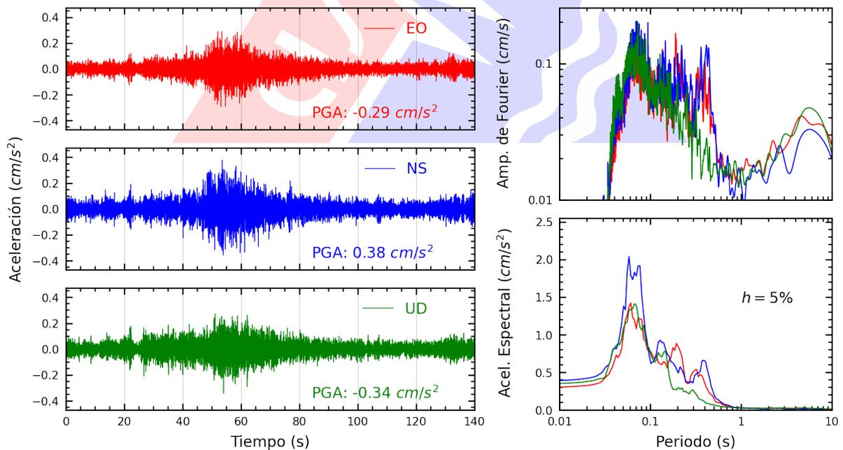
**Figura A.12:** Registros tiempo-historia, espectros de Fourier y de respuesta en las direcciones EO, NS y vertical de la estación SJLSC. Sismo de Barranca, Barranca - Lima del 2025-08-03, 17:21:43 (Hora local)
