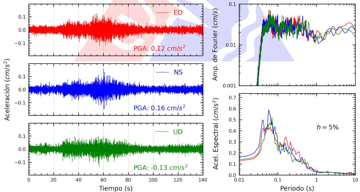
**Figura A.22:** Registros tiempo-historia, espectros de Fourier y de respuesta en las direcciones EO, NS y vertical de la estación IMCA. Sismo de Barranca, Barranca - Lima del 2025-08-03, 17:21:43 (Hora local)
