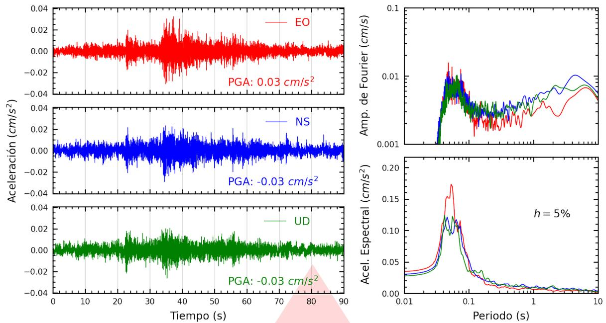
**Figura A.1:** Registros tiempo-historia, espectros de Fourier y de respuesta en las direcciones EO, NS y vertical de la estación CREY. Sismo de Toquepala, Jorge Basadre - Tacna del 2025-08-10, 03:25:45 (Hora local)
