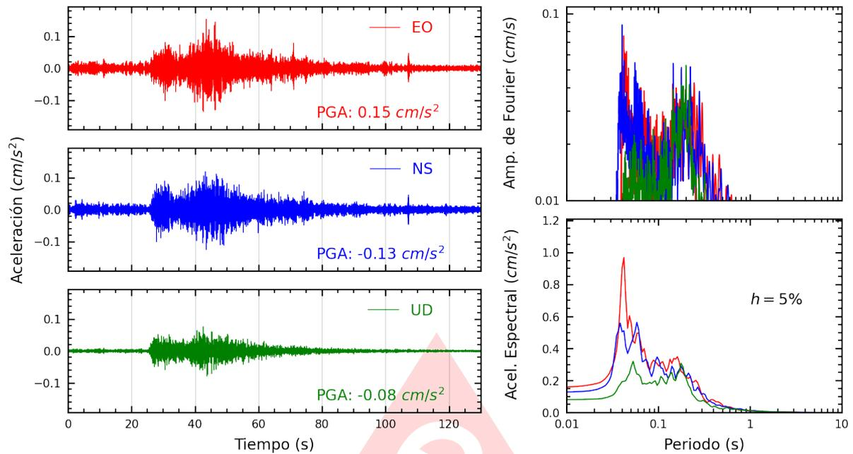
**Figura A.5:** Registros tiempo-historia, espectros de Fourier y de respuesta en las direcciones EO, NS y vertical de la estación UPTAC. Sismo de Ilo, Ilo - Moquegua del 2025-08-13, 03:03:05 (Hora local)
