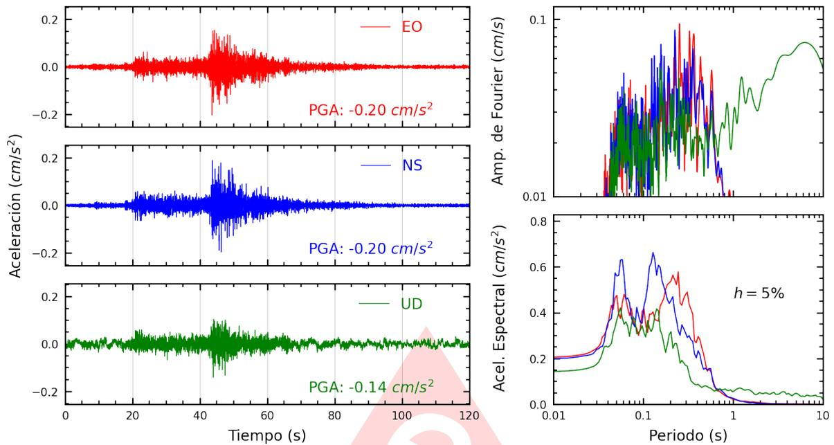
**Figura A.3:** Registros tiempo-historia, espectros de Fourier y de respuesta en las direcciones EO, NS y vertical de la estación SCARQ. Sismo de Ilo, Ilo - Moquegua del 2025-08-13, 03:03:05 (Hora local)
