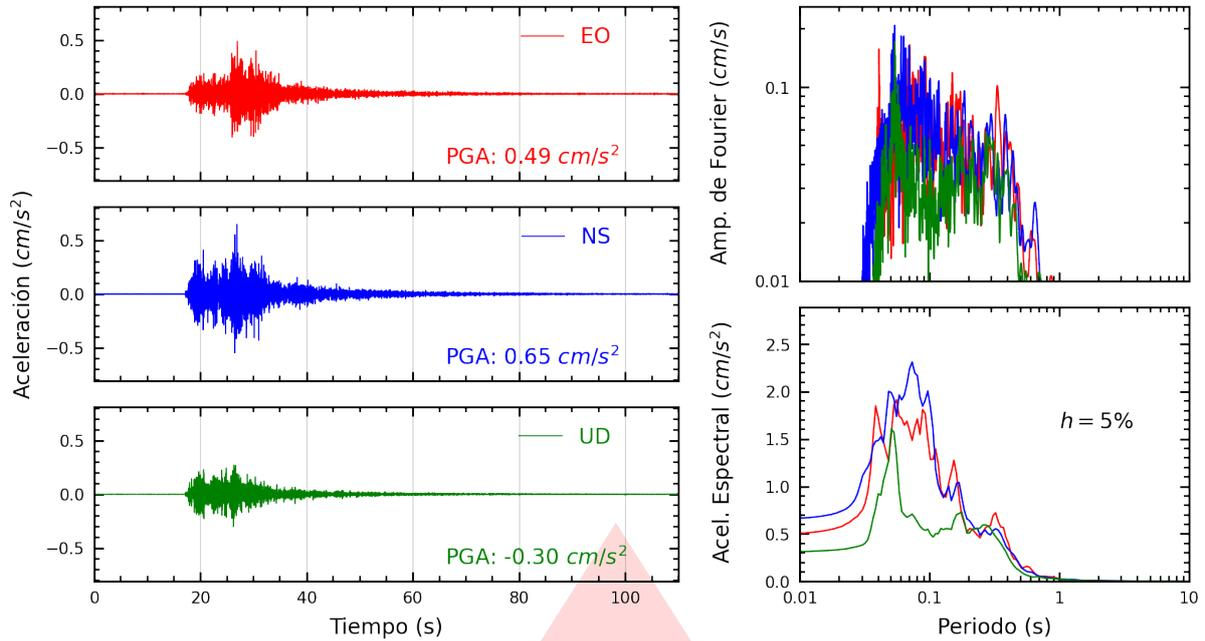
**Figura A.1:** Registros tiempo-historia, espectros de Fourier y de respuesta en las direcciones EO, NS y vertical de la estación UNAM. Sismo de Ilo, Ilo - Moquegua del 2025-08-13, 03:03:05 (Hora local)
