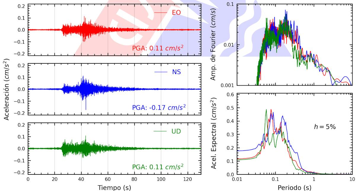
**Figura A.4:** Registros tiempo-historia, espectros de Fourier y de respuesta en las direcciones EO, NS y vertical de la estación UJBG2. Sismo de Ilo, Ilo - Moquegua del 2025-08-13, 03:03:05 (Hora local)
