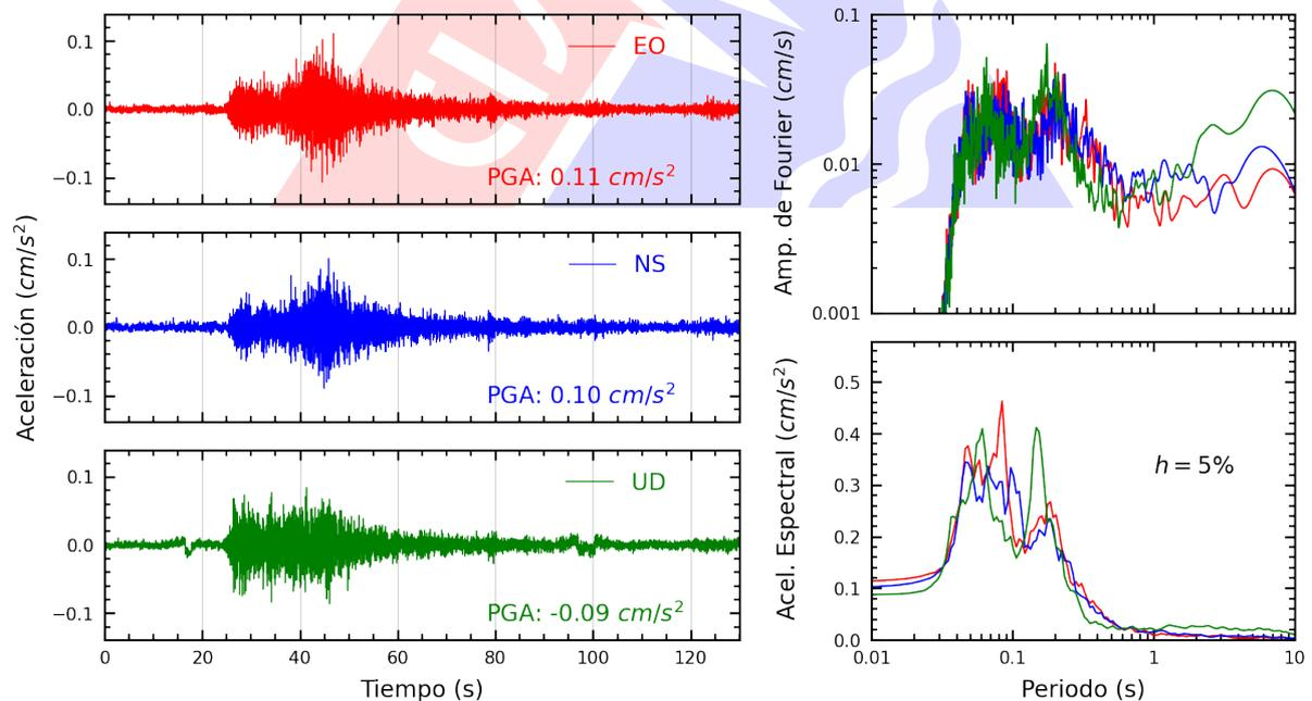
**Figura A.6:** Registros tiempo-historia, espectros de Fourier y de respuesta en las direcciones EO, NS y vertical de la estación CREY. Sismo de Ilo, Ilo - Moquegua del 2025-08-13, 03:03:05 (Hora local)
