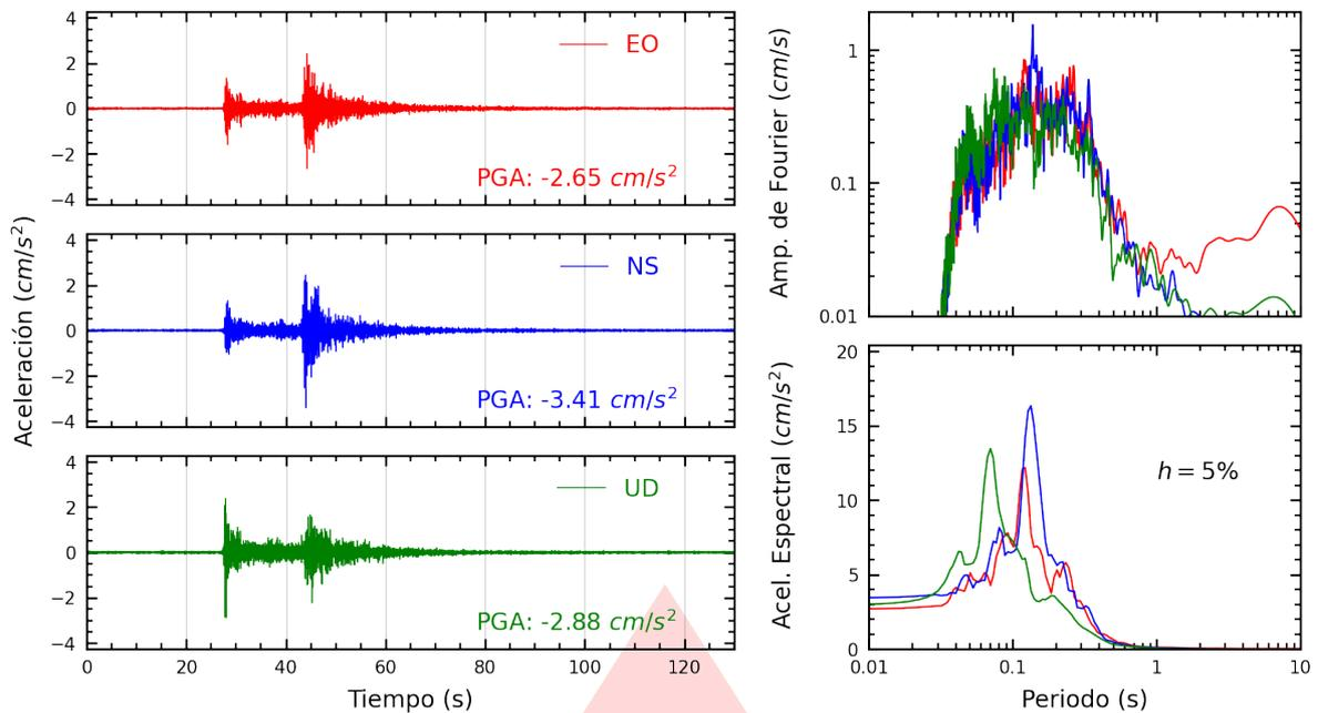
**Figura A.1:** Registros tiempo-historia, espectros de Fourier y de respuesta en las direcciones EO, NS y vertical de la estación UJBG3. Sismo de Calana, Tacna - Tacna del 2025-08-15, 15:29:15 (Hora local)
