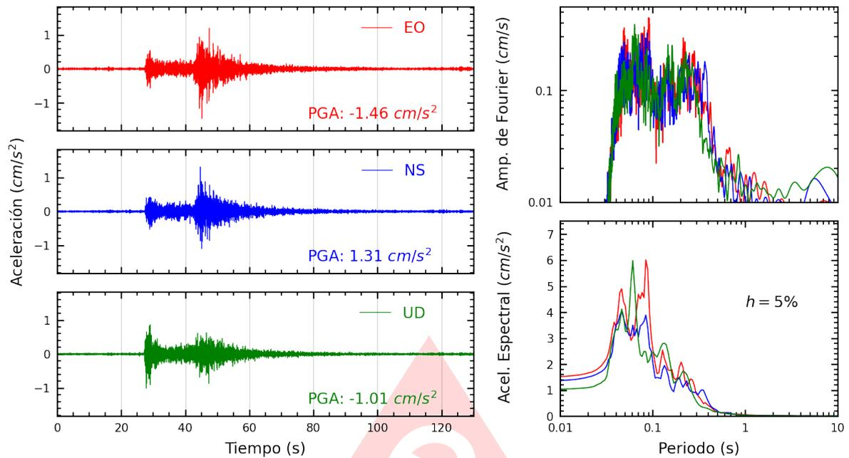
**Figura A.3:** Registros tiempo-historia, espectros de Fourier y de respuesta en las direcciones EO, NS y vertical de la estación CREY. Sismo de Calana, Tacna - Tacna del 2025-08-15, 15:29:15 (Hora local)
