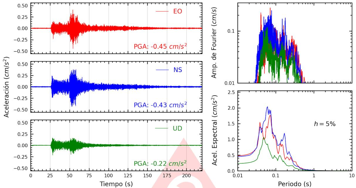
**Figura A.5:** Registros tiempo-historia, espectros de Fourier y de respuesta en las direcciones EO, NS y vertical de la estación UNAM. Sismo de Calana, Tacna - Tacna del 2025-08-15, 15:29:15 (Hora local)
