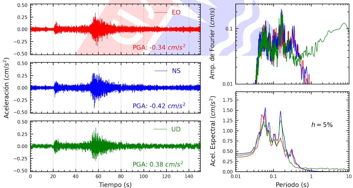
**Figura A.6:** Registros tiempo-historia, espectros de Fourier y de respuesta en las direcciones EO, NS y vertical de la estación SCARQ. Sismo de Calana, Tacna - Tacna del 2025-08-15, 15:29:15 (Hora local)
