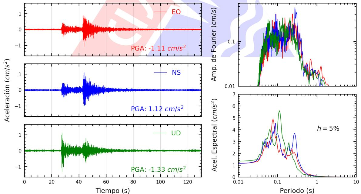
**Figura A.4:** Registros tiempo-historia, espectros de Fourier y de respuesta en las direcciones EO, NS y vertical de la estación UJBG2. Sismo de Calana, Tacna - Tacna del 2025-08-15, 15:29:15 (Hora local)
