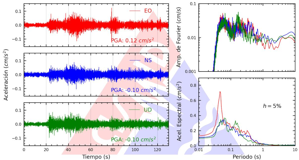
**Figura A.3:** Registros tiempo-historia, espectros de Fourier y de respuesta en las direcciones EO, NS y vertical de la estación CREY. Sismo de Ilo, Ilo - Moquegua del 2025-08-19, 18:14:48 (Hora local)
