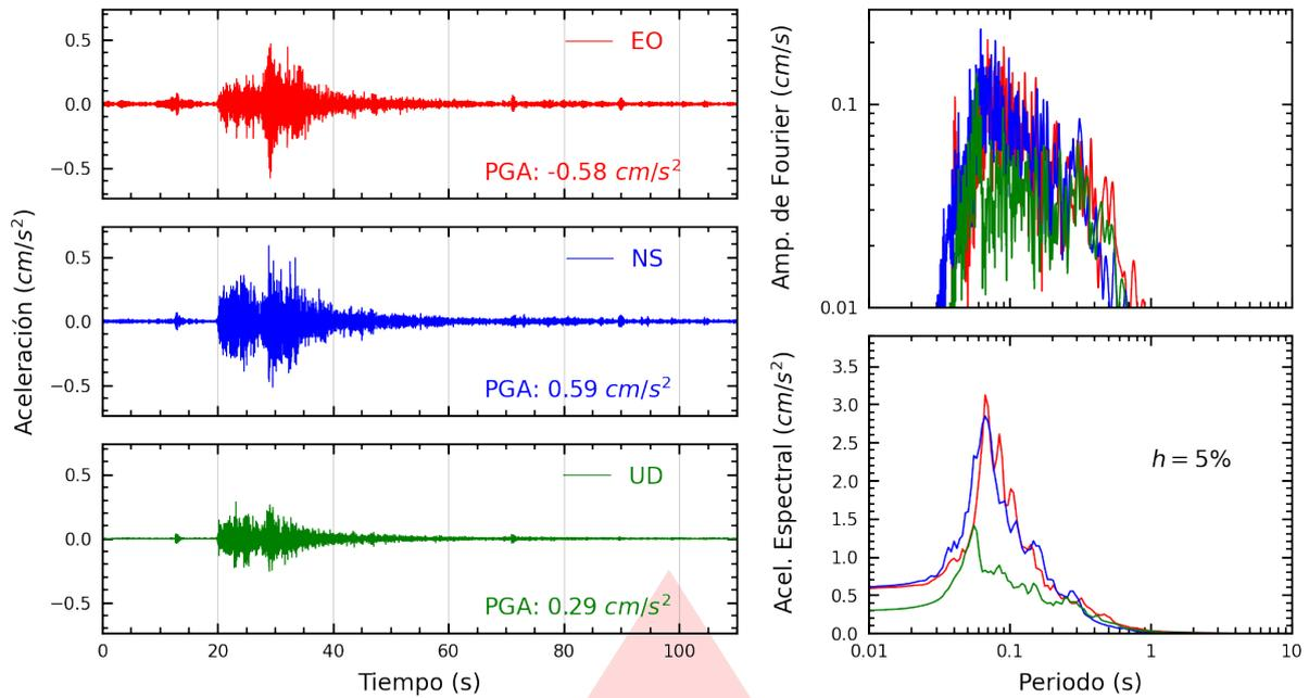
**Figura A.1:** Registros tiempo-historia, espectros de Fourier y de respuesta en las direcciones EO, NS y vertical de la estación UNAM. Sismo de Ilo, Ilo - Moquegua del 2025-08-19, 18:14:48 (Hora local)
