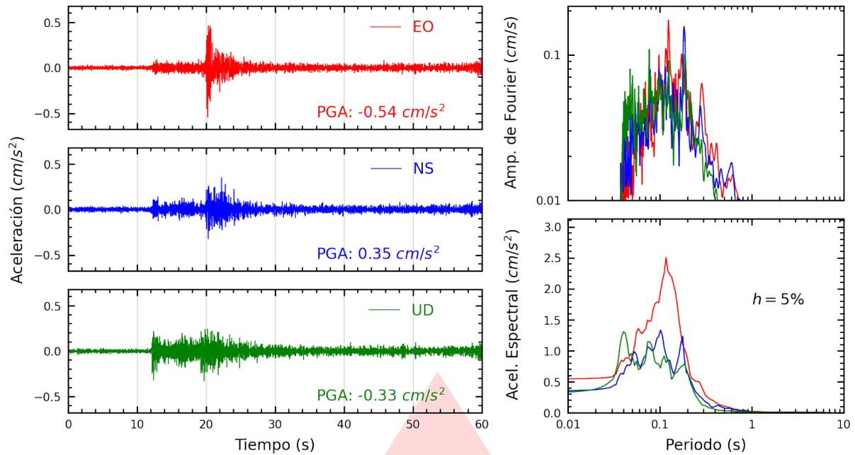
**Figura A.1:** Registros tiempo-historia, espectros de Fourier y de respuesta en las direcciones EO, NS y vertical de la estación UNICA. Sismo de Ica, Ica - Ica del 2025-08-23, 06:34:40 (Hora local)
