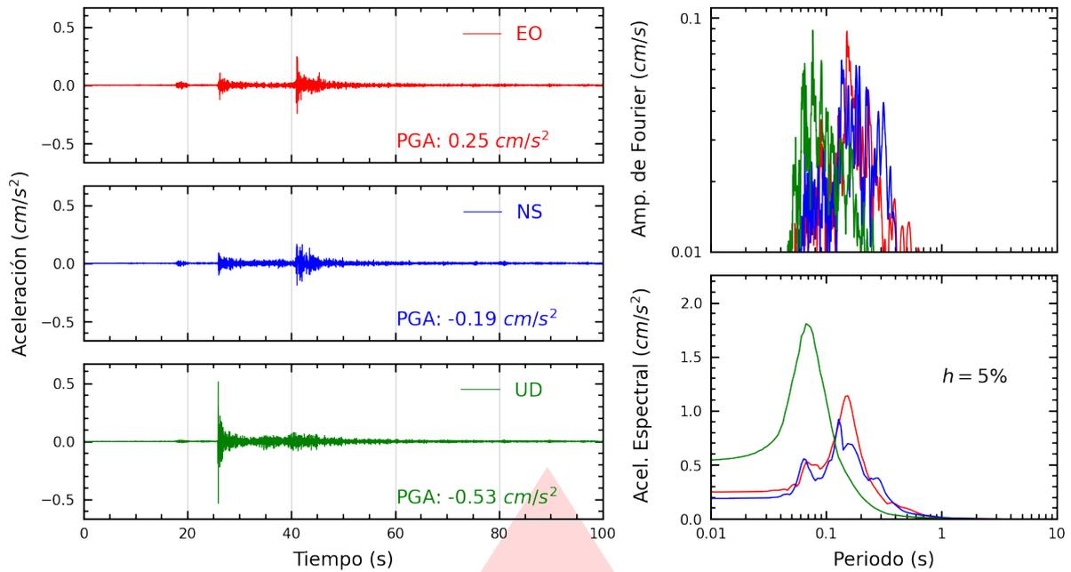
**Figura A.1:** Registros tiempo-historia, espectros de Fourier y de respuesta en las direcciones EO, NS y vertical de la estación UNAAA. Sismo de Tarapoto, San Martín - San Martín del 2025-08-29, 02:56:22 (Hora local)
