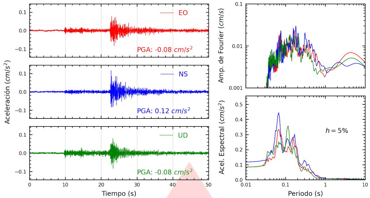
**Figura A.1:** Registros tiempo-historia, espectros de Fourier y de respuesta en las direcciones EO, NS y vertical de la estación CARAL. Sismo de Oyon, Oyon - Lima del 2025-09-09, 13:27:49 (Hora local)
